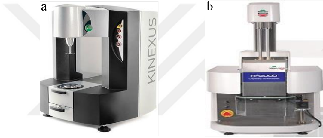
Şekil 6.4. Reolojik analiz için kullanılan genel cihaz tipleri a) Rotasyonel reometre b) Kılcal reometre
