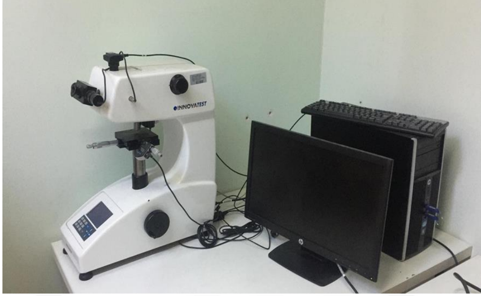
Şekil 8.5. Mikrosertlik ölçüm cihazı ve görüntü analiz ekipmanı
