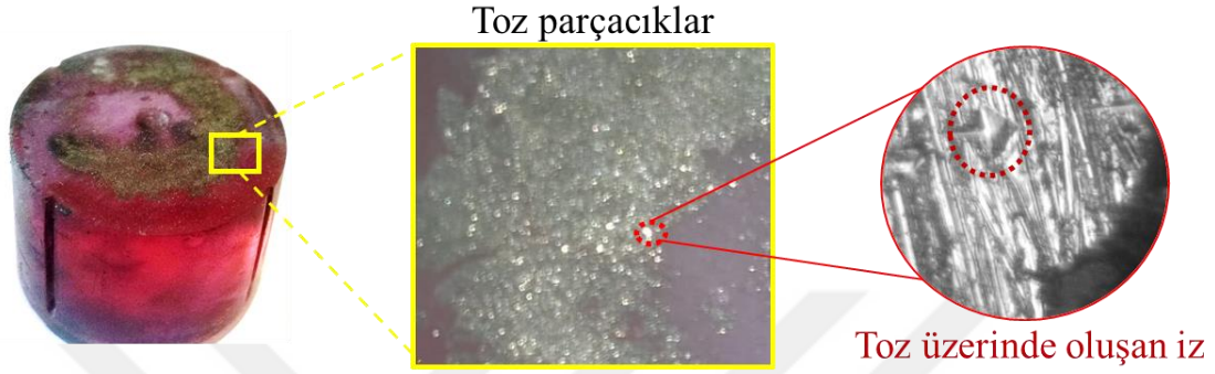
Şekil 9.45. Mikrosertlik numune örneği ve ölçüm sonrası oluşan iz
