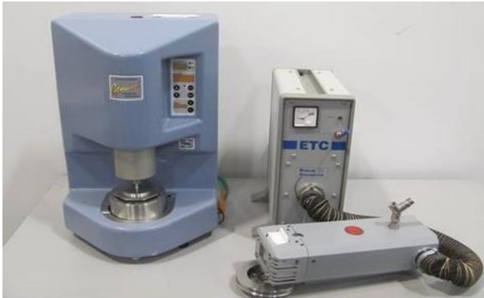
Şekil 8.9. Malvern-Bohlin Gemini II rotasyonel reometre ve genişletilmiş sıcaklık kontrol ünitesi (ETC)
