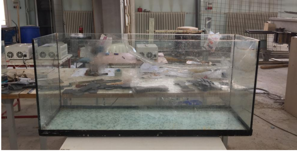
Şekil 4.13. Korozyon işleminin gerçekleştiği cam havuz
