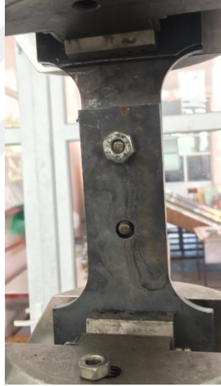
Şekil 5.99. Bulon bağlantısında somunların sıyrılmış hali
