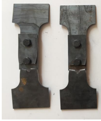
Şekil 5.48. Deney sonrası 4 mm kalınlığındaki bulonlu birleşimli levhalarda sadece bulonlarda yapay korozyon olan numuneler
