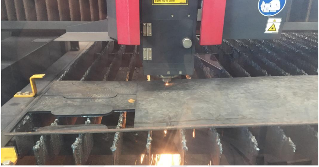
Şekil 4.1. Numunelerin lazer kesim işlemi ile hazırlanması
