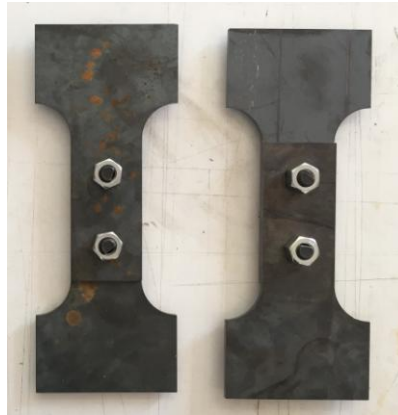
Şekil 5.47. Deney öncesi 4 mm kalınlığındaki bulonlu birleşimli levhalarda sadece bulonlarda yapay korozyon olan numuneler
