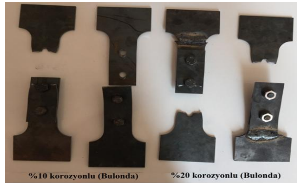
Şekil 5.38. Deney sonrası 4 mm kalınlıėında bulonlu birleřimli levhalarda sadece bulonda korozyon olan numuneler
