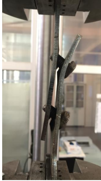
Şekil 5.46. Bulon bağlantısında somunların sıyrılması
