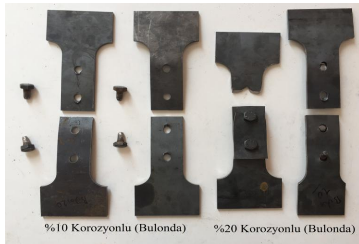
Şekil 5.91. Deney sonrası 6 mm kalınlıėında bulonlu birleřimli levhalarda sadece bulonda korozyon olan numuneler
