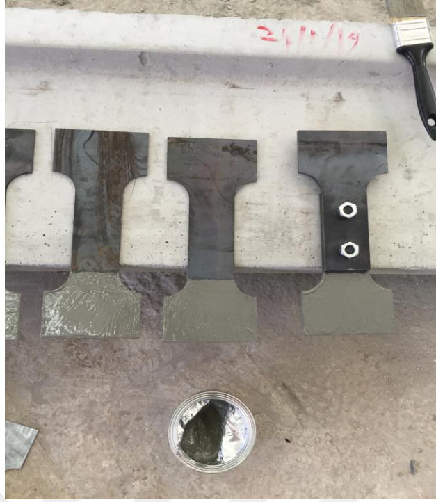
Şekil 4.12. Korozyona uğratılmayacak kısımların kaplama işlemi
