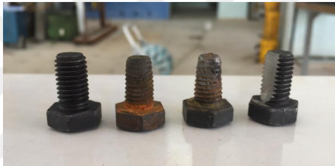
Şekil 4.19. Bulonların yapay ve hızlandırılmış korozyona uğratılmış halleri
