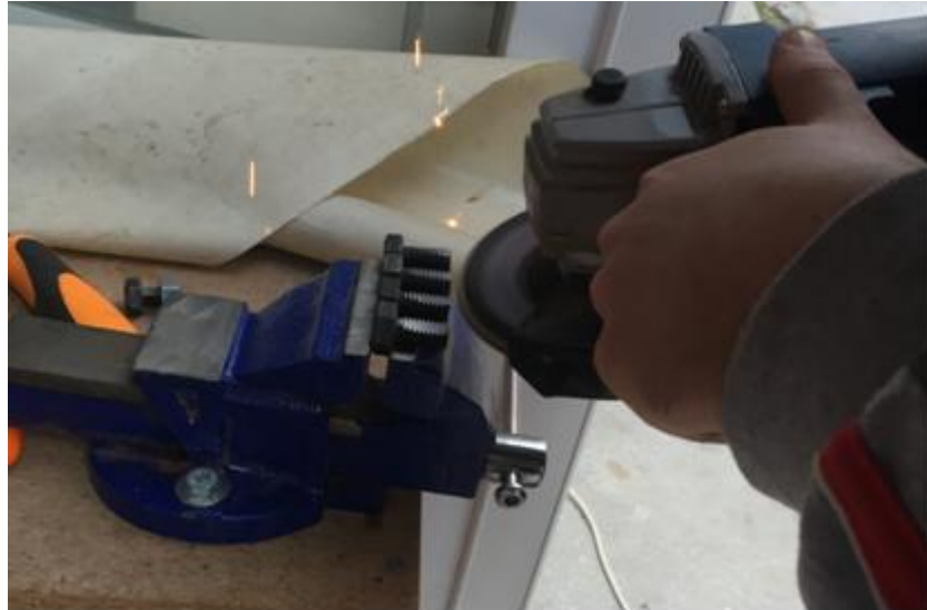
Şekil 4.18. Bulonlarda yapay korozyona uğratma işlemi
