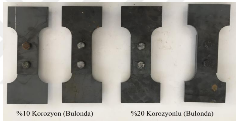
Şekil 5.90. Deney öncesi 6 mm kalınlıėında bulonlu birleřimli levhalarda sadece bulonda korozyon olan numuneler
