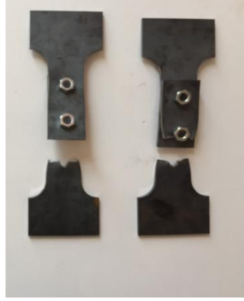
Şekil 5.102. Deney sonrası 6 mm kalınlığındaki bulon birleşimli levhalarda sadece bulonlarda yapay korozyon olan numuneler
