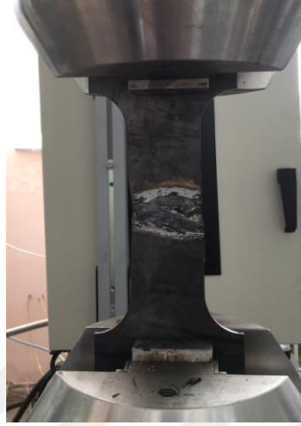
Şekil 5.19. 4 mm kalınlığında ve küt kaynaklı numunenin kaynaktan kırılma anı
