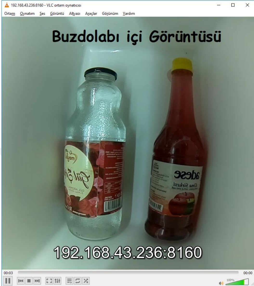
Şekil 3.28. Terminal üzerinden canlı yayınlanan Pi Kameranın VLC Player üzerinden görüntülenmesi
