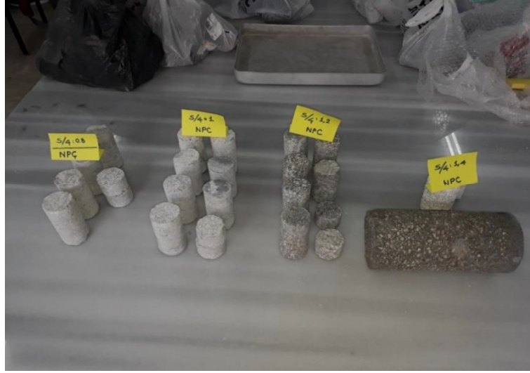
Şekil 4.10. CEM-I 42,5R JG kolonlarından alınan karot numuneleri (1. Grup)
