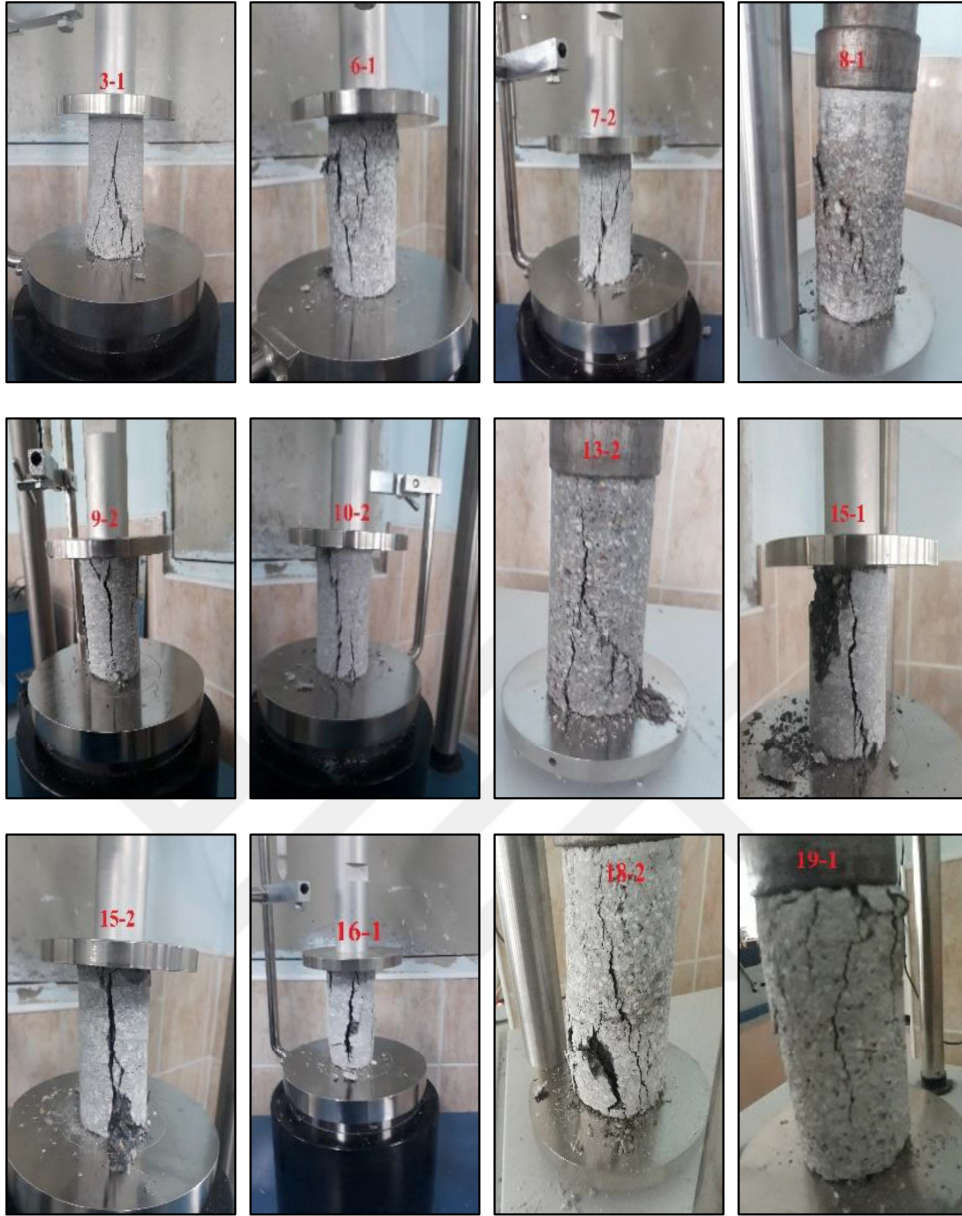
Şekil 4.15. Serbest basınç deneyinin yapılması esnasında karot numunelerin kırılmalarına ait resimler
