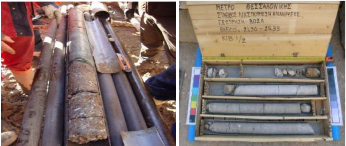
Şekil 3.20. İyileştirme yapılan zeminden alınan sondaj numuneleri (Kimpritis,2013)
