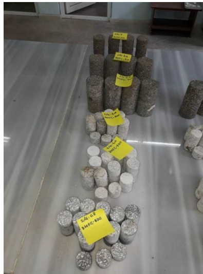
Şekil 4.12. DMFC-800 JG kolonlarından alınan karot numuneleri (3. Grup)
