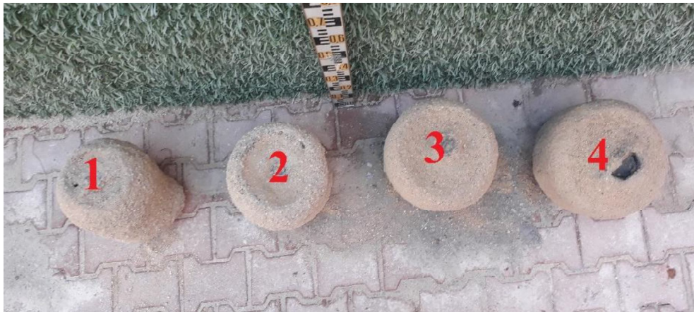
Şekil 4.3. CEM-I 42,5R çimentosu ile oluşturulan kolonların görünüşleri
