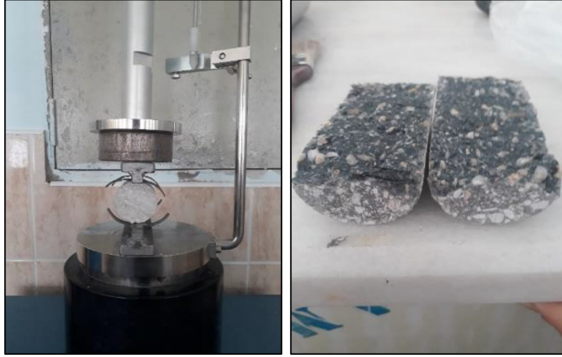
Şekil 3.36. Jet Grout kolonlarında yarmada çekme deneyi
