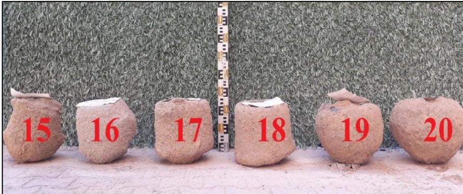
Şekil 4.6. DMFC-800 çimento şerbeti kullanılarak oluşturulan JG kolonları
