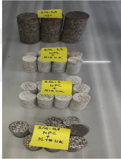
Şekil 4.11. CEM-I 42,5R+ %15 UK JG kolonlarından alınan karot numuneleri (2. Grup)
