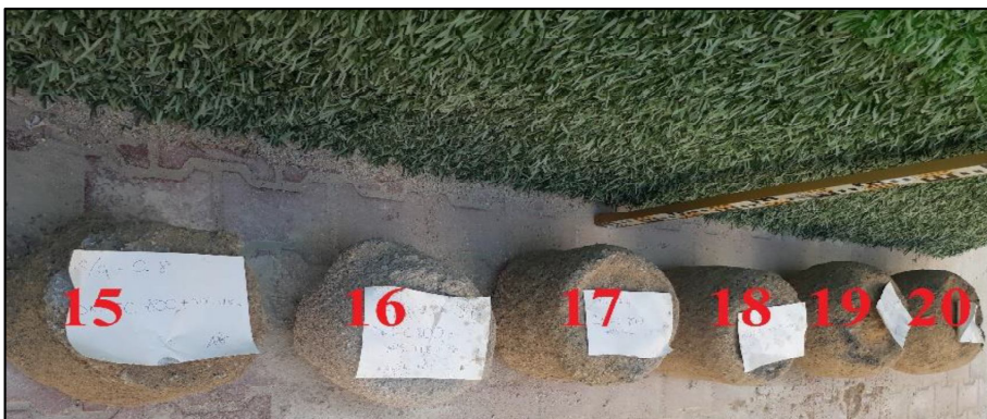
Şekil 4.7. DMFC-800 + %15 UK karışımli çimento şerbeti kullanılarak oluşturulan JG kolonları
