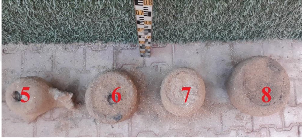
Şekil 4.4. CEM-I 42,5R + %15 UK karışımı ile oluşturulan kolonların görünüşleri
