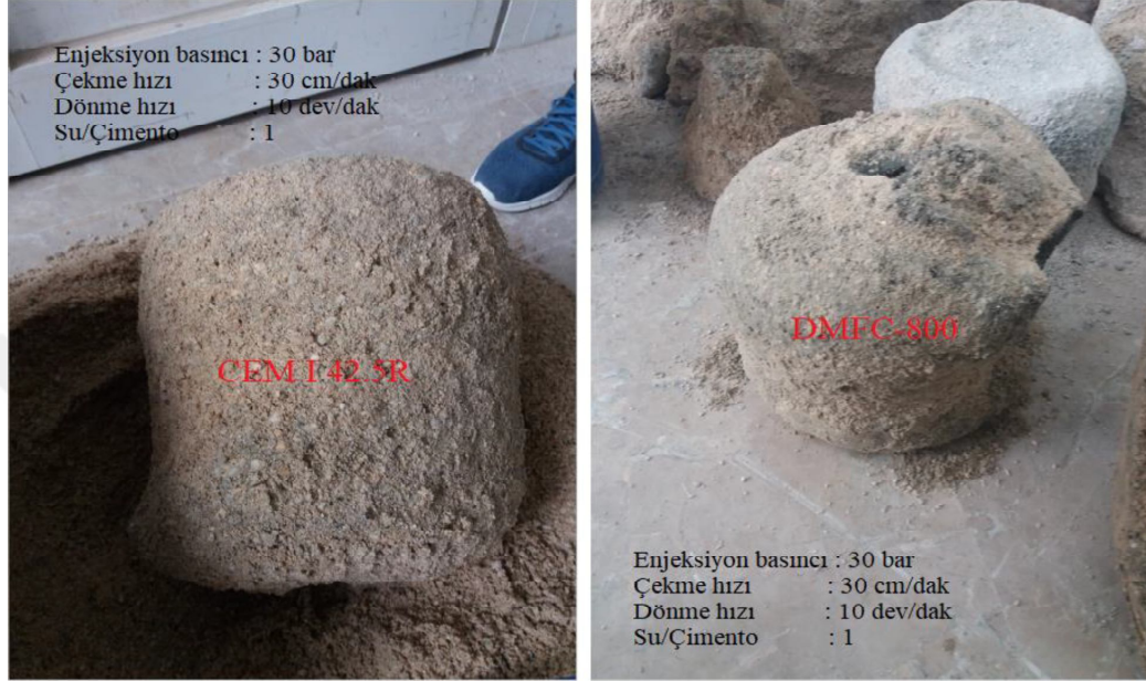
Şekil 3.33 Farklı tip çimento kullanılarak oluşturulan JG deneme kolonları
