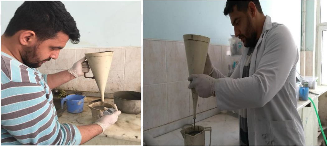
Şekil 3.25. Marsh hunisi deneyinin yapılışı
