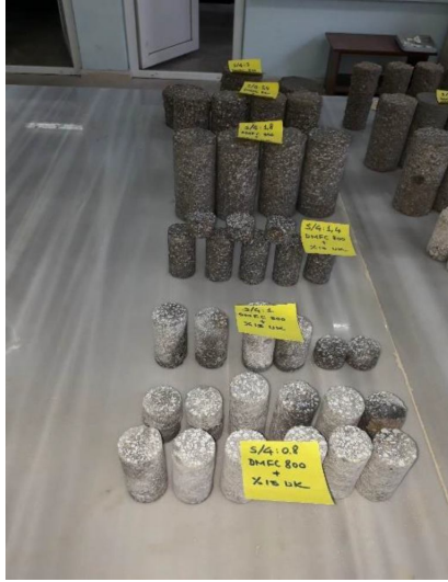
Şekil 4.13. DMFC-800+ %15 UK JG kolonlarından alınan karot numuneleri (4. Grup)
