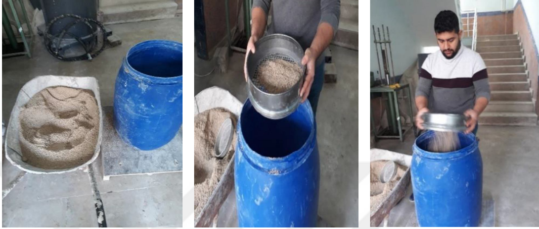
Şekil 3.29 Kumun plastik varile yerleştirilmesi
