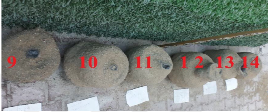
Şekil 4.6. DMFC-800 çimento şerbeti kullanılarak oluşturulan JG kolonları
