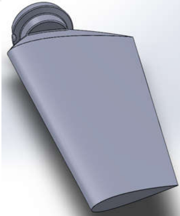
Şekil 3.17. NACA2415 türbin kanadı 3D katı modelleme
