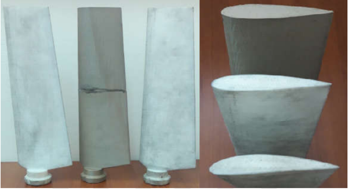
Şekil 3.20. Üç boyutlu yazıcı ile yapılan türbin kanat modelleri
