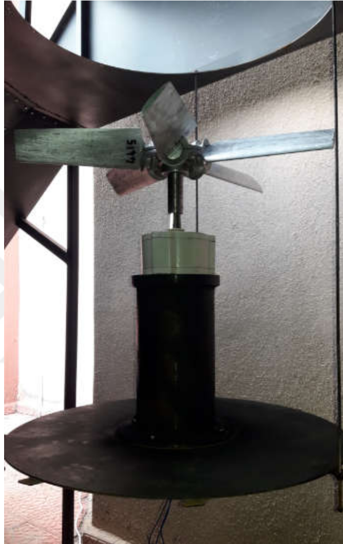
Şekil 3.26. Güneş Bacası Sistemi için imal edilen rüzgar türbini
