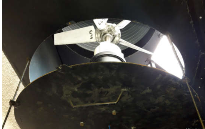
Şekil 3.27. Türbin güneş bacası girişine kaldırma-indirme mekanizması ile yerleştirilir.
