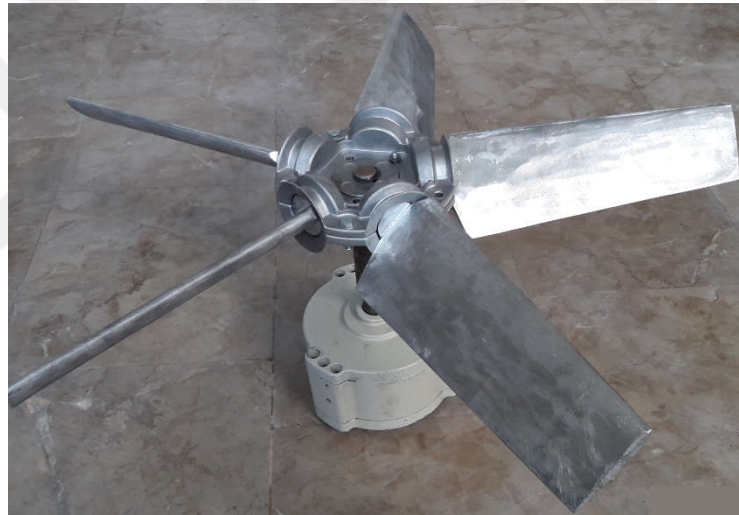
Şekil 3.23. Türbin kanatlarının rotora montajlanmış hali
