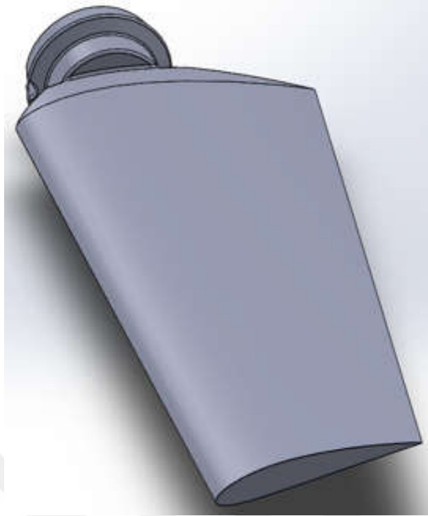
Şekil 3.18. NACA4415 türbin kanadı 3D katı modelleme
