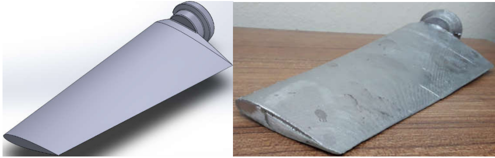
Şekil 3.21. Türbin kanatlarının 3D katı modelleme programında çizilmiş ve ürün hali
