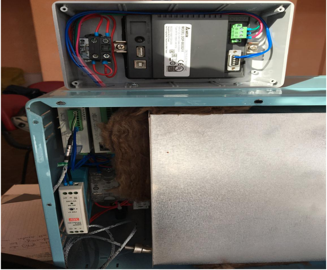
Şekil 3.14. PT1000 sıcaklık sensörünün sıcaklık kontrol modülüyle bağlantısı
