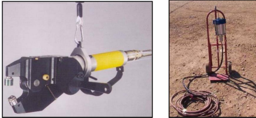
Şekil 1.15. Hidrolik veya hava kompresi ile çalışan punto aleti (HUD, 2003)
