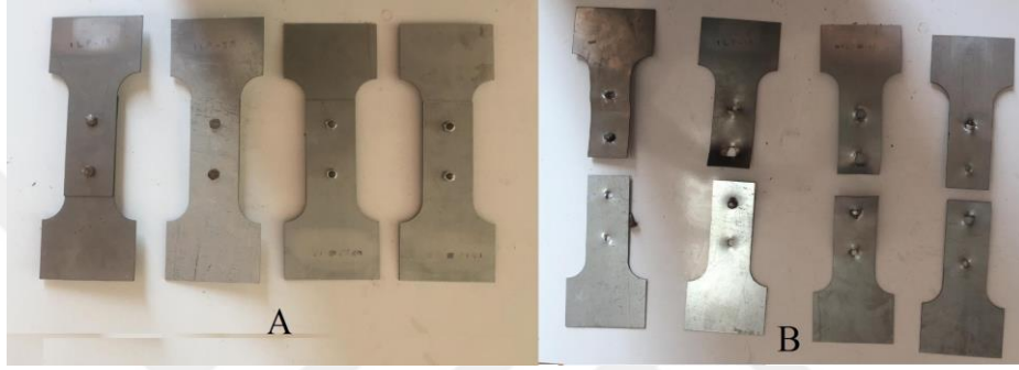
Şekil 4.33. Sadece bulonları korozyona uğramış, 1 mm kalınlıklı levhaların aksenal çekme deneyinden önceki (A) ve sonraki (B) durumları
