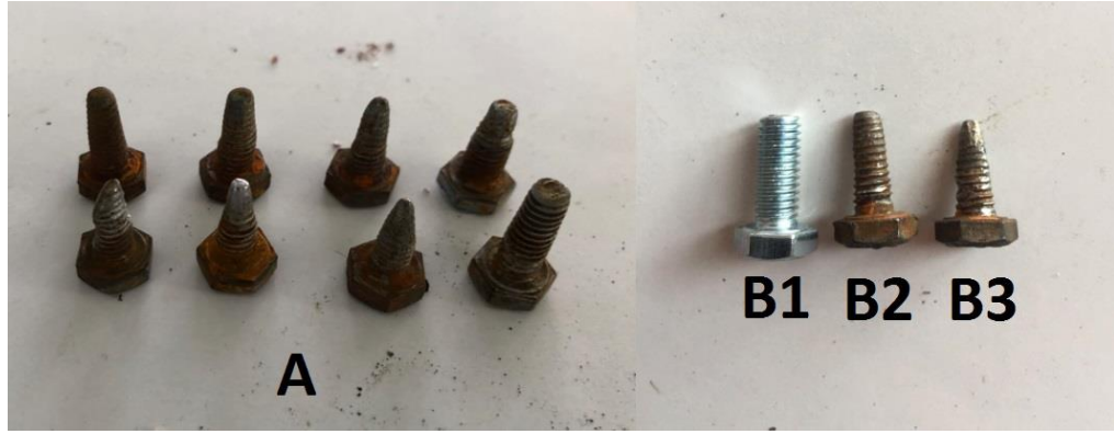
Şekil 4.28. Korozyona uğramamış bulon (B1), %10 korozyona uğramış bulon (B2), %20 korozyona uğramış bulon (B3) ve korozyona uğrayan bulonların tümü (A)
