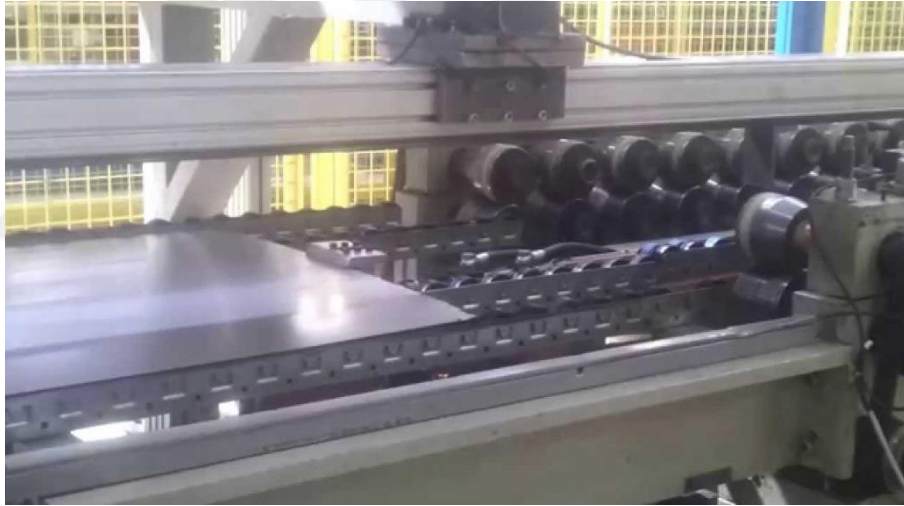
Şekil 1.6. Üretim bandında silindir presler ile soğuk şekillendirme
