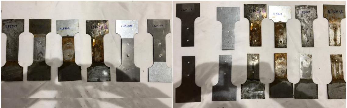
Şekil 4.26. 1 mm kalınlıklı, perçin birleşimli levhaların aksenal çekme deneyinden önceki (A) ve sonraki (B) durumları
