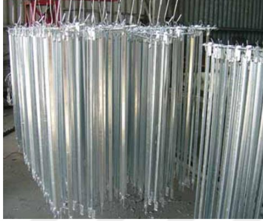
Şekil 1.37. Galvenizleme sonrası oluşan görüntü (Kaftan, 2006)
