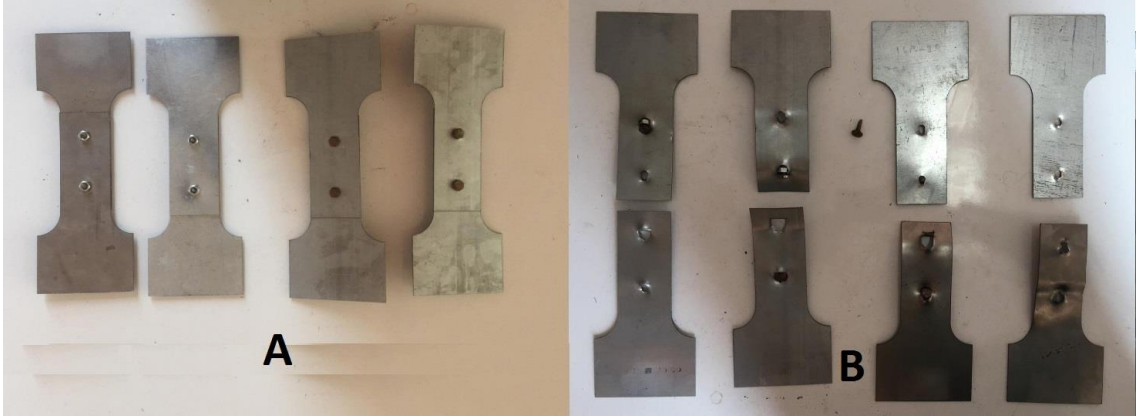
Şekil 4.30. Sadece bulonları korozyona uğramış, 0.8 mm kalınlıklı levhaların aksenal çekme deneyinden önceki (A) ve sonraki (B) durumları
