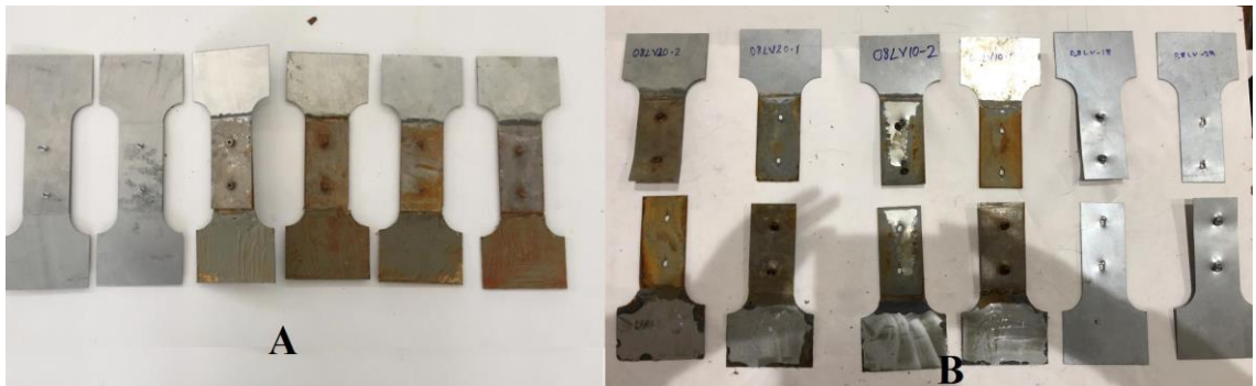
Şekil 4.17. 0.8 mm kalınlıklı, vida birleşimli levhaların aksenal çekme deneyinden önceki (A) ve sonraki (B) durumları
