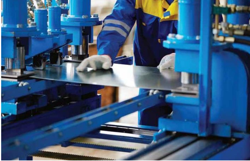
Şekil 1.5. Hafif Çelik levhannın bükülerek soğuk şekillendirilmesi (Anonim, 2019d)
