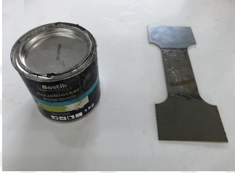
Şekil 3.3. Aquablocker su yalıtımı malzemesi ve alt başlığı aquablocker ile kaplanmış numune
