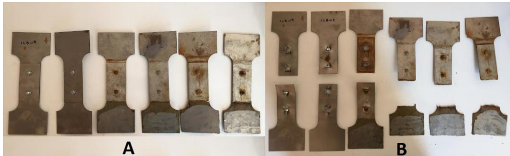
Şekil 4.14. 1 mm kalınlıklı, bulon birleşimli levhaların eksenel çekme deneyinden önceki (A) ve sonraki (B) durumları
