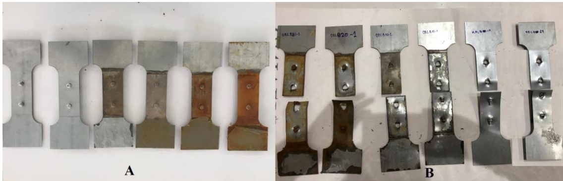
Şekil 4.11. 0.8 mm kalınlıklı, bulon birleşimli levhaların aksenal çekme deneyinden önceki (A) ve sonraki (B) durumları
