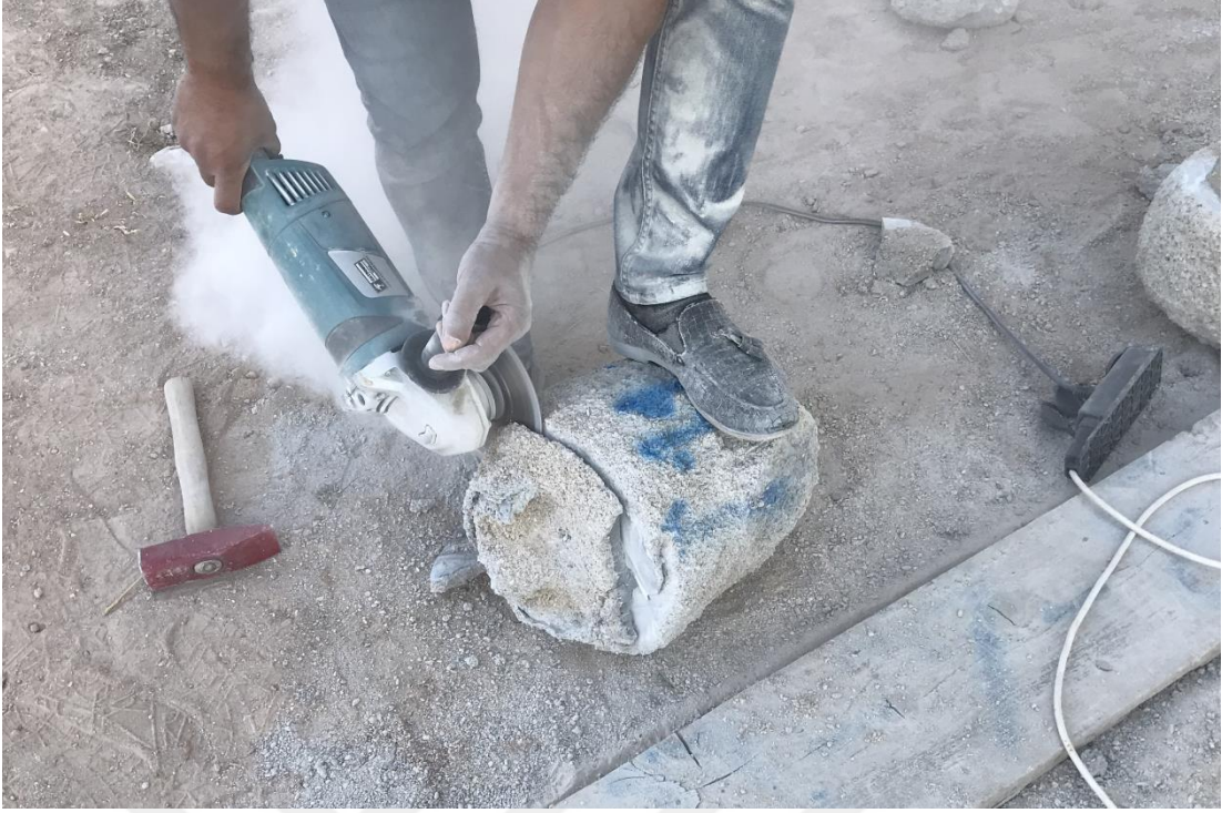
Şekil 4.27. Kolonların karot alma işlemi için hazırlanması
