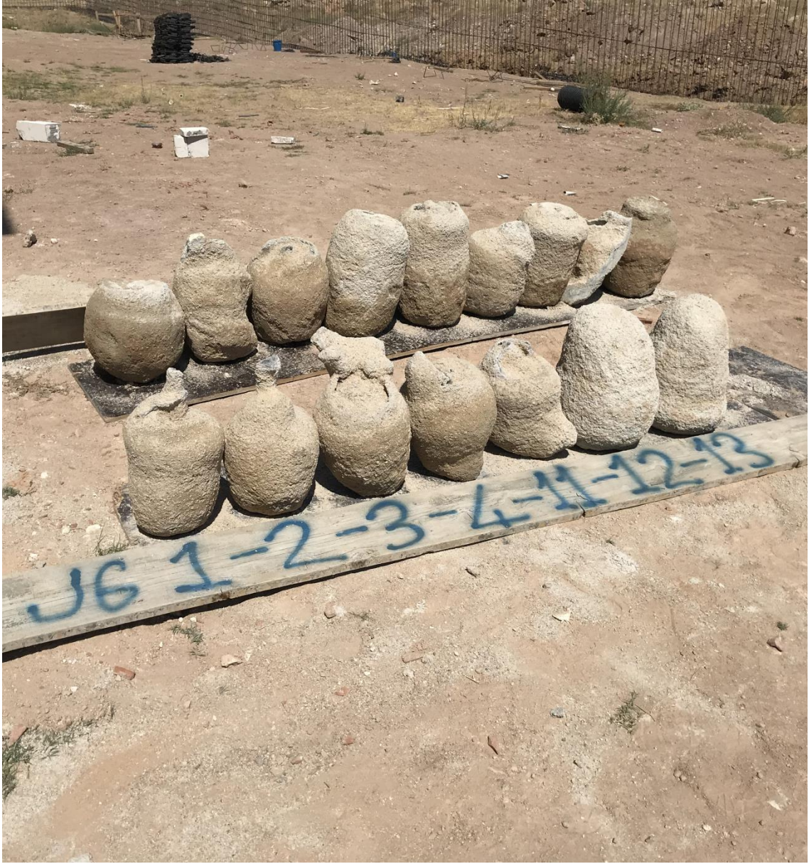
Şekil 4.4. Jet grout kolonlarının görünümü (1-2-3-4-11-12-13 nolu)
