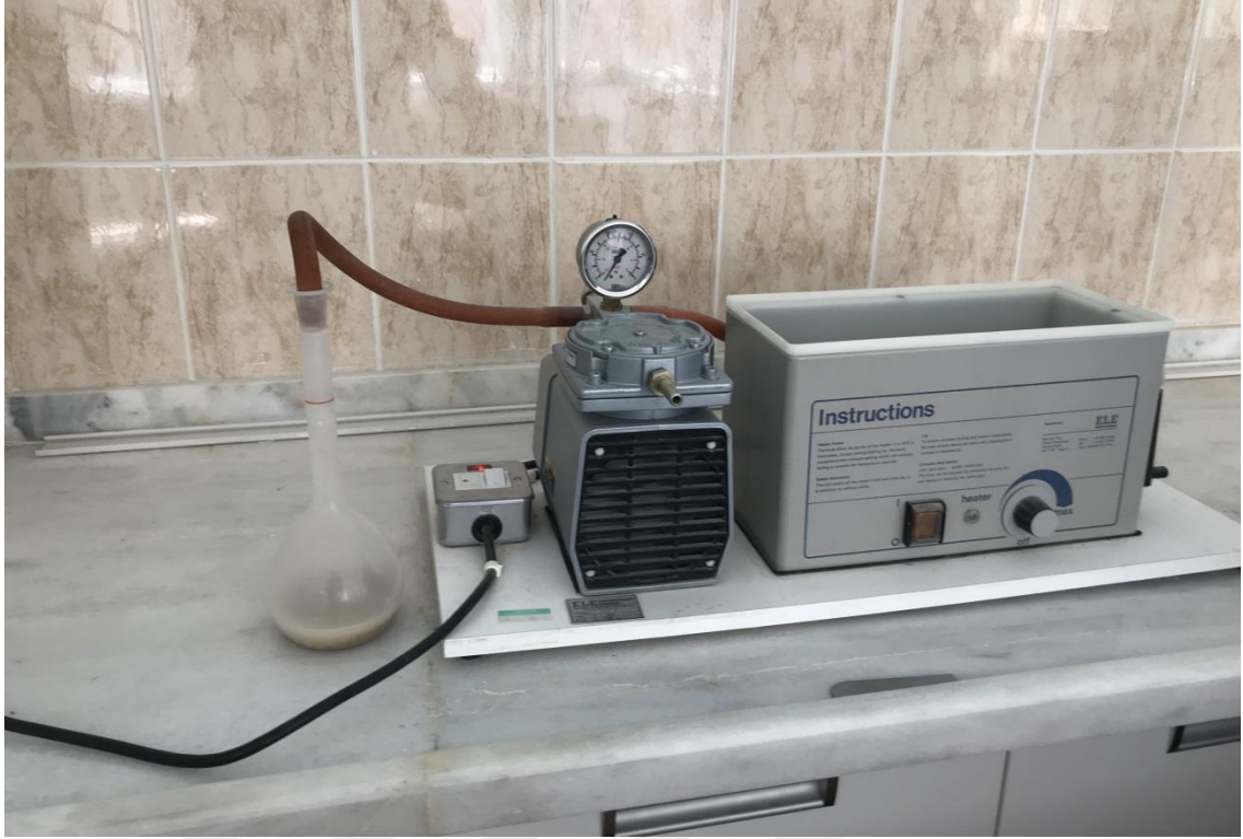
Şekil 3.5. Tane yoğunluğunun bulunması
