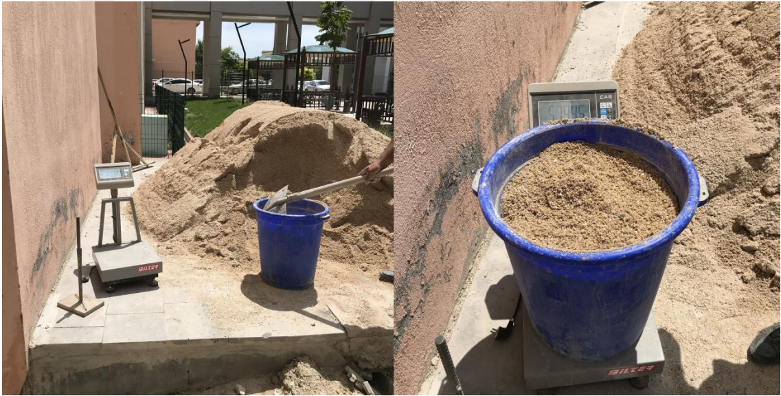
Şekil 3.13. Varile konulacak kum miktarının tartılması
