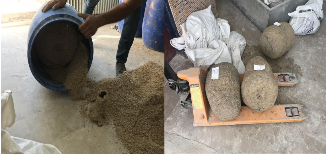
Şekil 4.2. Jet grout kolonların çıkarılması ve istiflenmesi
