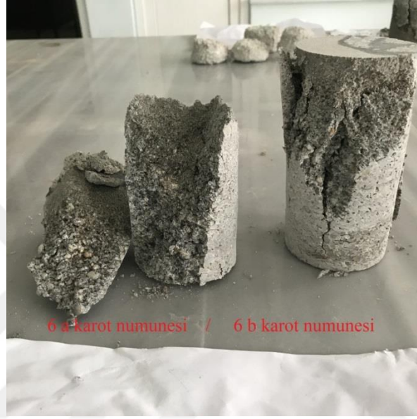
Şekil 4.59. 6 nolu kolon karotlarının standart basınç deneyi sonrası görünümü
