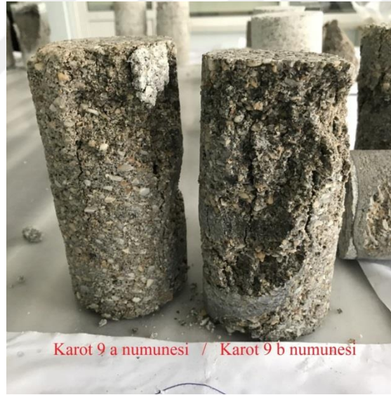
Şekil 4.76. 9 nolu kolon karotlarının standart basınç deneyi sonrası görünümü.
