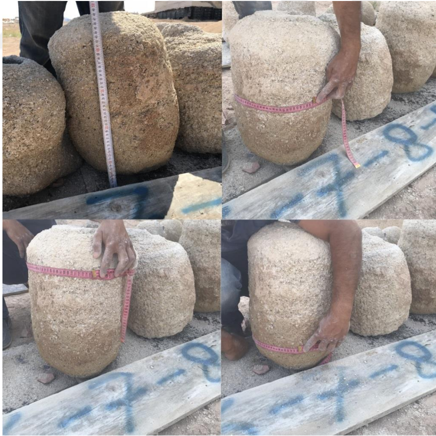
Şekil 4.15. Boyut analizi (7 numaralı kolon)
