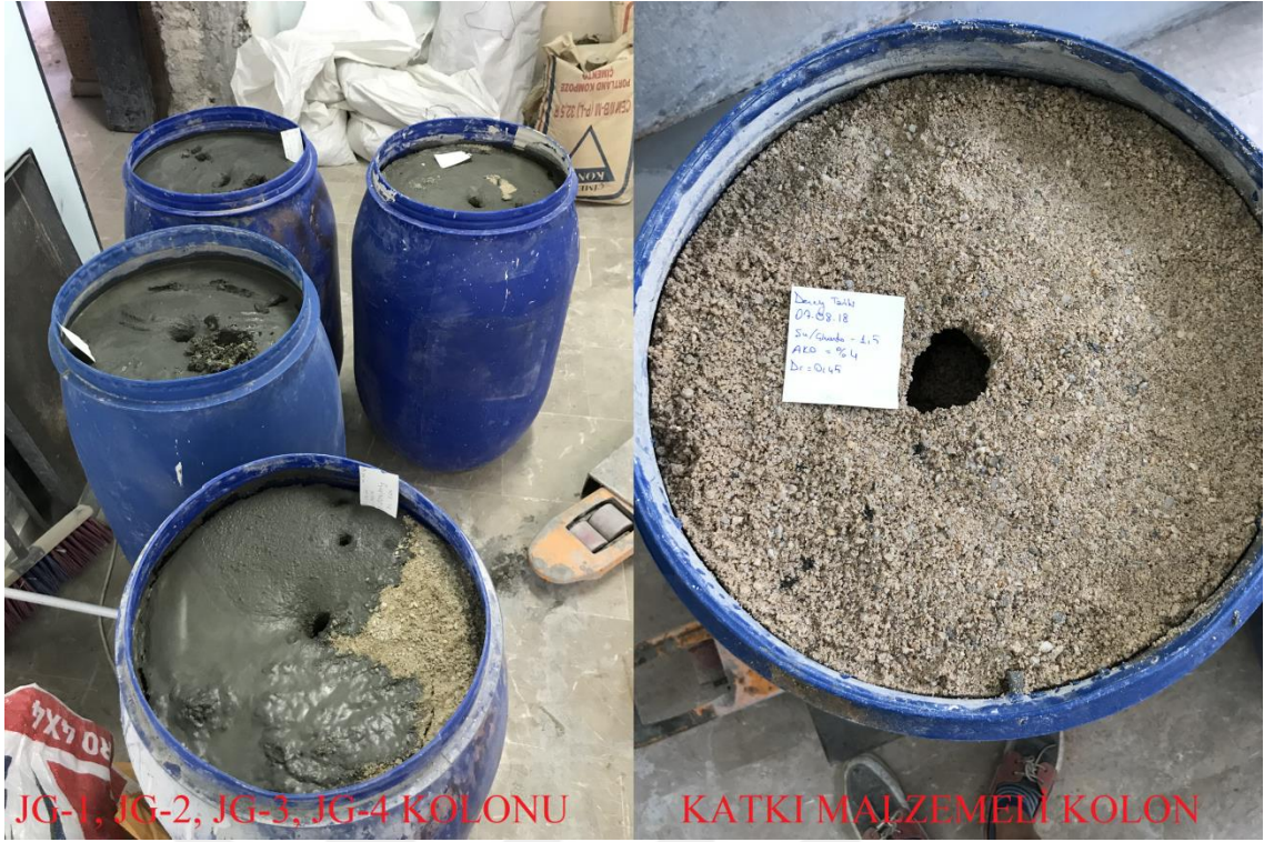
Şekil 5.1. Enjeksiyon işlemi sonucunda kum numunelerinin üstten görünümü.
