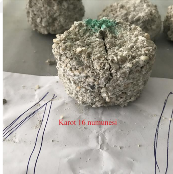
Şekil 4.109. 16 nolu kolon karotlarının standart basınç deneyi sonrası görünümü.
