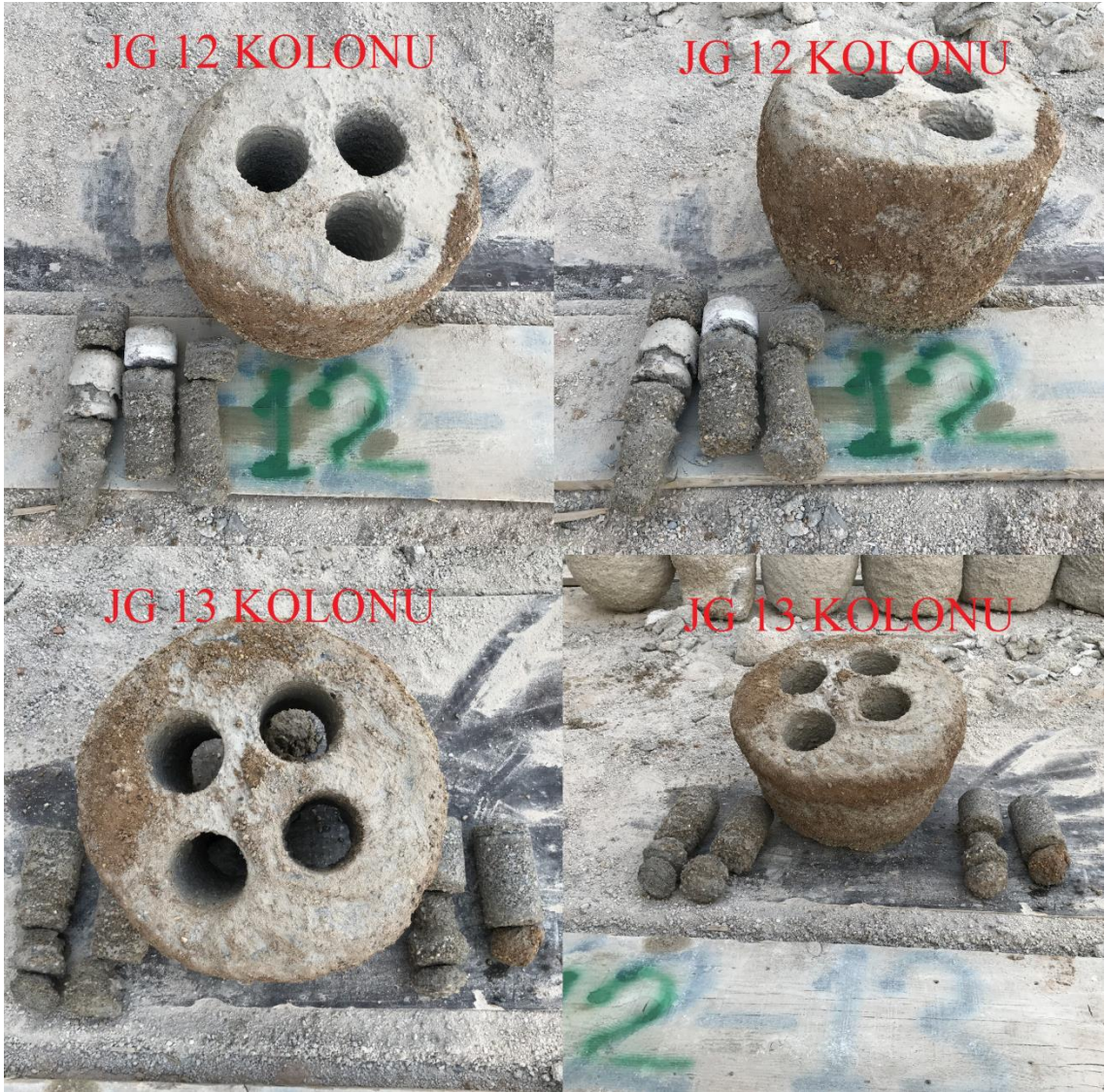
Şekil 4.36. 12 ve 13 nolu kolonlardan karot alınması
