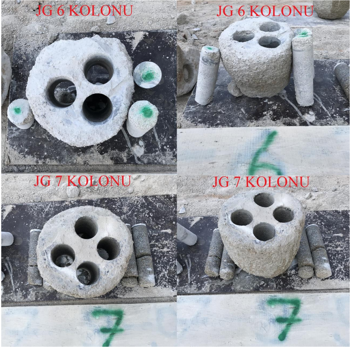
Şekil 4.33. 6 ve 7 nolu kolonlardan karot alınması
