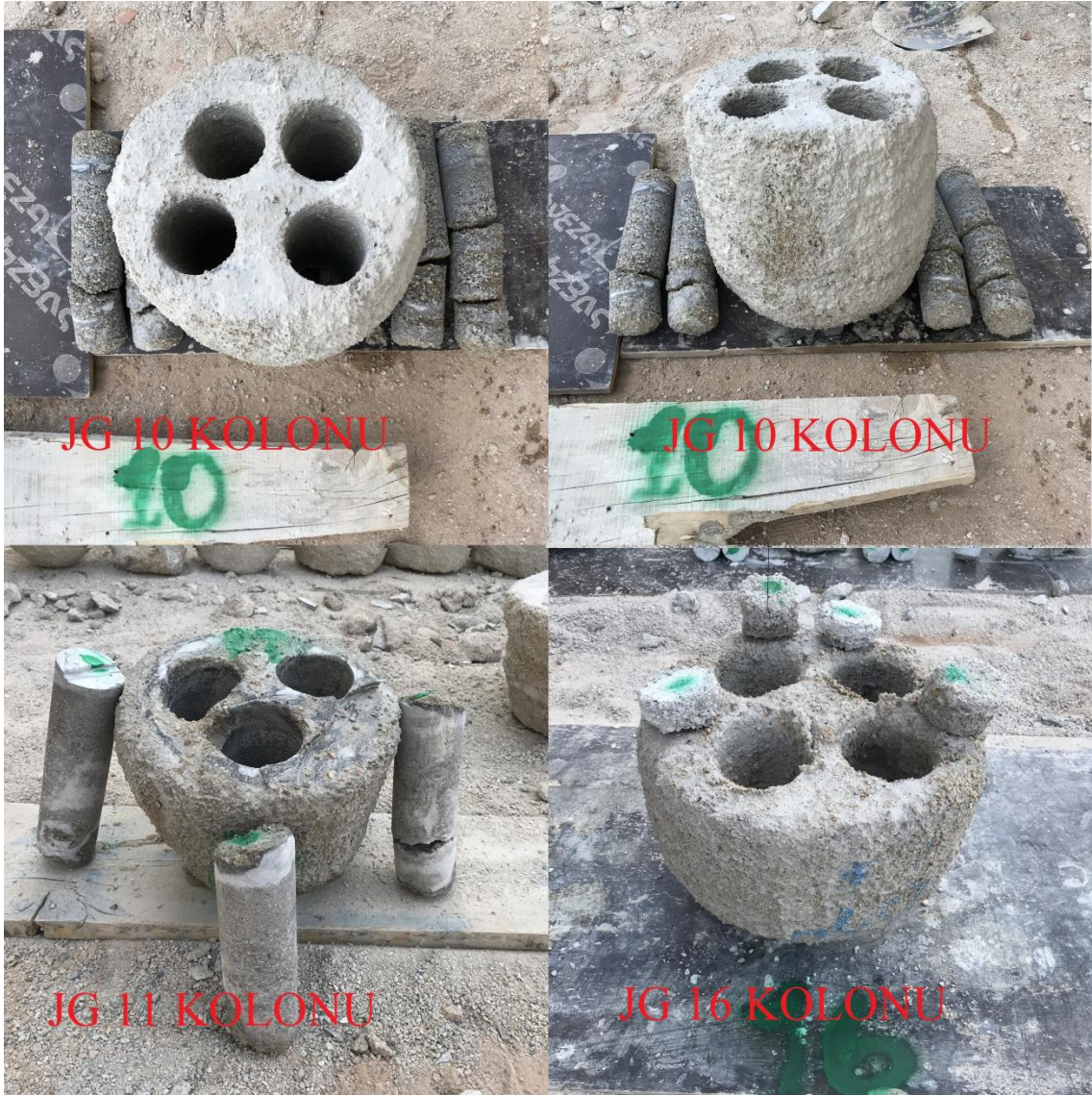
Şekil 4.35. 10-11 ve 16 nolu kolonlardan karot alınması
