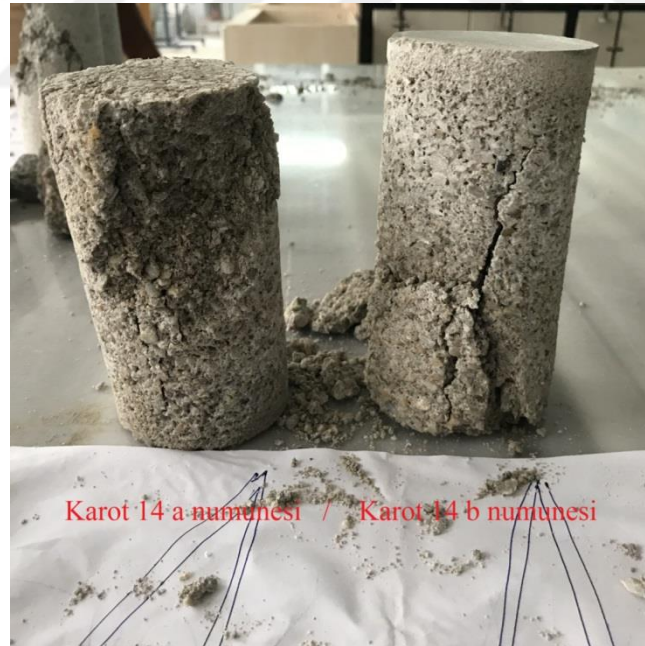
Şekil 4.99. 14 nolu kolon karotlarının standart basınç deneyi sonrası görünümü.
