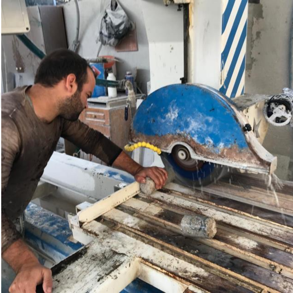
Şekil 4.38. Karot numunelerinin üst ve alt yüzeyinin düzlenmesi
