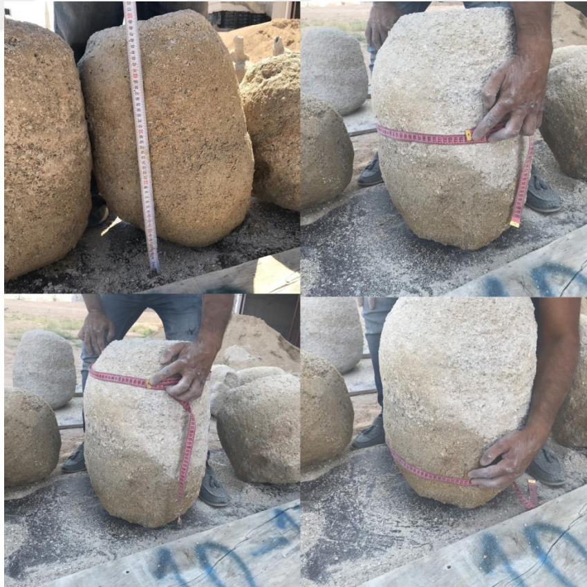
Şekil 4.18. Boyut analizi (10 numaralı kolon)
