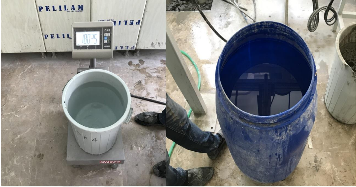
Şekil 3.12. Varilin belirlenen yüksekliğe kadar hacminin bulunması
