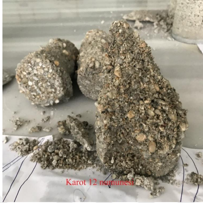
Şekil 4.91 12 nolu kolon karotunun standart basınç deneyi sonrası görünümü.
