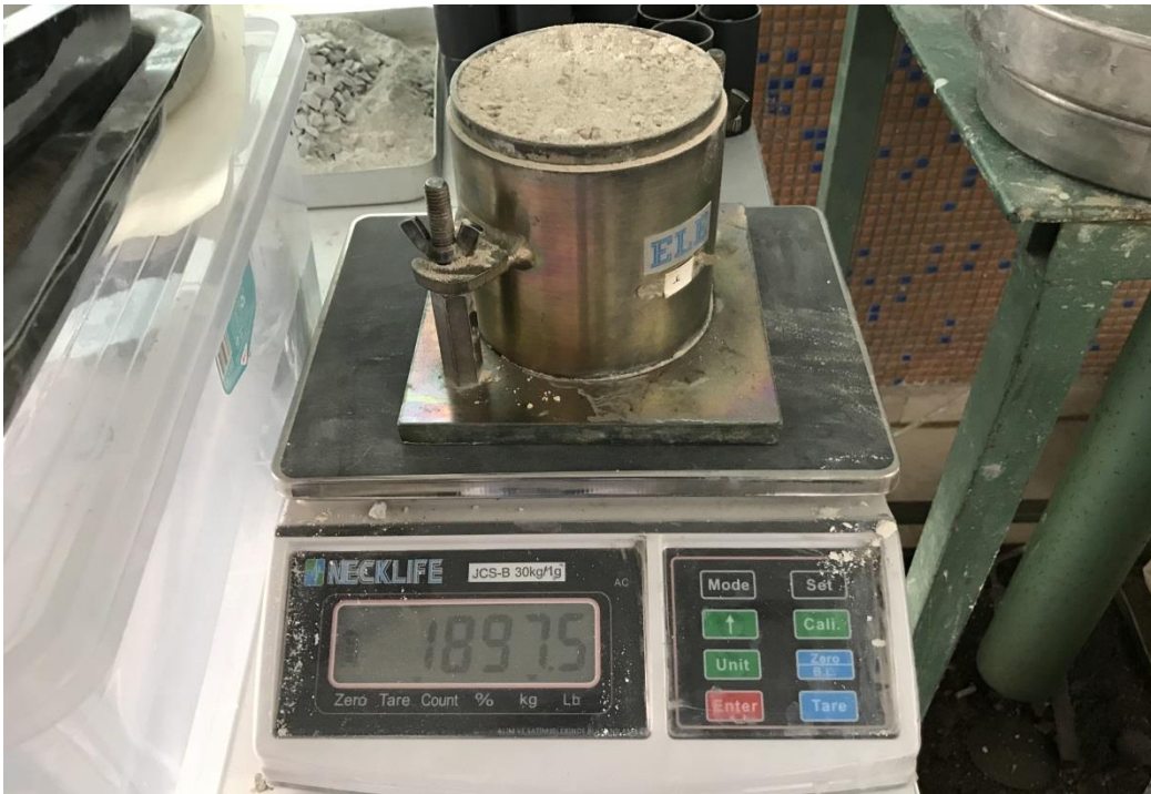
Şekil 3.6. Minimum boşluk oranının tayin edilmesi.
