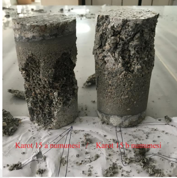
Şekil 4.104. 15 nolu kolon karotlarının standart basınç deneyi sonrası görünümü.
