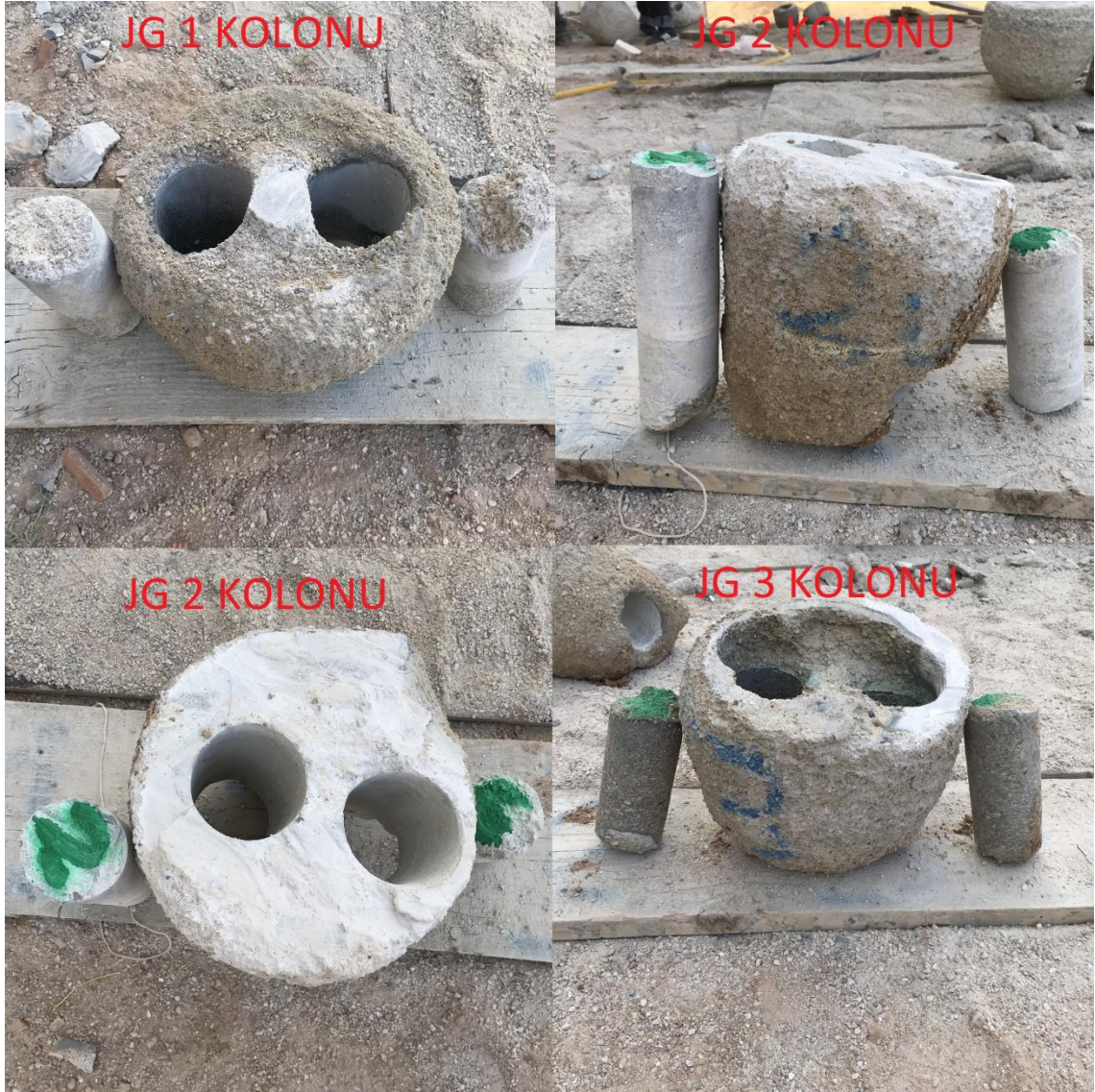
Şekil 4.31. 1-2 ve 3 nolu kolonlardan karot alınması
