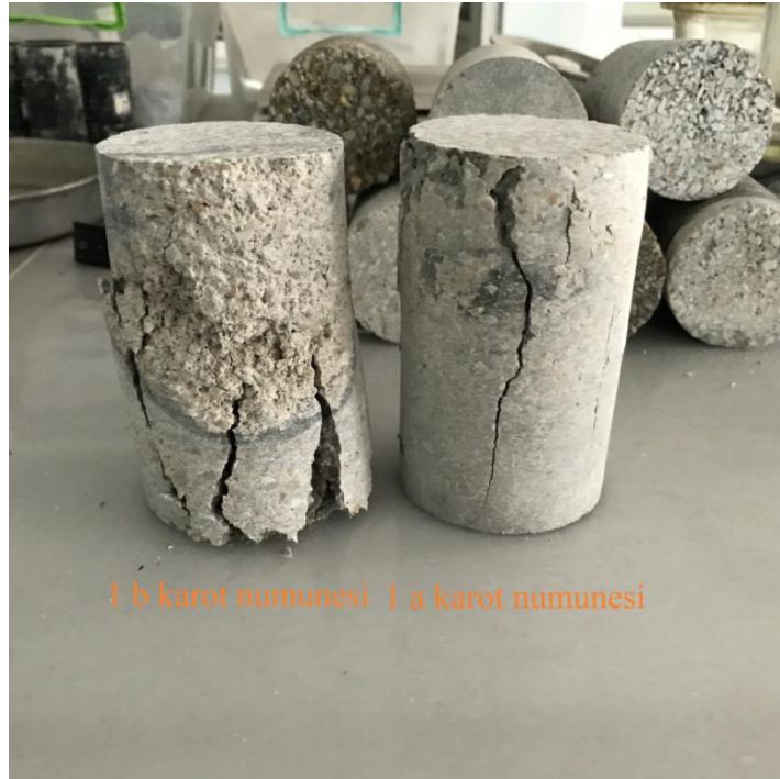
Şekil 4.41. 1 nolu kolon karotlarının standart basınç deneyi sonrası görünümü
