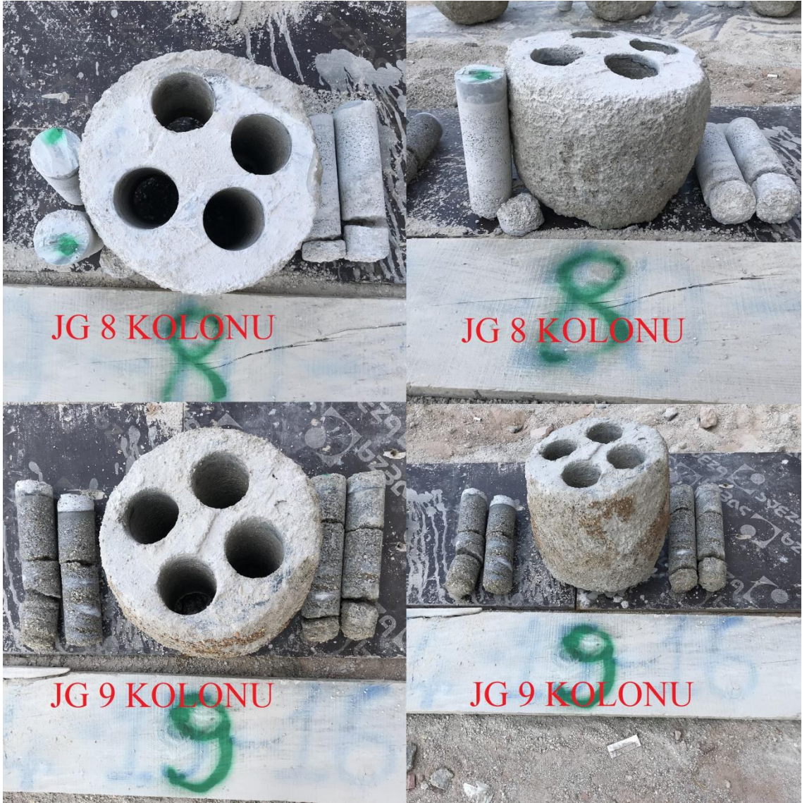
Şekil 4.34. 8ve 9 nolu kolonlardan karot alınması
