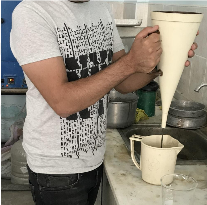
Şekil 3.7. Marsh hunisi deneyi yapılması
