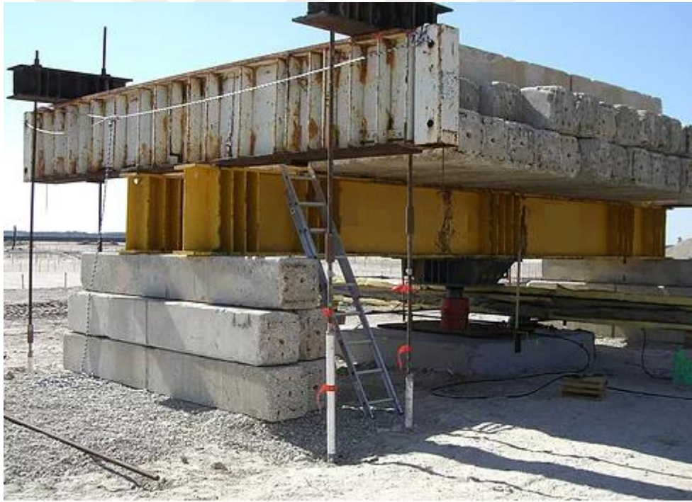
Şekil 2.30. Kazık yükleme deney düzeneği (zeminarastırma-ur1)
