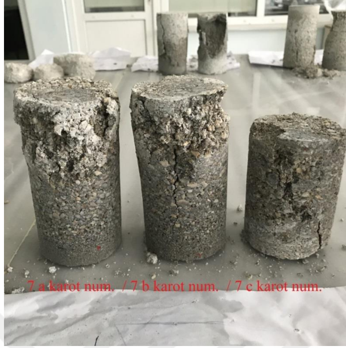
Şekil 4.64. 7 nolu kolon karotlarının standart basınç deneyi sonrası görünümü.
