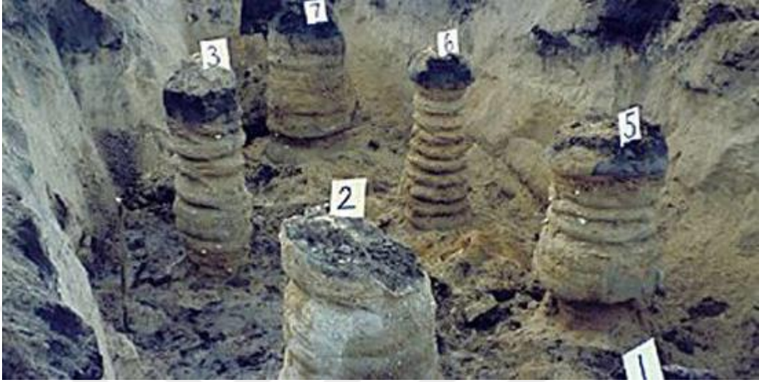
Şekil 2.27. Jet grout kolon kalite kontrolü (geozerezmin-ur1)
