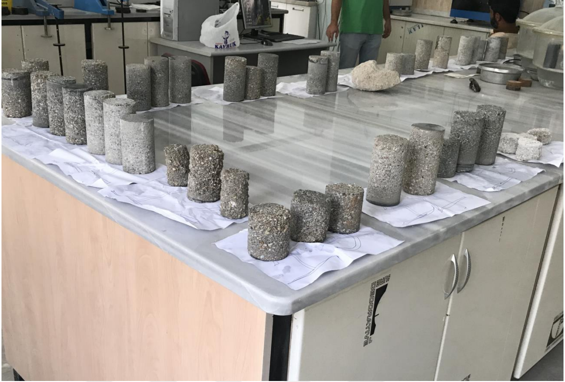
Şekil 4.39. Karot numunelerinin laboratuvarda kolon numaralarına göre sıralanması
