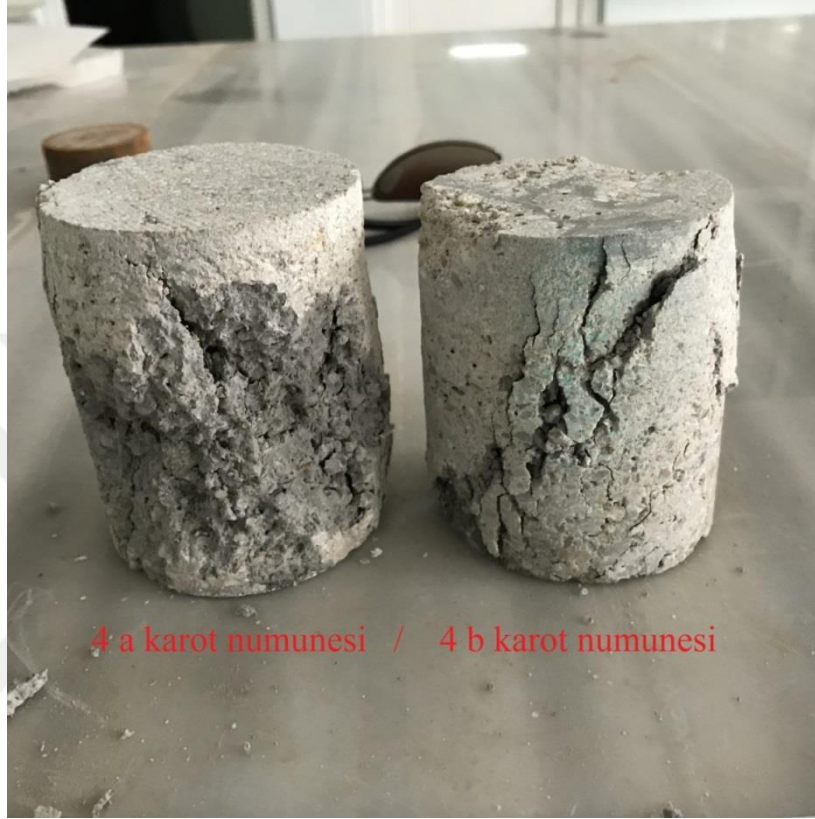
Şekil 4.54. 4 nolu kolon karotlarının standart basınç deneyi sonrası görünümü
