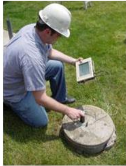
Şekil 2.32. Kazık süreklilik deney aletinin ve uygulamasının gösterimi (zeminteknolojileri-url)
