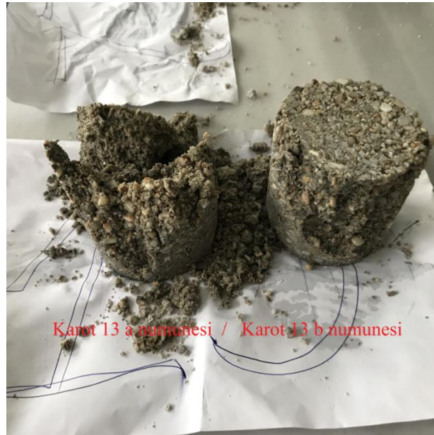
Şekil 4.94. 13 nolu kolon karotlarının standart basınç deneyi sonrası görünümü.
