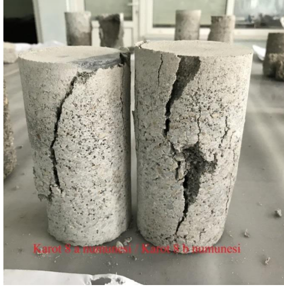
Şekil 4.71. 8 nolu kolon karotlarının standart basınç deneyi sonrası görünümü.
