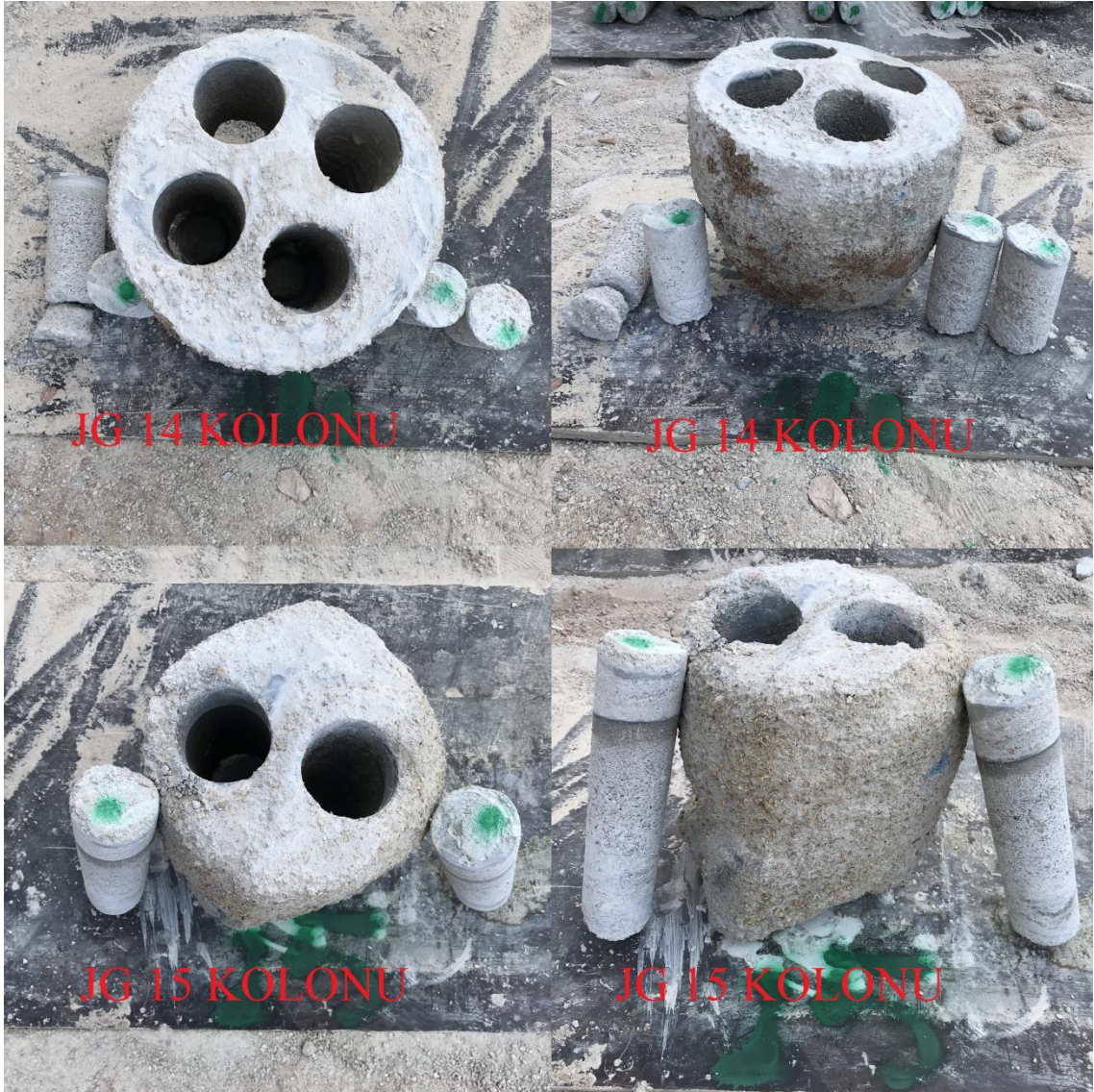
Şekil 4.37. 14 ve 15 nolu kolonlardan karot alınması
