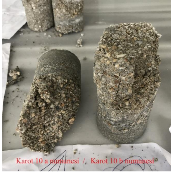
Şekil 4.81. 10 nolu kolon karotlarının standart basınç deneyi sonrası görünümü.
