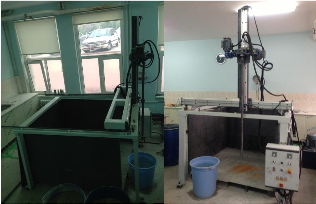
Şekil 3.8. Enjeksiyon Makinası Deney Düzeneği
