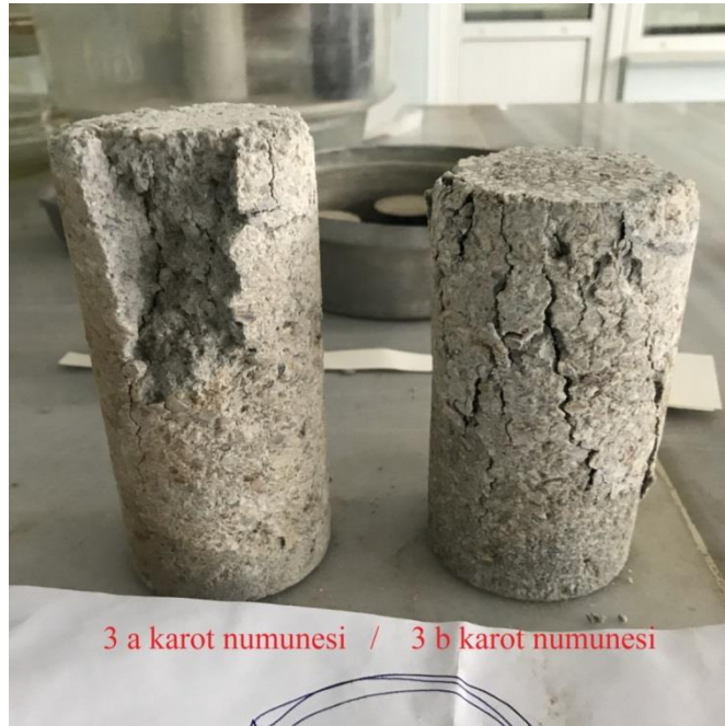
Şekil 4.51. 3 nolu kolon karotlarının standart basınç deneyi sonrası görünümü
