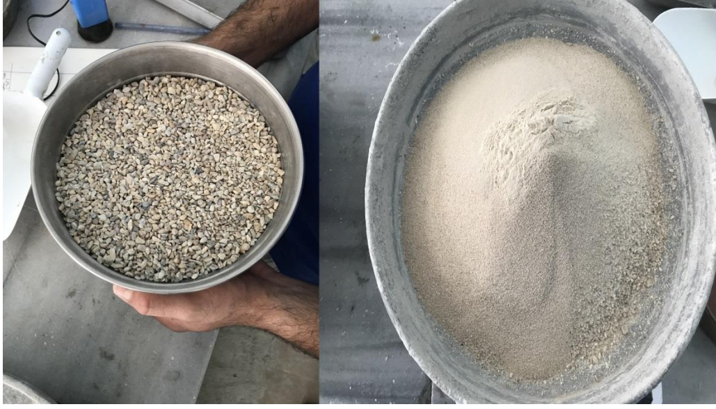
Şekil 3.3. Dane çapı dağılım deneyinin yapılması
