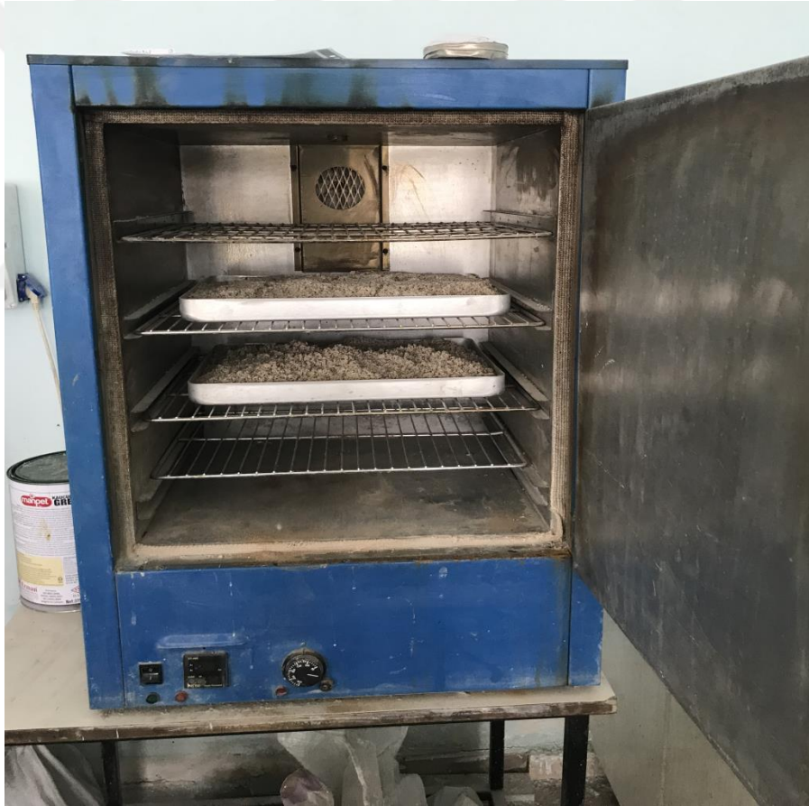
Şekil 3.2. Zemin numunesinin etüvde kurutulması işlemi
