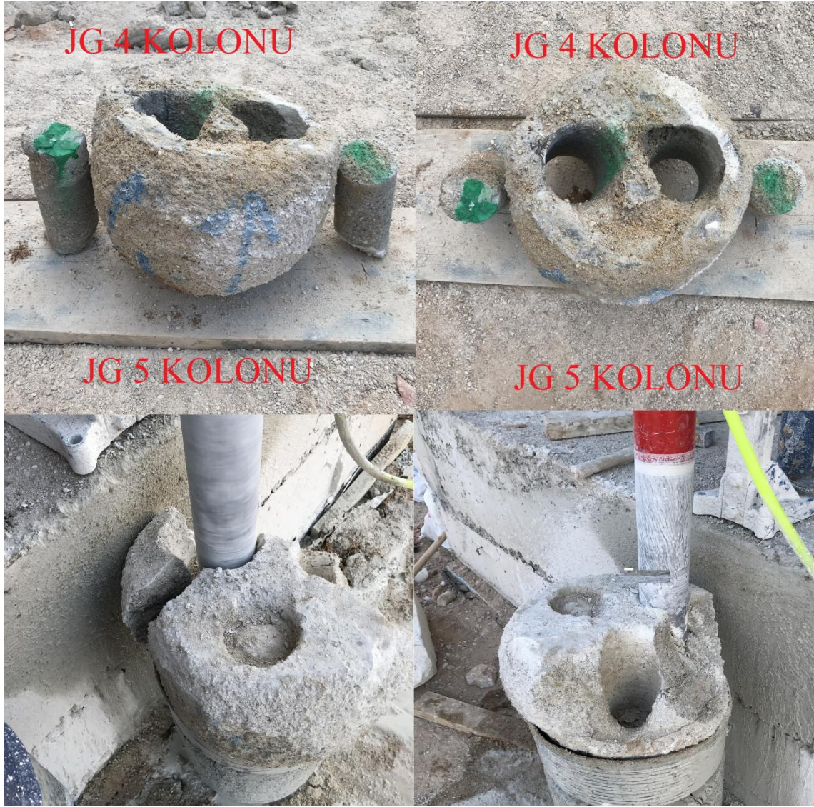
Şekil 4.32. 4 ve 5 nolu kolonlardan karot alınması
