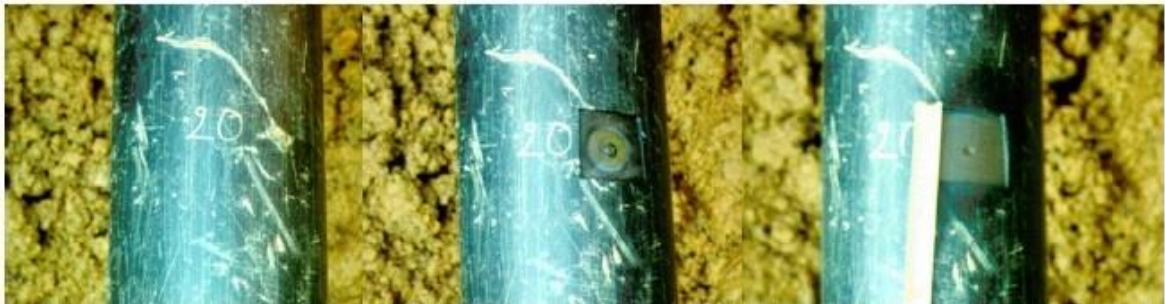
a) Kaplama kusuru (15x20 mm), delik yaklaşık birkaç mm 2
