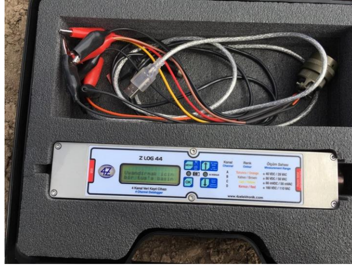
Şekil 5.10. Z-Log 44 veri kayıt cihazı
