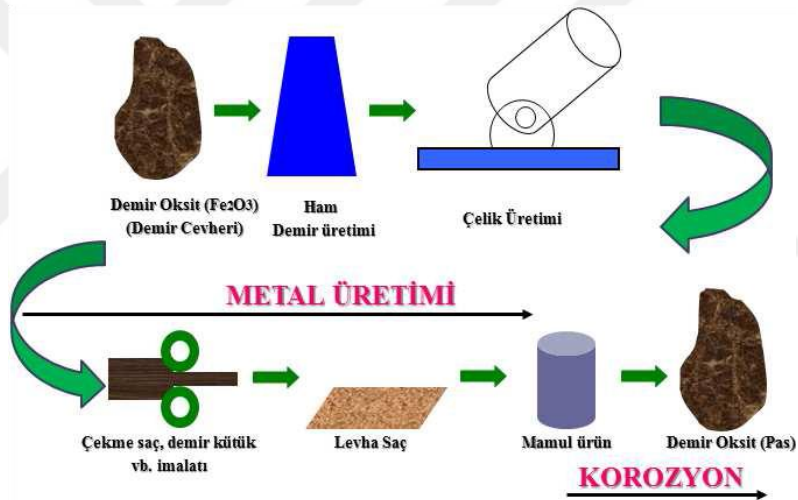
Şekil 2.1. Metal üretimi ve korozyon oluşumu
