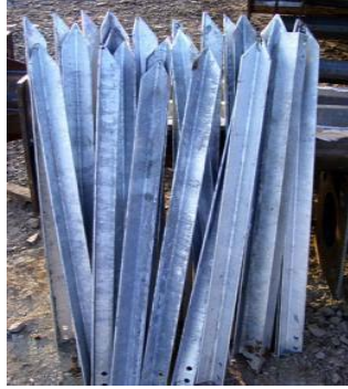
Şekil 5.5. Sıcak daldırma galvanizli topraklama elemanları
