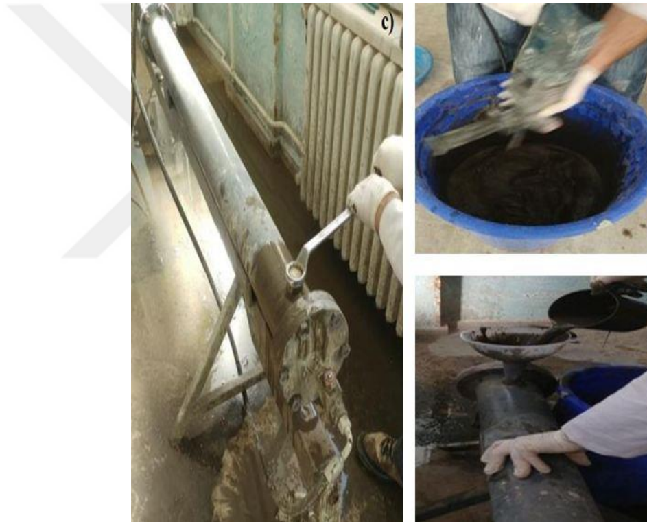
Şekil 3.35 Enjeksiyon karışımının hazırlanması ve deney düzeneğinin haznesine konması
