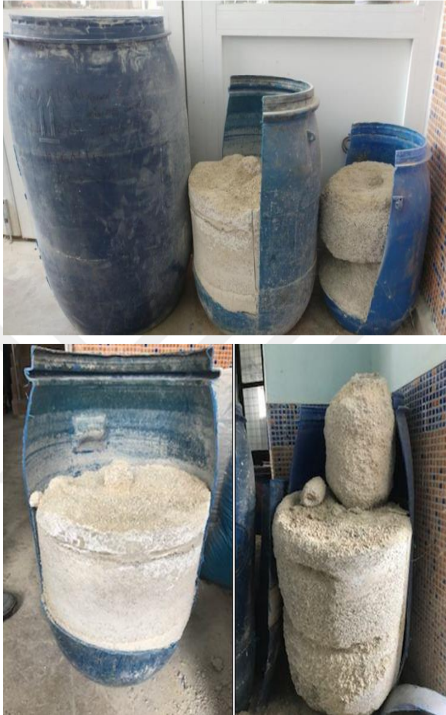
Şekil 3.34 Farklı ebatlardaki plastik variller kullanılarak imal edilen deneme kolonları
