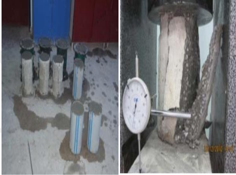
Şekil 3.28 Sülfat maruz bırakılmış silindirik beton numunelere yapılan basınç dayanım testi (Yıldız, 2010)
