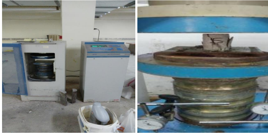
Şekil 4.5 Karot numunelere uygulanan serbest basınç dayanım testi
