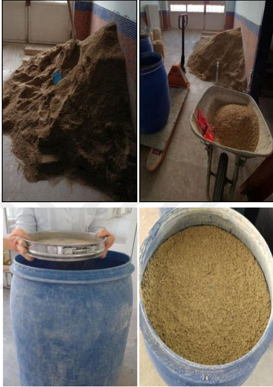
Şekil 3.33 Doğal kum kullanılarak plastik varillerin içinde kum zemin ortamının hazırlanması
