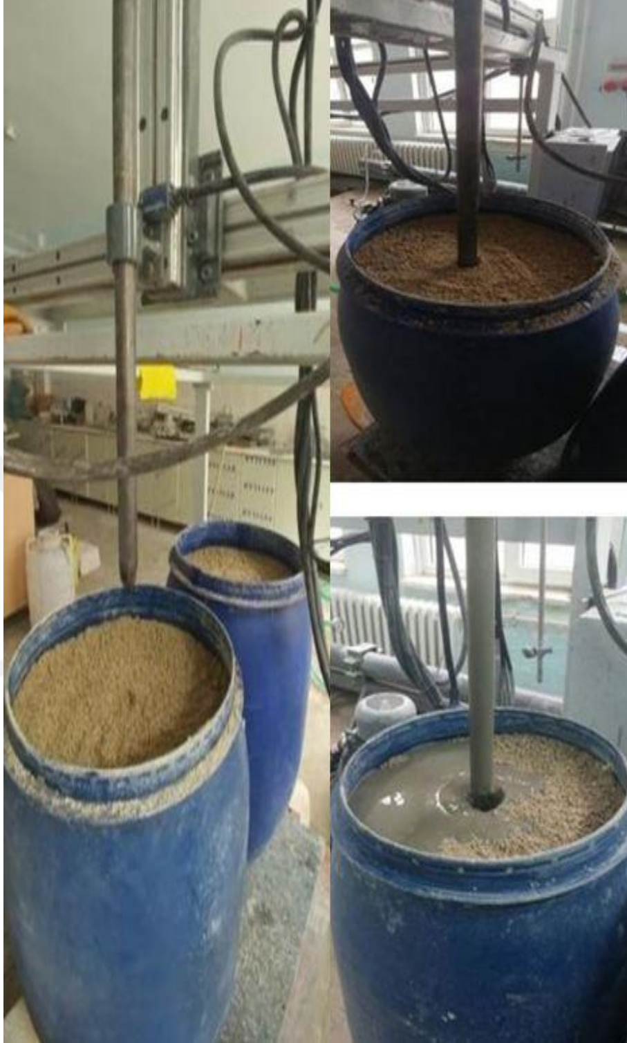
Şekil 3.36 Üretilen jet grout kolonların üretim aşaması
