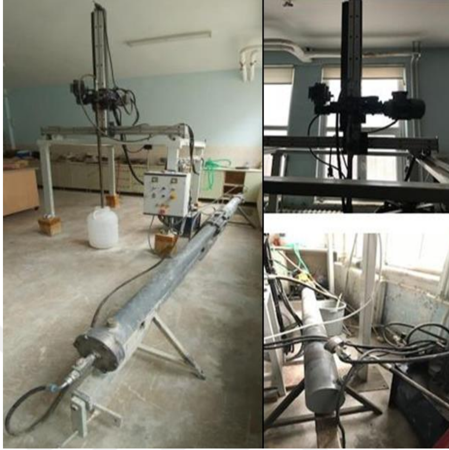
Şekil 3.30 Tez çalışmasında kullanılan jet grout düzeneği
