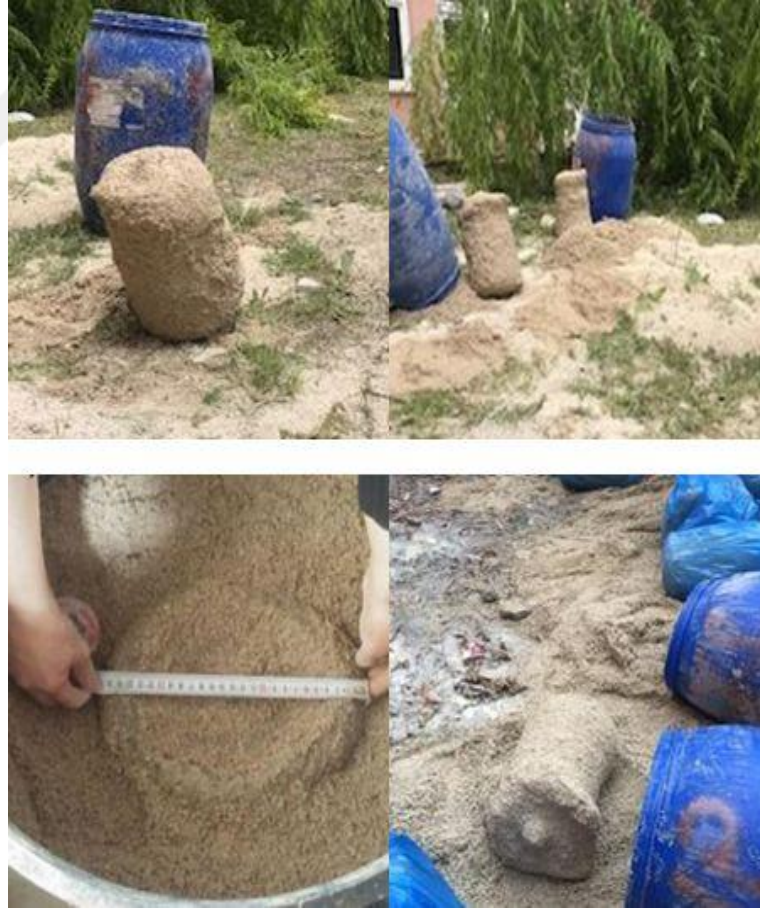
Şekil 4.1 İmal edilen jet grout kolonların plastik varillerden çıkarılması boy ve çap kontrollerini yapılması
