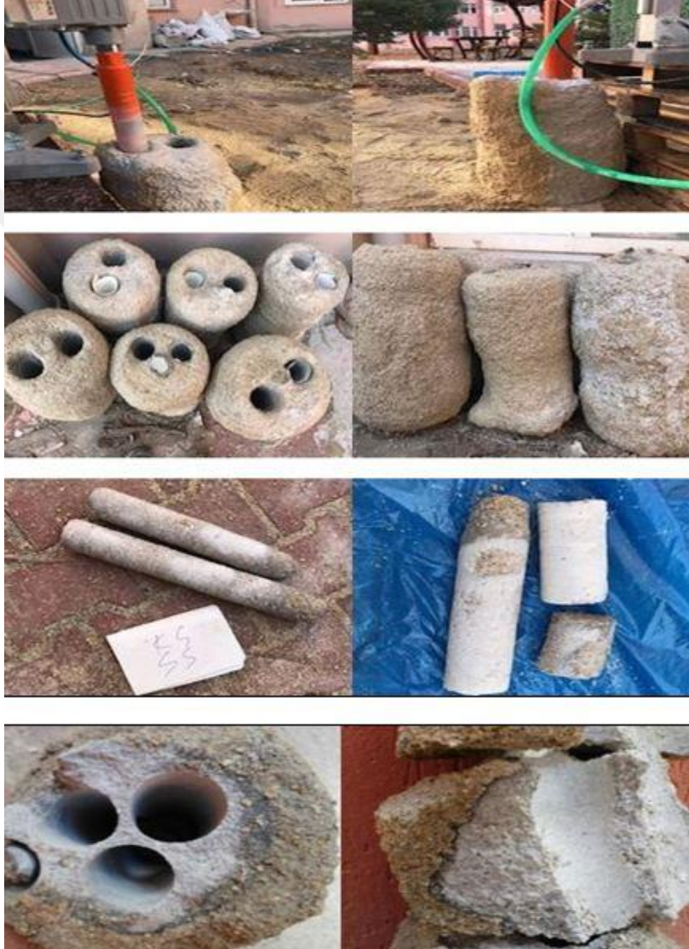
Şekil 4.3 İmal edilen jet grout kolonlardan silindirik karot alma işlemleri, jet grout kolonlaraki iyi ve az çimentolanmış bölgelerin tespiti
