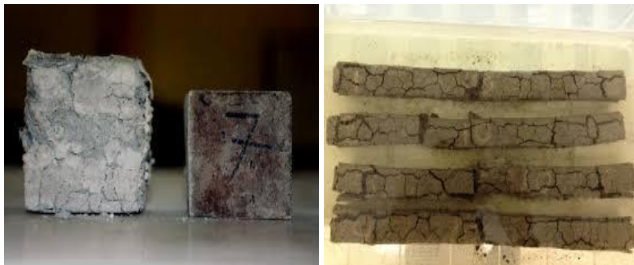
Şekil 3.27 Beton üzerinde sülfat etkisi ile oluşan bozulmalar
