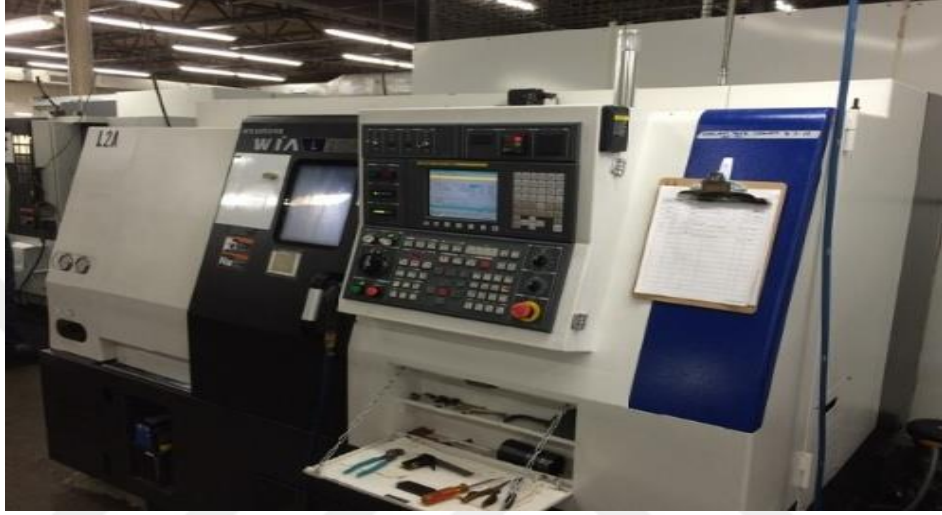
Şekil 11.4. HYUNDAI WIA L210LA CNC torna tezgahı
