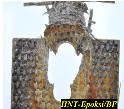
Şekil 4.7. Cıvata bağlı epoksi/BF kompozit ve HNT-epoksi/BF nanokompozit malzemenin çekme testi sonrası hasar görüntüleri
