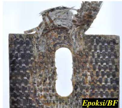
Şekil 4.7. Cıvata bağlı epoksi/BF kompozit ve HNT-epoksi/BF nanokompozit malzemenin çekme testi sonrası hasar görüntüleri
