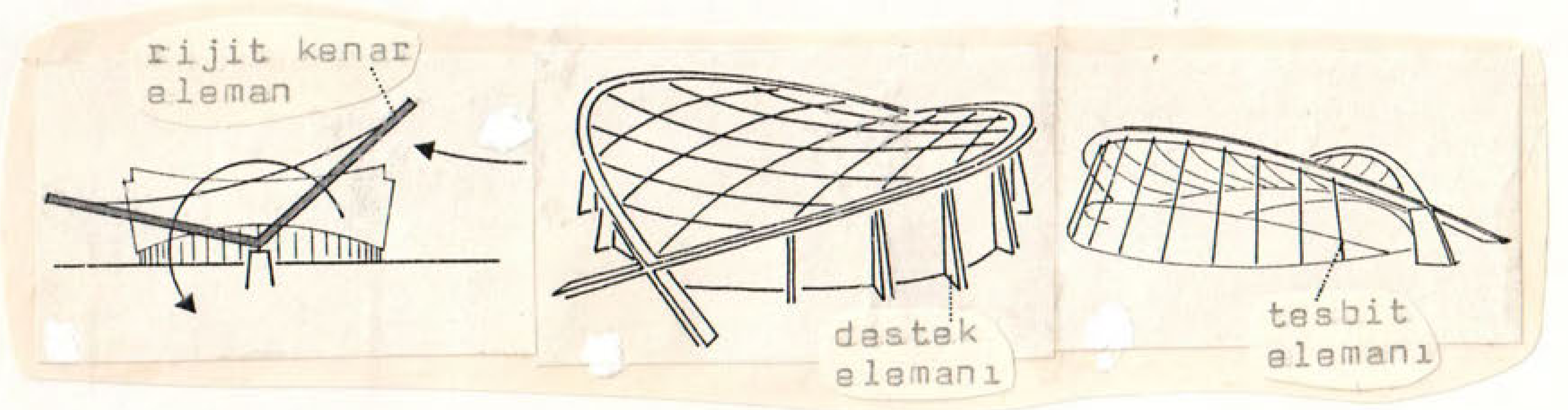
Şekil 24: Sistemin stabilitesi için mesnetlenmesi veya tesbit edilmesi.
