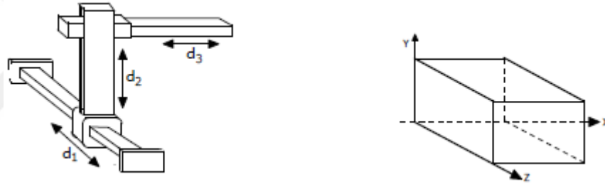
Şekil 3.3. Kartezyen robot ve çalışma uzayı (Bingül ve Küçük, 2005)
