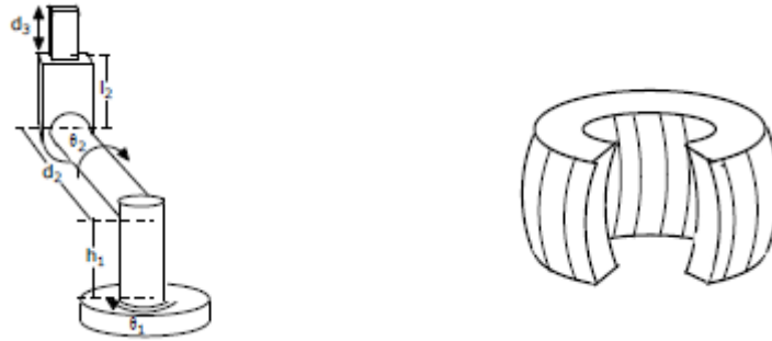
Şekil 3.5. Küresel robot ve çalışma uzayı (Bingül ve Küçük, 2005)
