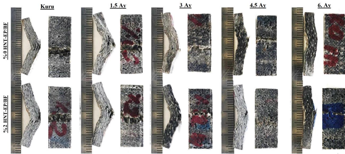
Şekil 4. 28. Kısa kiriş kayma testlerine maruz bırakılmış tabakalı kompozitlerin görüntüleri
