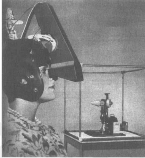
Şekil 3.22. Baş hareketlerini takip eden video kamera sistemi (Sherman ve Craig, 2003)
