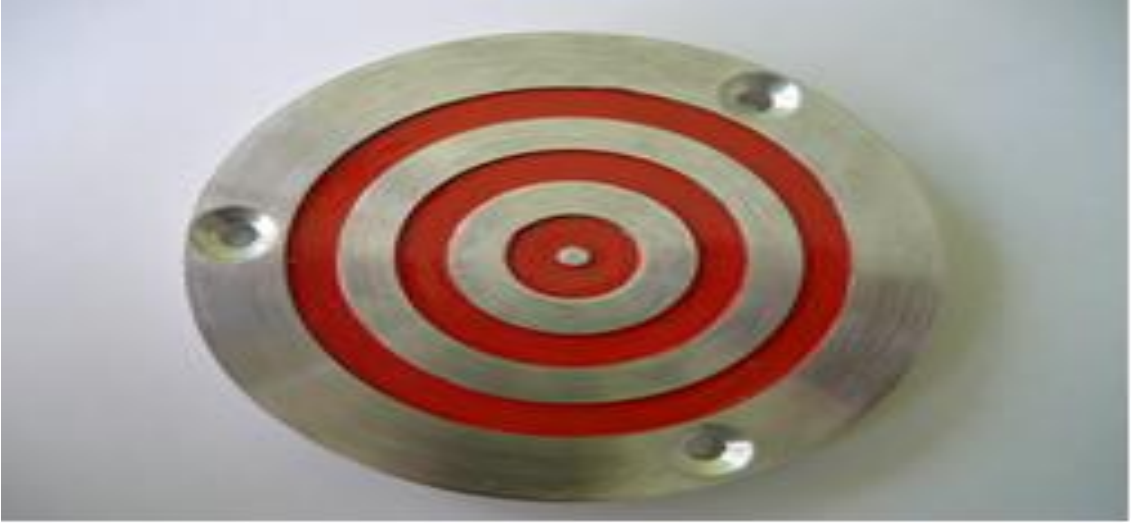
Şekil 6.10. Baraj gövdesinin her iki tarafına yerleştirilmiş obje noktaları hedef levhası
