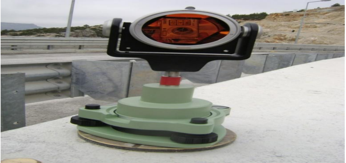
Şekil 6.11. Baraj Kreti obje noktasına monte edilmiş tribrah ve GPH1P hassas prizma
