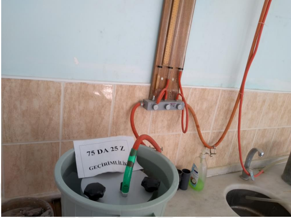
Şekil 3.17. Düşen seviyeli geçirimsizlik deneyi düzeneği
