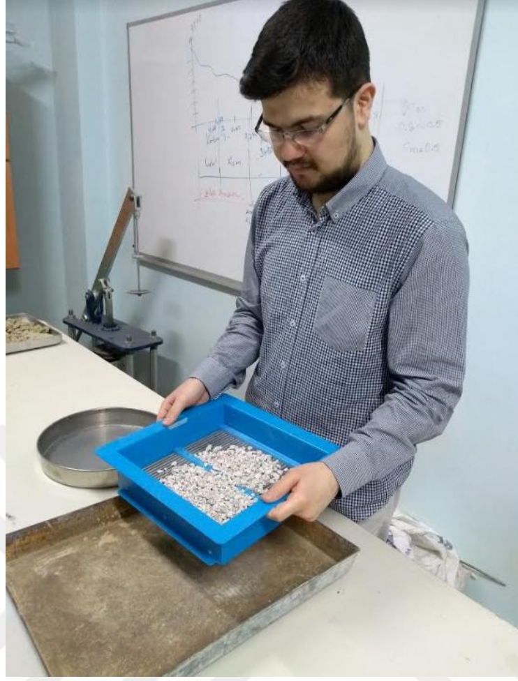
Şekil 3.6. Yassılık endeksi deneyinin yapılışı
