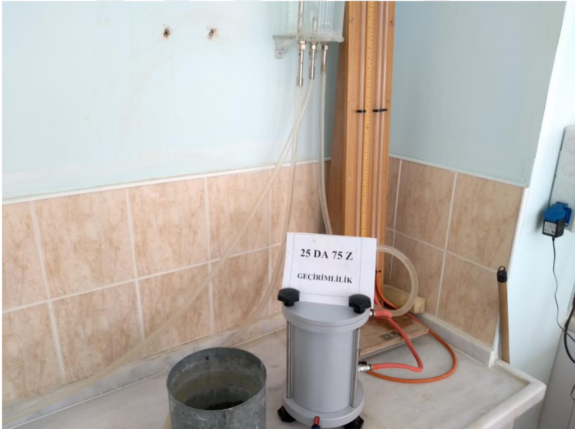
Şekil 3.18. Sabit seviyeli geçirimsizlik deneyi düzeneği
