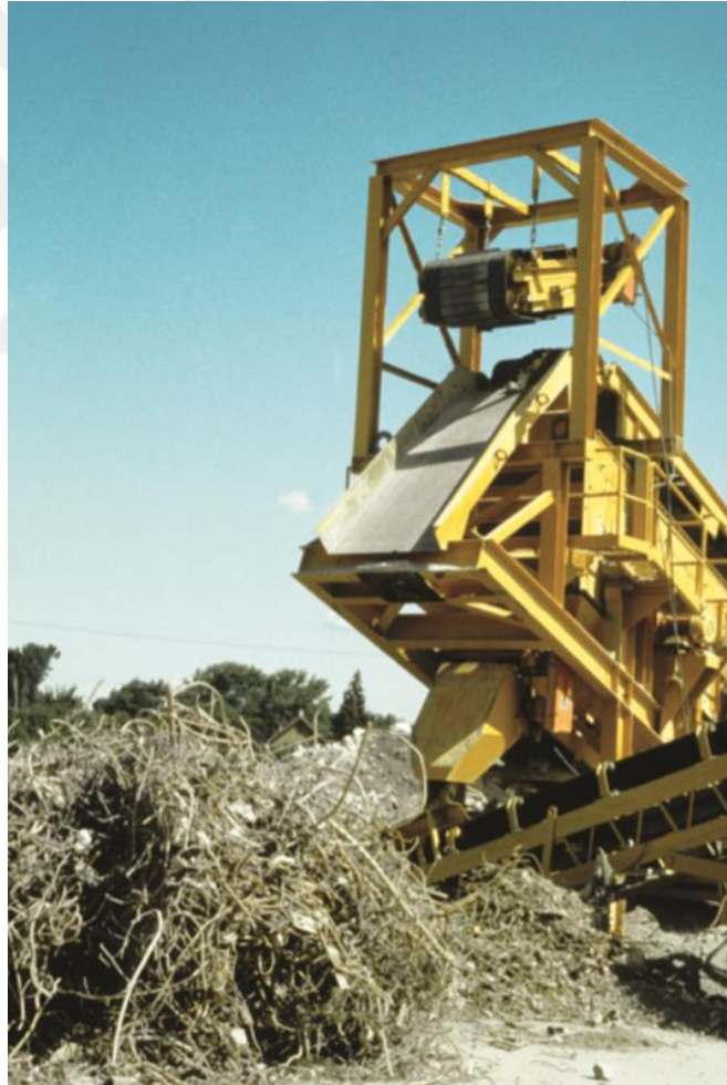
Şekil 1.4. Kırıcıda donatıların ayrıştırılması (TS043.2P, 2009)
