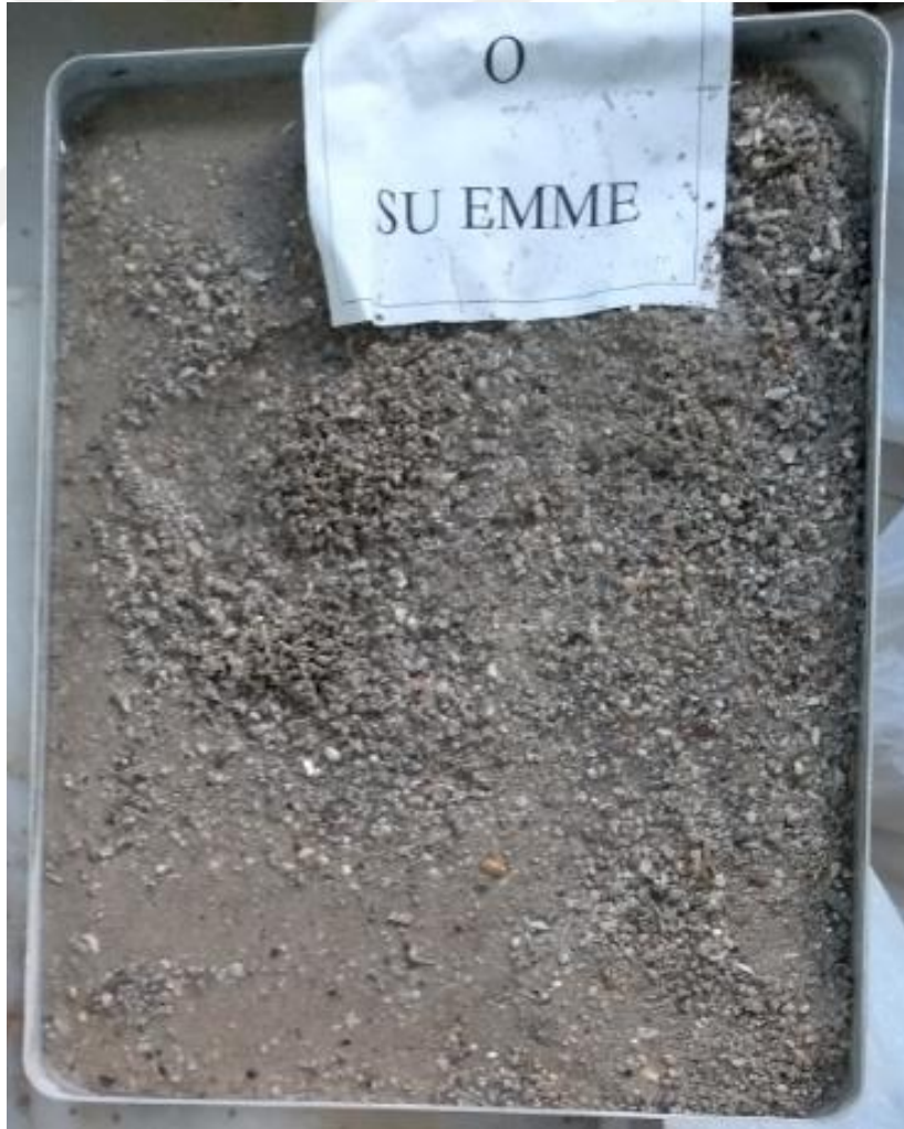
Şekil 3.9. Su emme değerini bulmak için suya daldırıldıktan sonra kuruması beklenen malzeme
