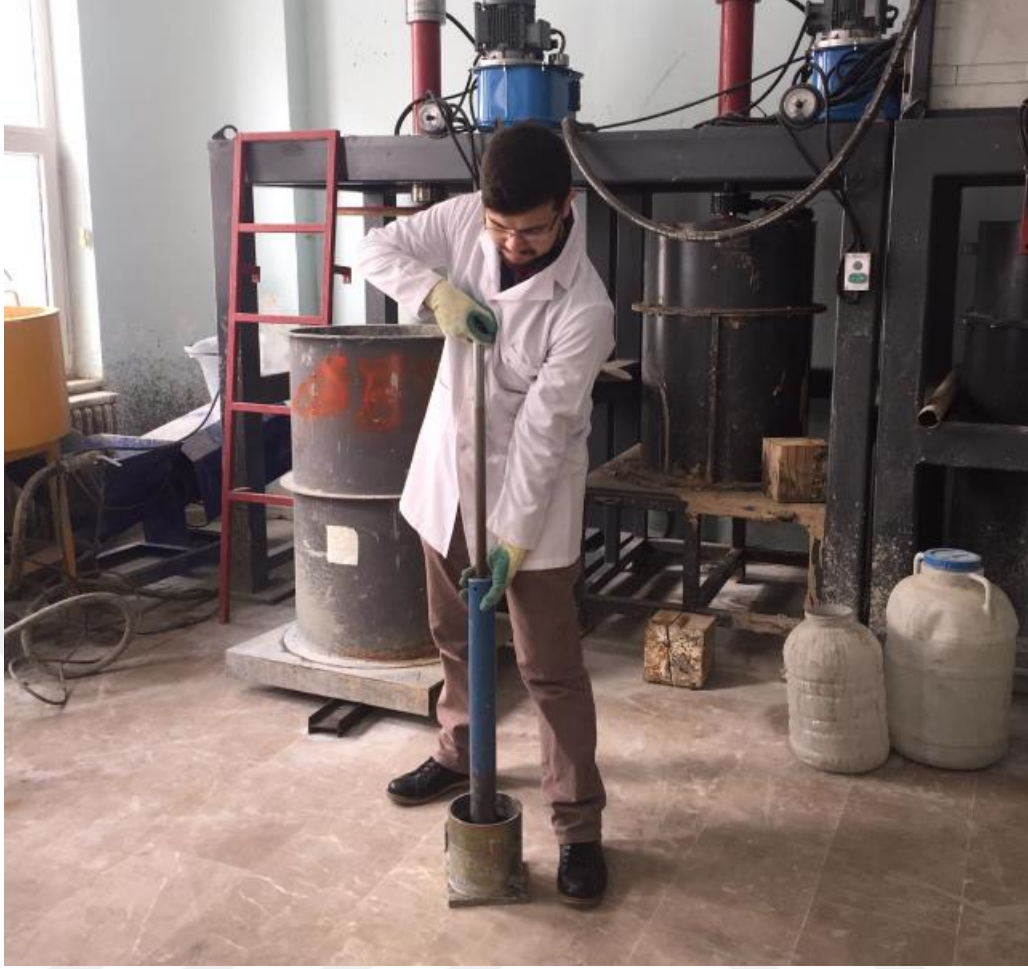
Şekil 3.14. Kompaksiyon kalıbına malzemenin sıkıştırılarak yerleştirilmesi
