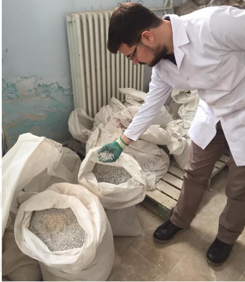
Şekil 3.4. Elenerek tane fraksiyonlarına göre çuvallara doldurulmuş GDBA'lar
