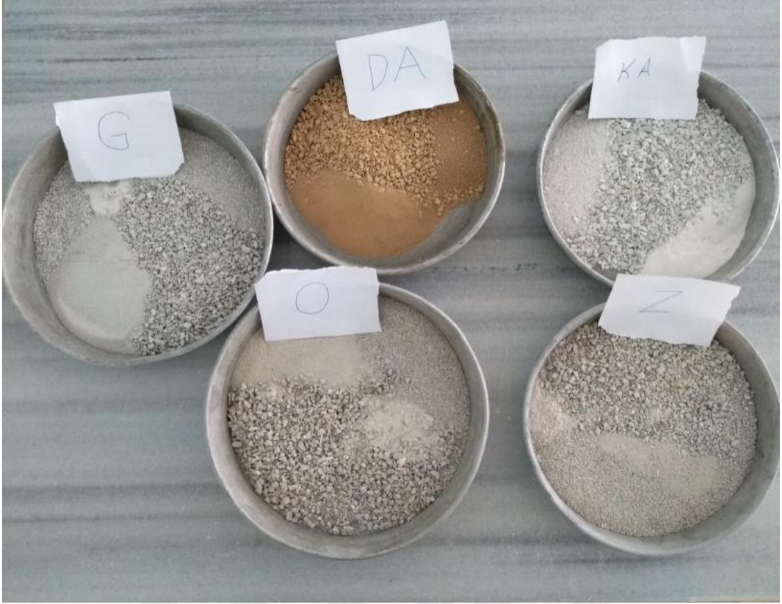
Şekil 3.8. Tane yoğunluğu değerlerinin bulunması için ayrılan malzemeler
