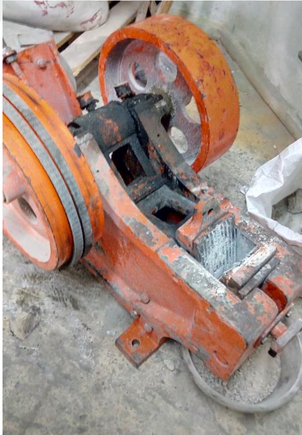
Şekil 3.3. GDBA'ların uygun gradasyona getirilmesinde kullanılan laboratuvar tipi çeneli kırıcı
