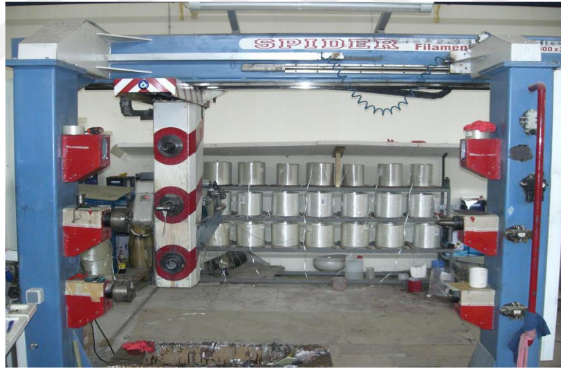
Şekil 4.1 CNC filaman sarım makinesi (Demirci, 2015).
