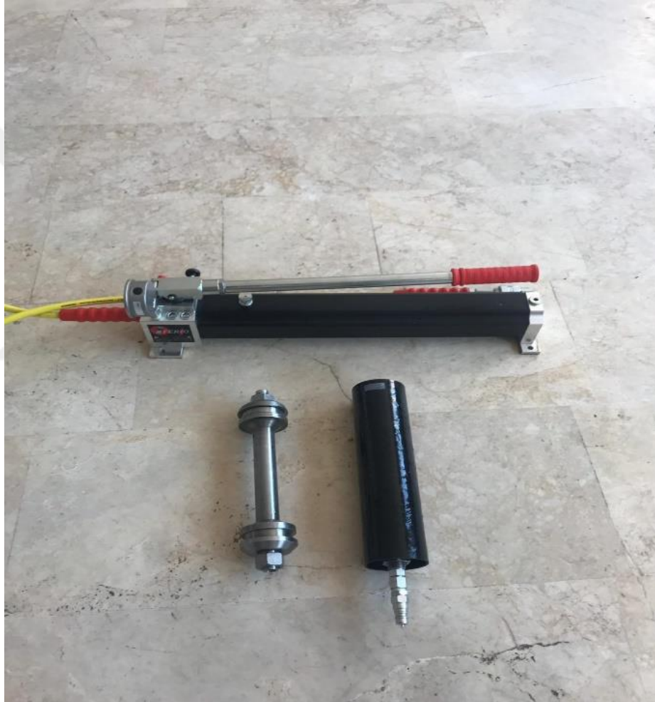
Şekil 4.5 Kompozit boruların iç basınç test düzeneği
