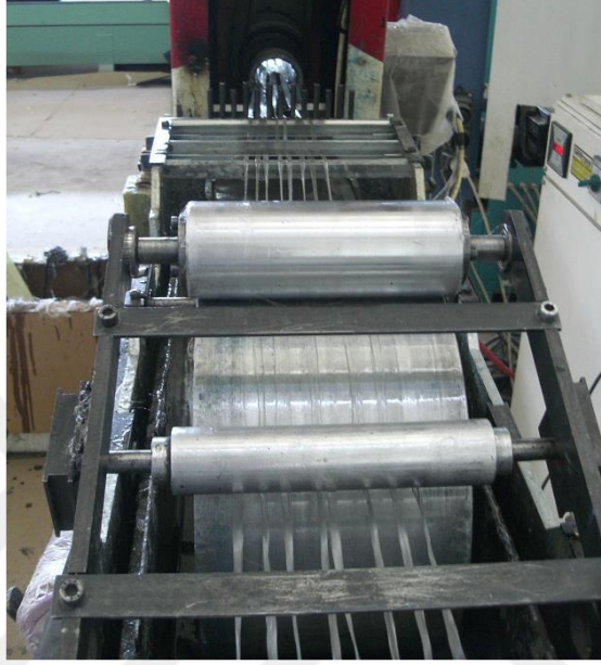
Şekil 4.2 Reçine banyosunda ıslatılan elyaf demetleri (Demirci, 2015).
