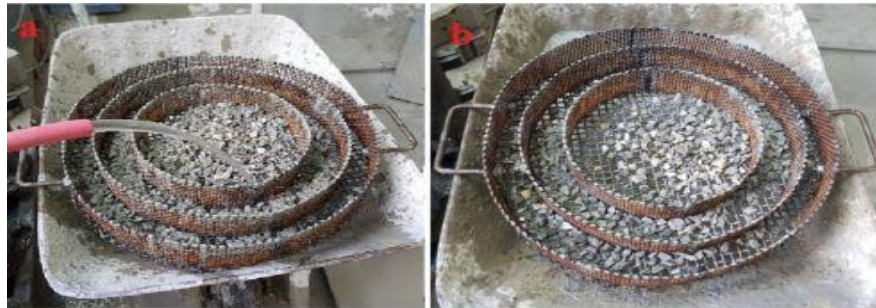
Şekil 2.8. Betonun ıslak elenmesi (a) kaba agrega dağılımı (b) (Gökçe ve ark., 2018)
