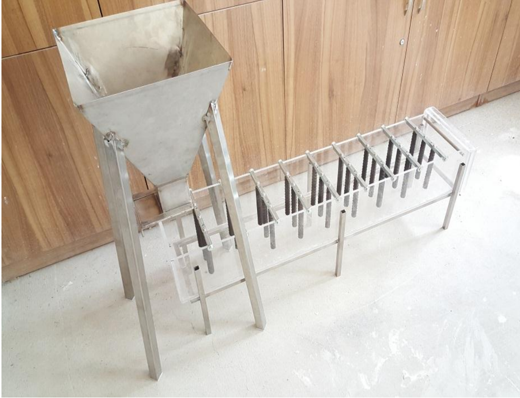
Şekil 3.3. Fonksiyonel geçiş kalıbı ve akış konisi
