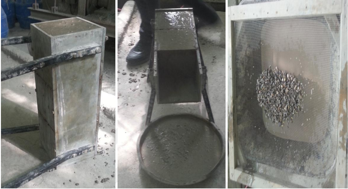
Şekil 3.9. Kolon segregasyon deneyinin uygulama detayları
