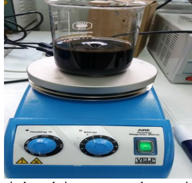
Şekil 3.1. Nanoparçacık üretiminde reaksiyonun tamamlanması için uygulanan karıştırma işlemi
