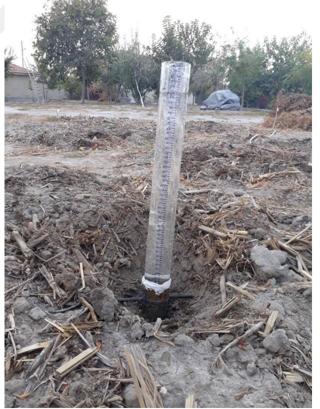
Şekil 3. 15 Fibreglas borudan hazırlanan düzenekler kullanılarak arazi üzerindeki infiltrasyon hız ölçümleri
