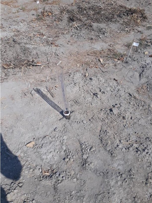
Şekil 3. 15 Fibreglas borudan hazırlanan düzenekler kullanılarak arazi üzerindeki infiltrasyon hız ölçümleri
