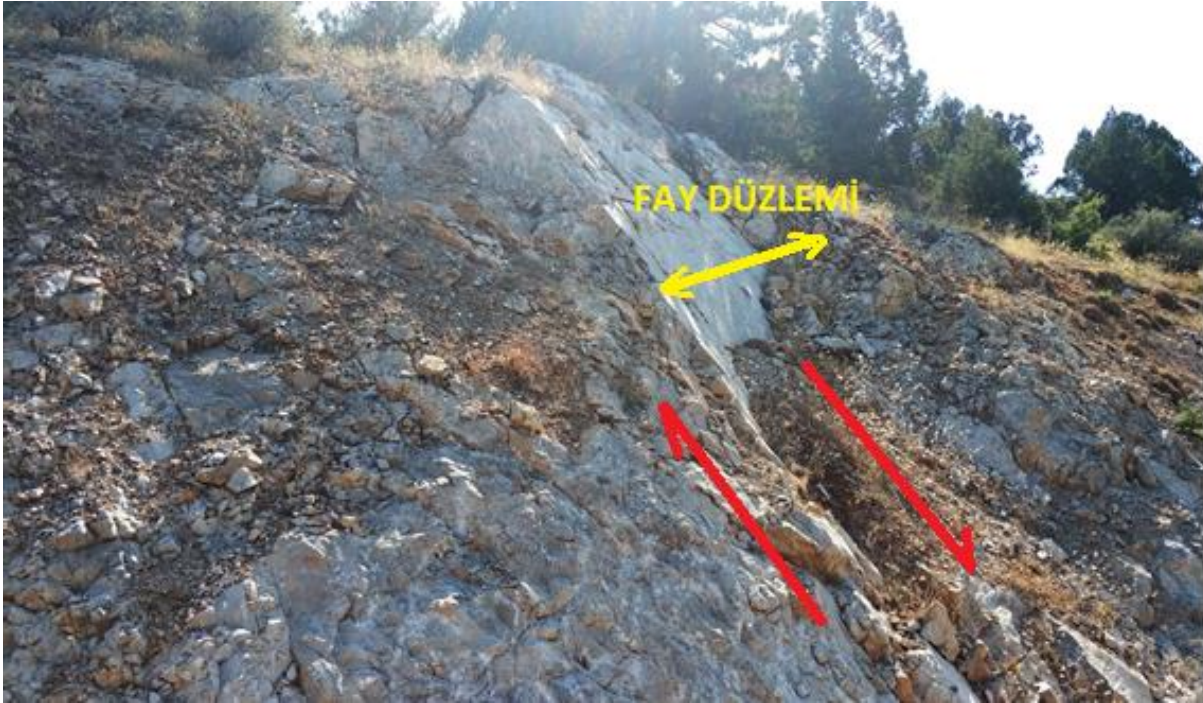
Foto 5.7 Üstünler-Huğlu anayoluna yaklaşık koşut gelişmiş, Geçitçayırdere'den geçen eğim atımlı normal fay (Koordinat: 374058D, 4153705K Foto: KB-GD yönlü)
