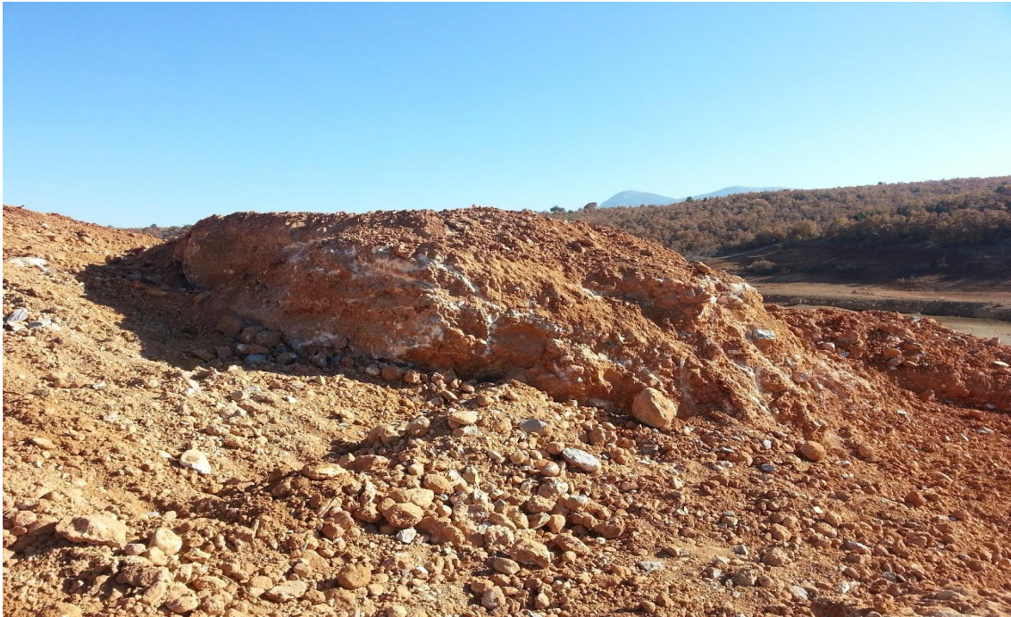
Foto 4.39 Üzümlü göleti onarımında Aşağıçığil formasyonunun içerisinde ortaya çıkan konglomeratik mercek (Koordinat: 380135D, 4159115K Foto: KB-GD yönlü)
