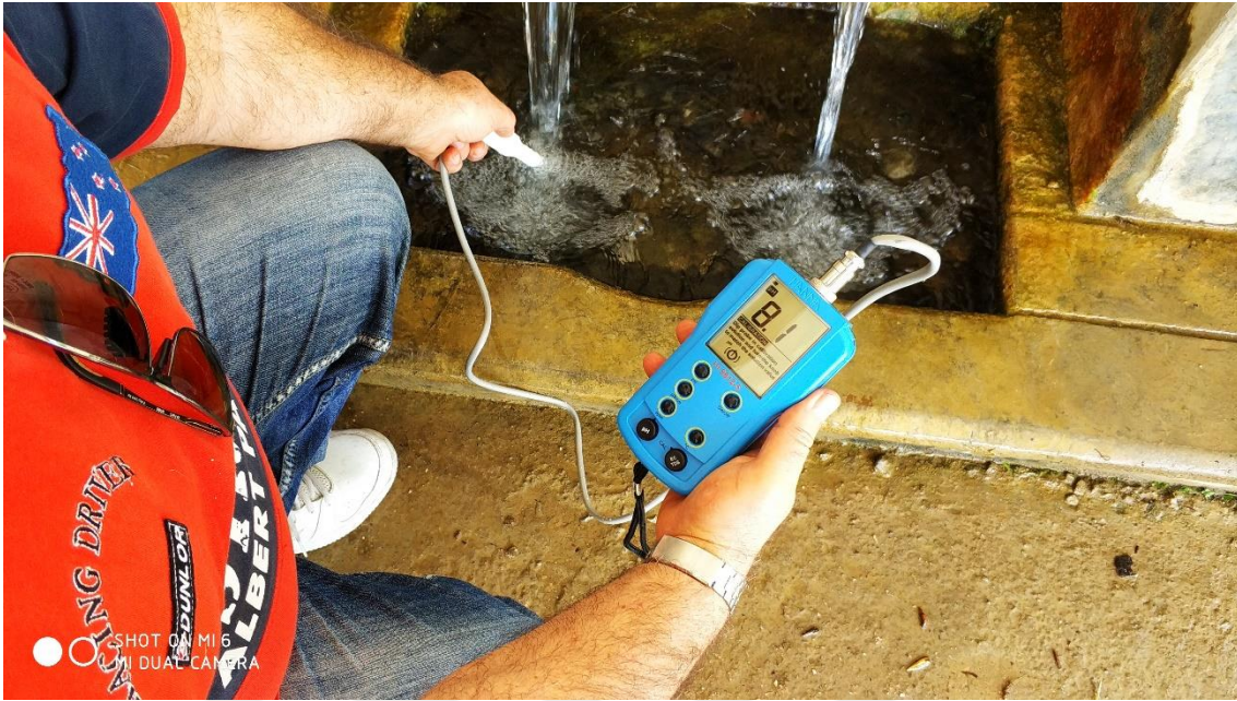
Foto 8.9 Suatoluđu kaynađında pH deđerinin ölçülmesi
