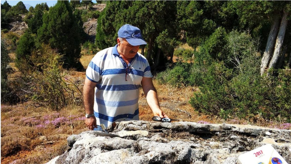
Foto 5.5 Şamlar köyü, Sobova vadisinde Bolat formasyonuna ait tabaka konumlarının ölçülmesi
