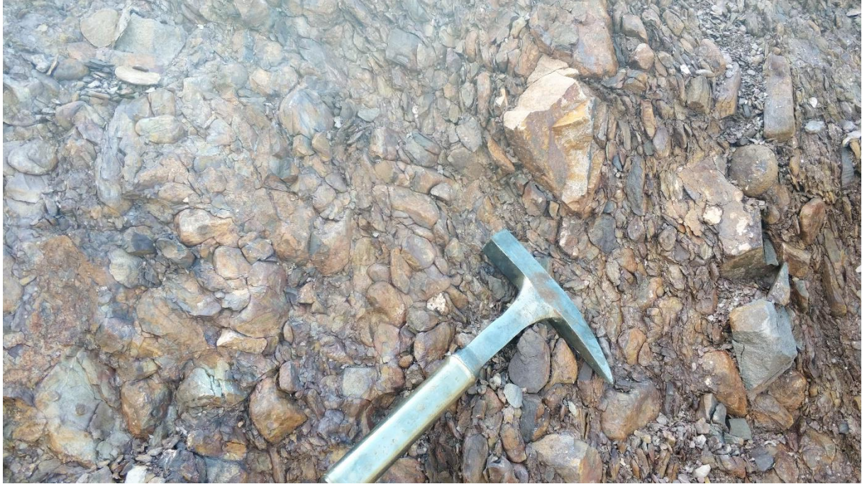
Foto 4.7 Pınarbaşı formasyonunda yer alan bordo, mor, kırmızı konglomeralardan bir görünüm (Foto, Tarasçı kasabasının 1.5 km batısında Sarpyardere formasyonu tip yerinden çekilmiştir)
