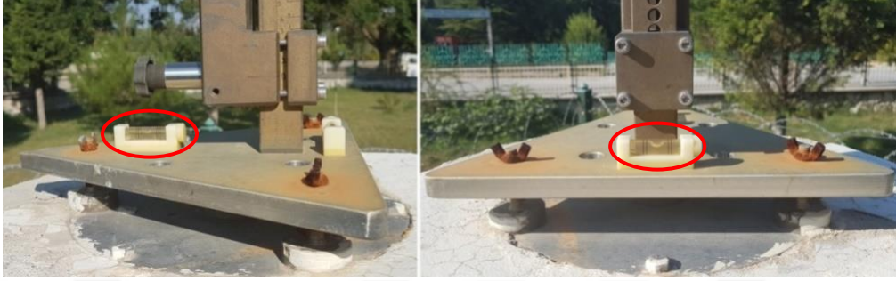
Şekil 6.6. Üçgen Tabla Üzerindeki Silindirik Düzeçler.
