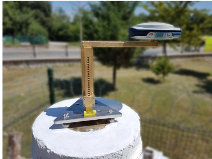
Şekil 6.5. Pilye Üzerine Düzeneğin Yerleştirilmesi.
