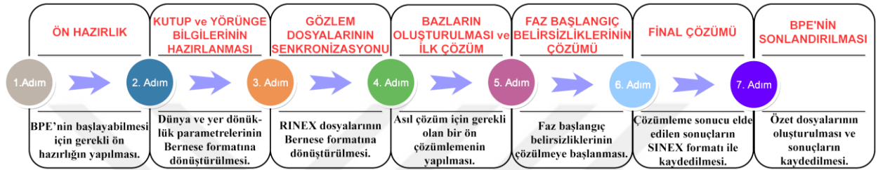
Şekil 4.8. RNX2SNX.PCF Otomatik Çözümleme Komutu İş Akışı.
