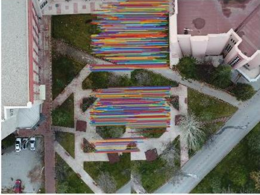
Şekil 3.13. Doğru olmayan eşleşmelerin kaldırılması ve homografi hesaplamasıyla görüntülerin aynı koordinat düzlemine getirilmesi
