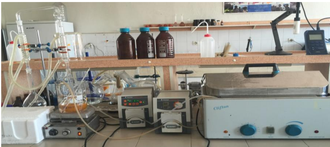
Şekil 3.1. Biyodizel üretiminde kullanılan geri soğutuculu kapalı sistem
