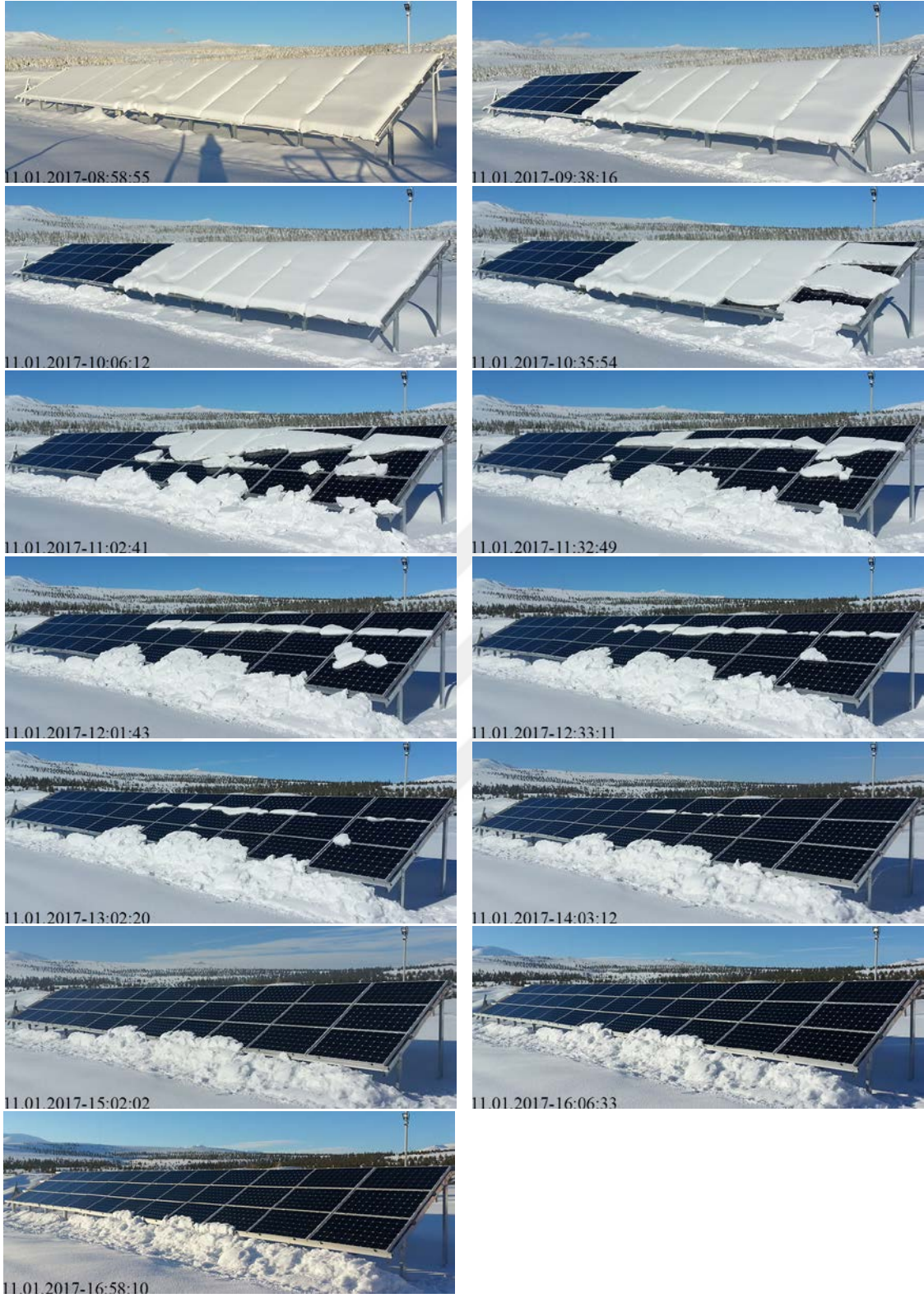
Şekil 6.32. Dizeler üzerindeki kar örtüsünün gün içindeki değişimi (11 Ocak 2017)
