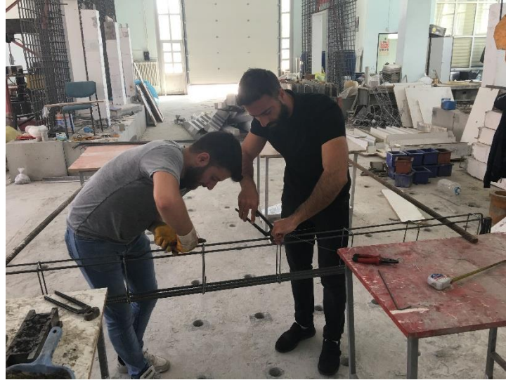
Şekil 3.18. Kiriş numunelerinde kullanılan etriye
