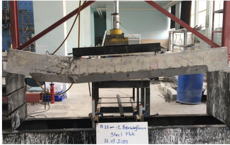
Şekil 4.17. ( BBS28mm-S ) Nolu kiriş numunenin son hali
