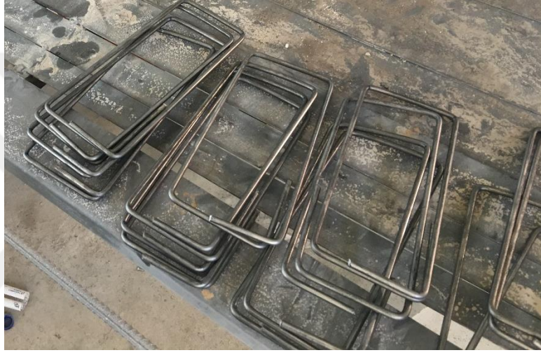
Şekil 3.17. Kiriş numunelerinde kullanılan etriye
