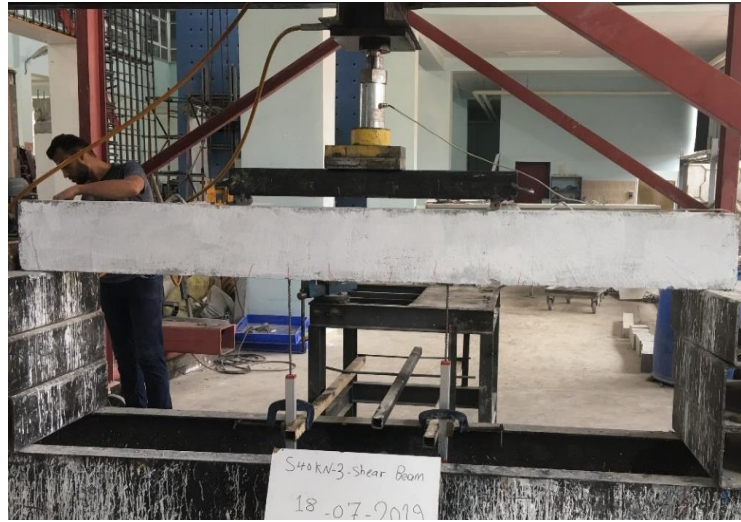
Şekil 4.51. ( PDSB40kN-C ) Nolu hasarlı kiriş numunesi
