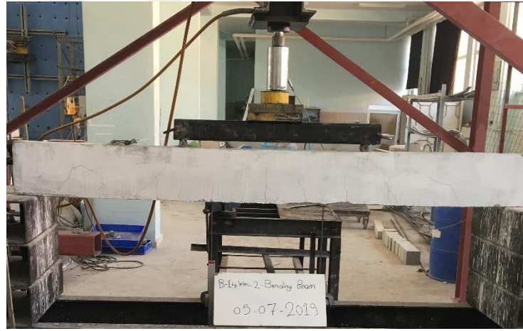
Şekil 4.8. ( PDB14mm-M ) Nolu hasarlı kiriş numunesi
