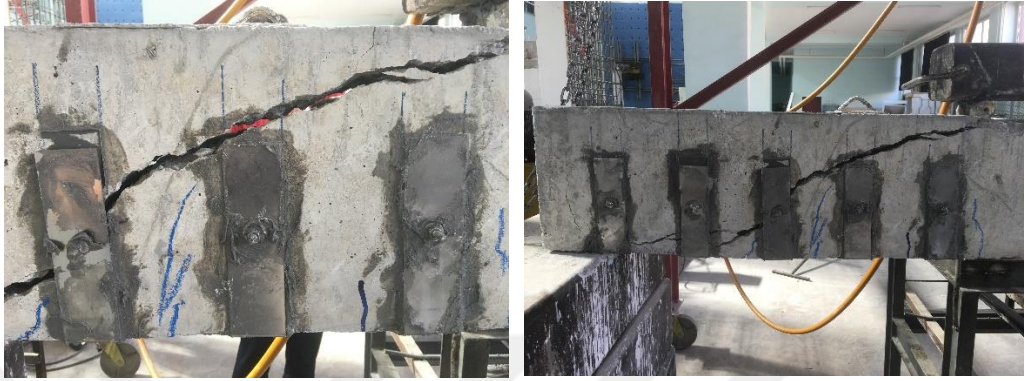
Şekil 4.49. Göçme anındaki ( SBS40kN-S ) nolu kiriş numune
