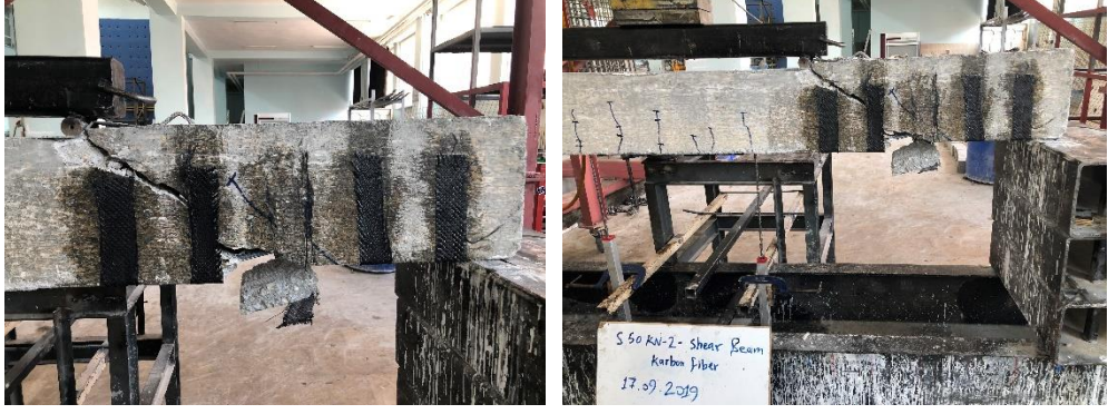
Şekil 4.61. Göçme anındaki ( SBS50kN-C ) nolu kiriş numune
