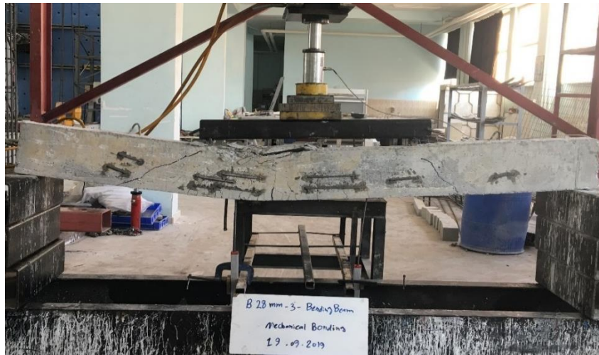
Şekil 4.25. ( BBS28mm-M ) Nolu kiriş numunenin son hali
