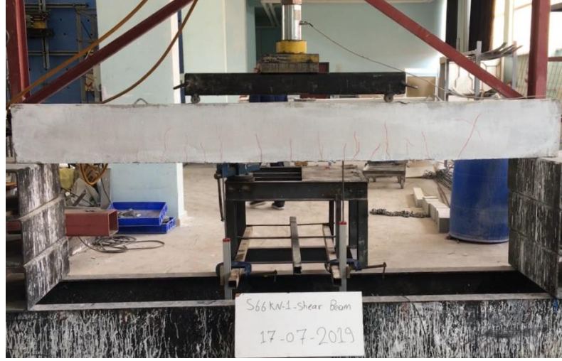
Şekil 4.67. ( PDSB66kN-C ) Nolu hasarlı kiriş numunesi
