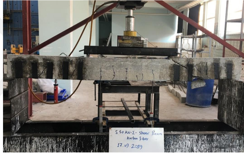
Şekil 4.60. ( SBS50kN-C ) Nolu kiriş numunenin son hali
