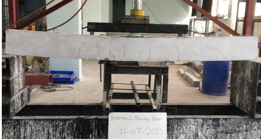
Şekil 4.32. ( PDB40mm-M ) Nolu hasarlı kiriş numunesi
