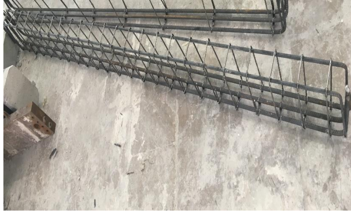
Şekil 3.16. Kesme kiriş numunelerine ait donatı detayları
