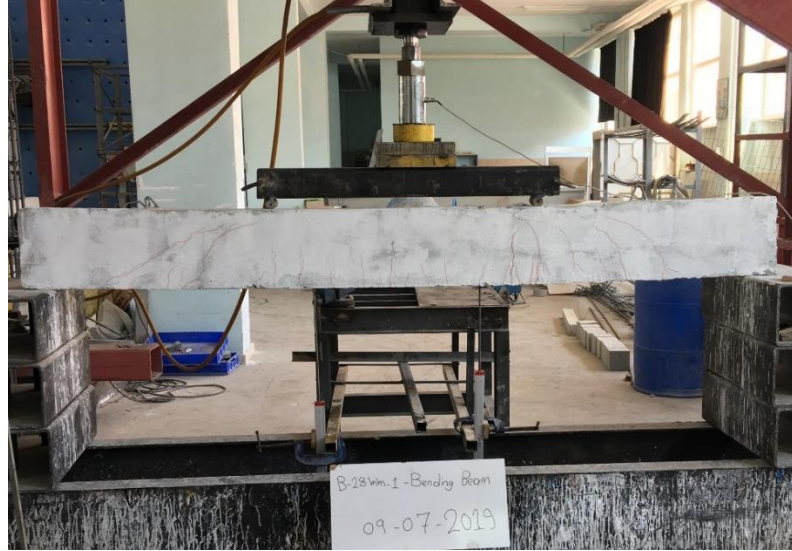
Şekil 4.16. ( PDB28mm-S ) Nolu hasarlı kiriş numunesi
