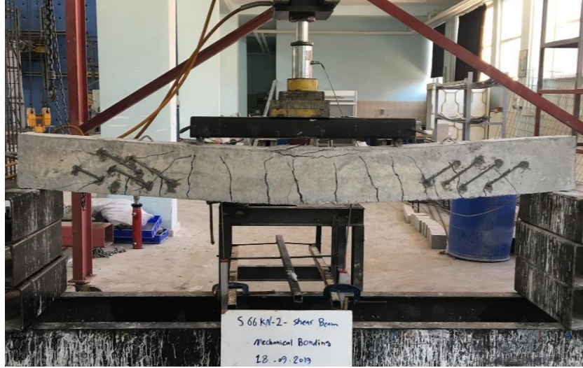
Şekil 4.72. ( SBS66kN-M ) Nolu kiriş numunenin son hali
