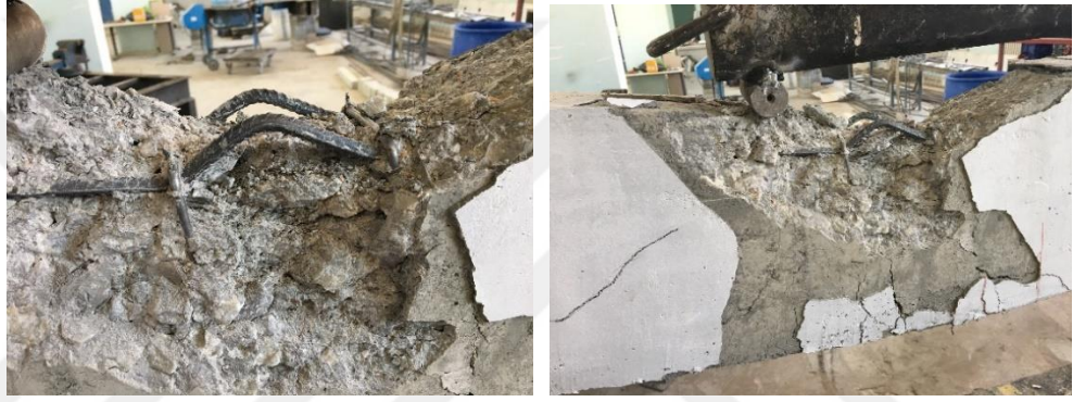
Şekil 4.2. Göçme anındaki eğilme referans numunesi
