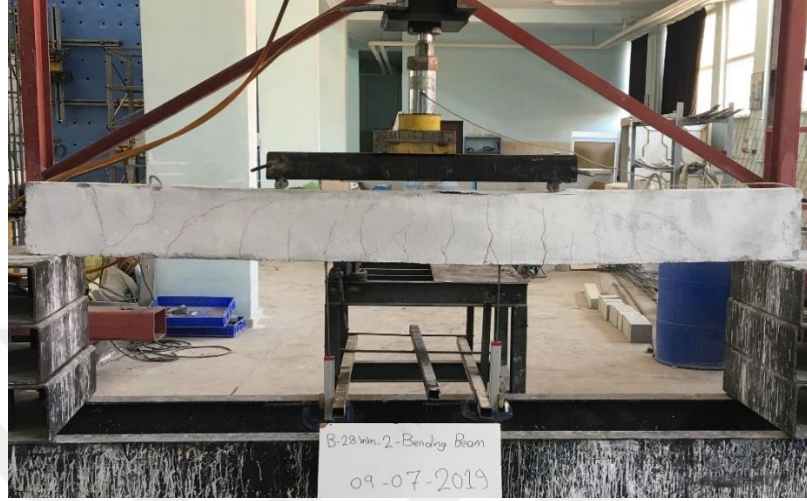
Şekil 4.20. ( PDB28mm-C ) Nolu hasarlı kiriş numunesi
