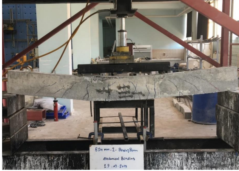
Şekil 4.9. ( BBS14mm-M ) Nolu kiriş numunenin son hali
