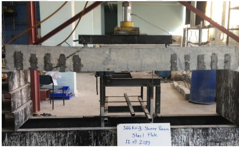
Şekil 4.76. ( SBS66kN-S ) Nolu kiriş numunenin son hali
