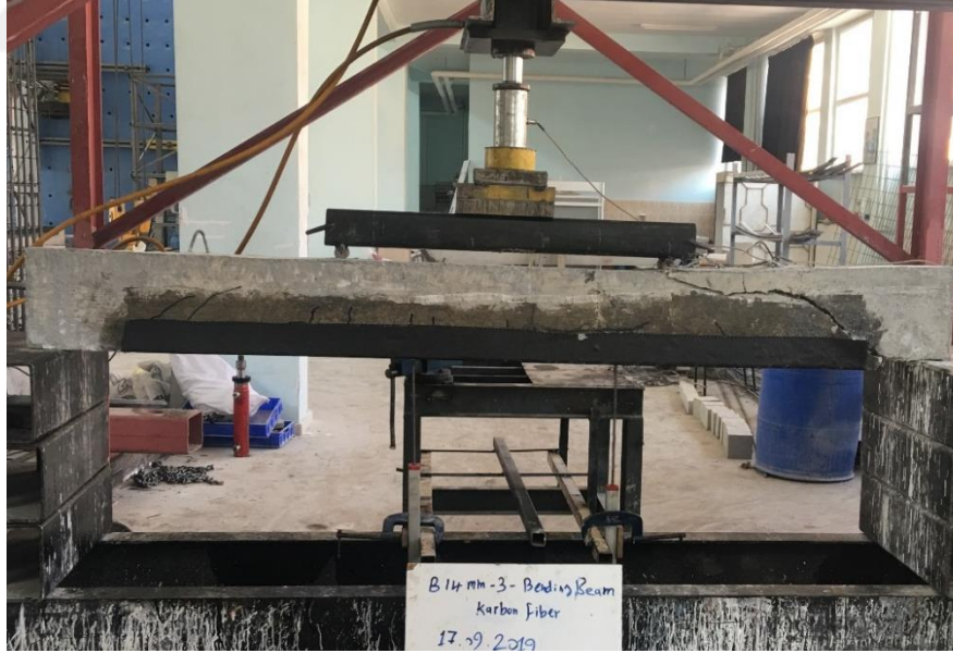
Şekil 4.13. ( BBS14mm-M ) Nolu kiriş numunenin son hali
