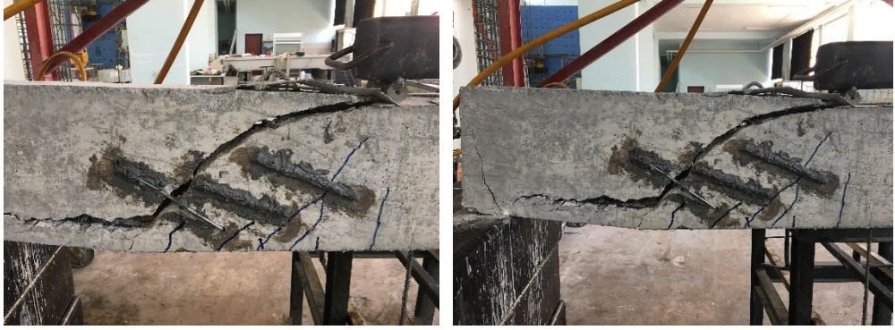
Şekil 4.57. Göçme anındaki ( SBS50kN-M ) nolu kiriş numune
