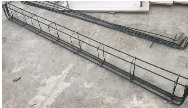
Şekil 3.15. Kesme kiriş numunelerine ait donatı detayları
