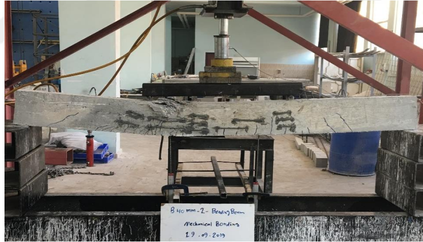
Şekil 4.33. ( BBS40mm-M ) Nolu kiriş numunenin son hali
