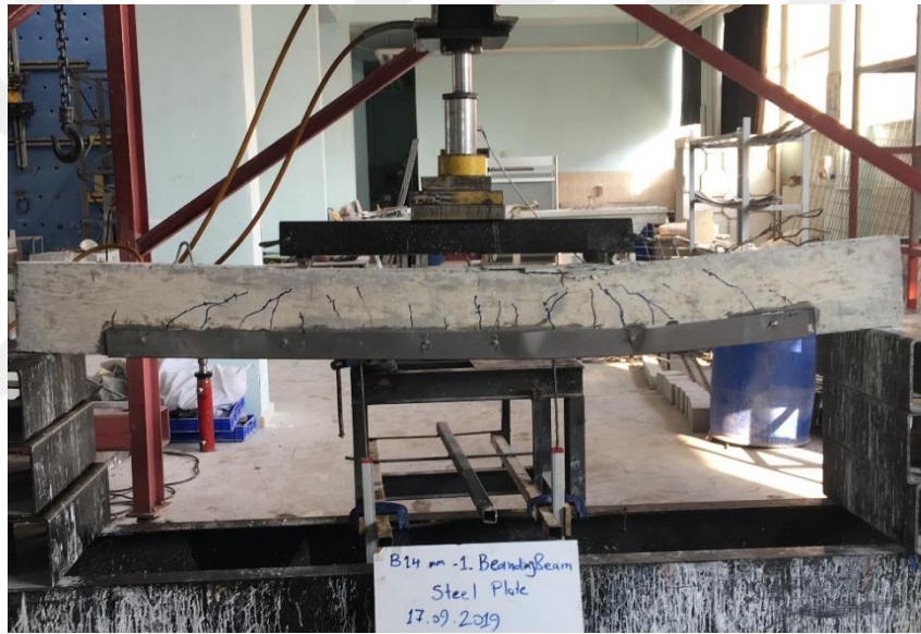
Şekil 4.5. ( BBS14mm-S ) Nolu kiriş numunenin son hali
