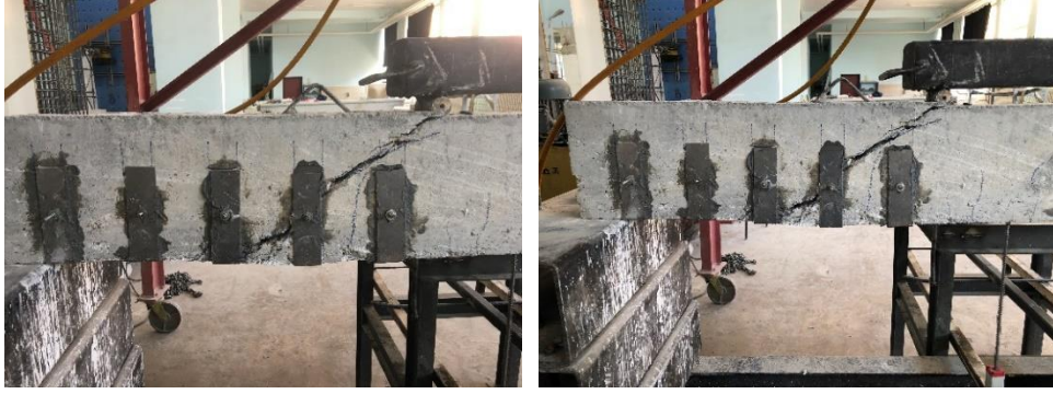
Şekil 4.77. Göçme anındaki ( SBS66kN-S ) nolu kiriş numune
