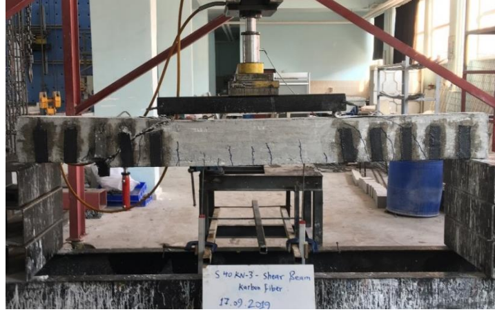
Şekil 4.52. ( SBS40kN-C ) Nolu kiriş numunenin son hali
