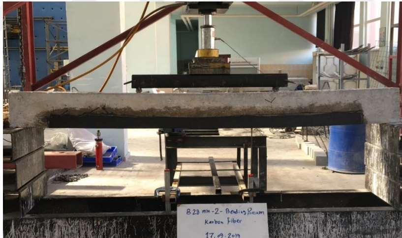
Şekil 4.21. ( BBS28mm-C ) Nolu kiriş numunenin son hali
