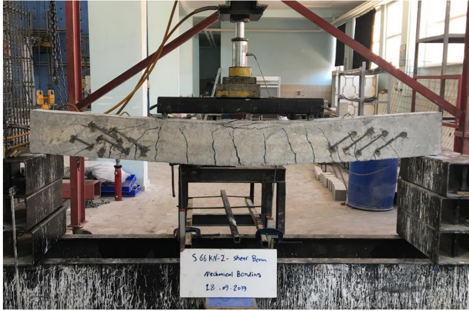
Şekil 4.88. 66kN'luk ön hasar verilen kesme kirişin mekanik bağlayıcılar ile güçlendirme sonrası eğilme davranışı göstermesi
