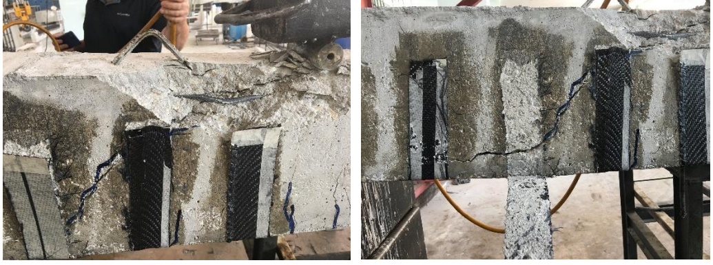
Şekil 4.69. Göçme anındaki ( SBS66kN-C ) nolu kiriş numune
