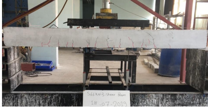
Şekil 4.75. ( PDSB66kN-S) Nolu hasarlı kiriş numunesi
