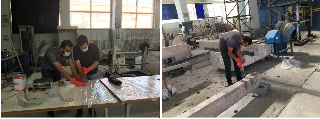
Şekil 3.24. CFRP uygulamasında kullanılan epoksi reçinesinin hazırlanması
