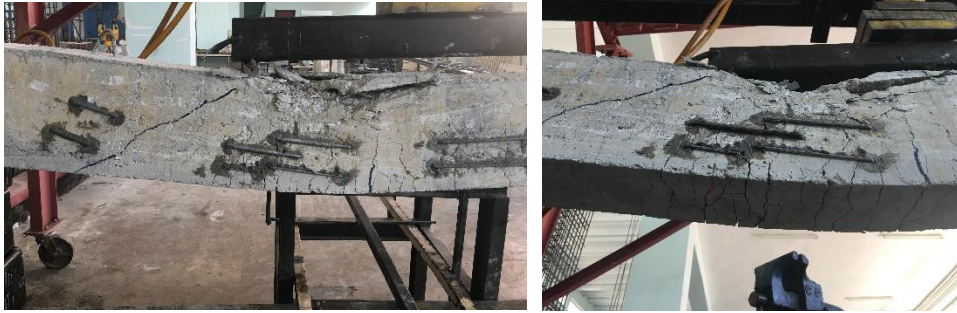
Şekil 4.26. Göçme anındaki ( BBS28mm-M ) nolu kiriş numune
