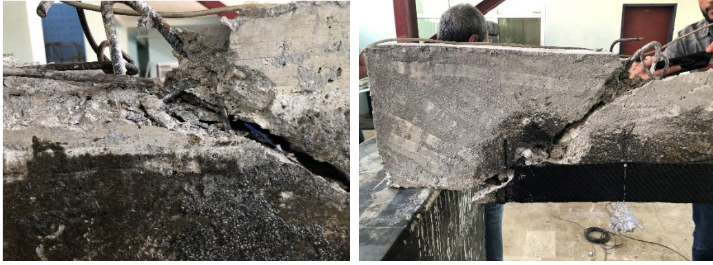
Şekil 4.14. Göçme anındaki ( BBS14mm-M ) nolu kiriş numune
