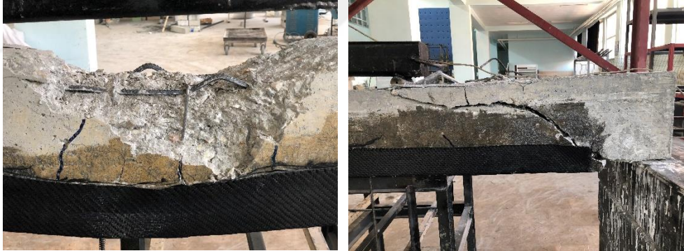
Şekil 4.30. Göçme anındaki ( BBS40mm-C ) nolu kiriş numune
