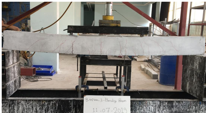
Şekil 4.36. ( PDB40mm-S ) Nolu hasarlı kiriş numunesi
