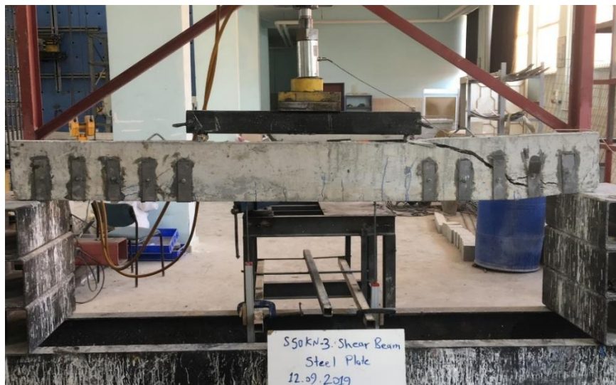
Şekil 4.64. ( SBS50kN-S ) Nolu kiriş numunenin son hali
