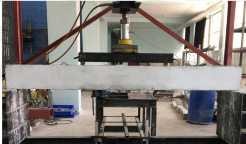
Şekil 3.2. Test yükleme düzeneği (ölçüler cm'dir)
