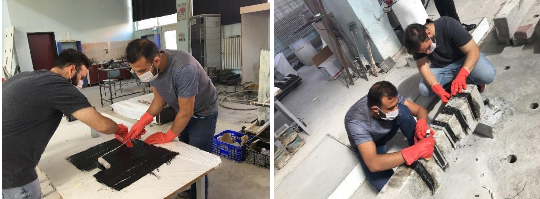
Şekil 3.24. CFRP uygulamasında kullanılan epoksi reçinesinin hazırlanması
