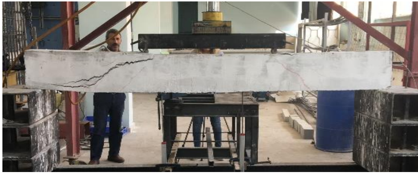
Şekil 4.40. Kesme referans kiriş numunenin son hali
