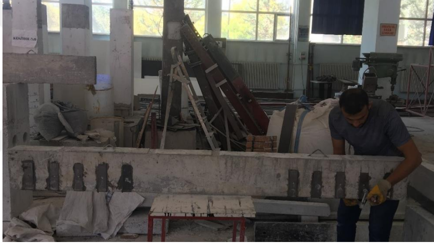
Şekil 3.27. Kesme kirişlerde kullanılan çelik plakalar uygulaması (Şen, 2019)
