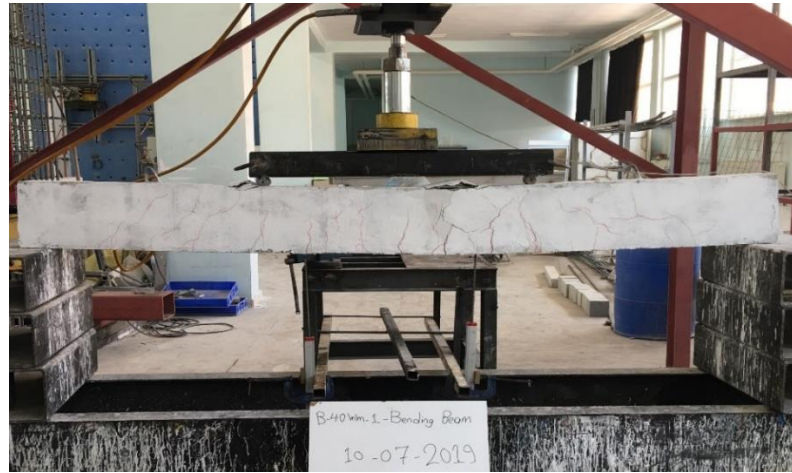
Şekil 4.28. ( PDB40mm-C ) Nolu hasarlı kiriş numunesi
