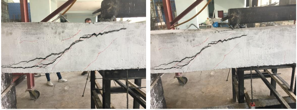
Şekil 4.41. Kesme referans kiriş numunenin göçme anı
