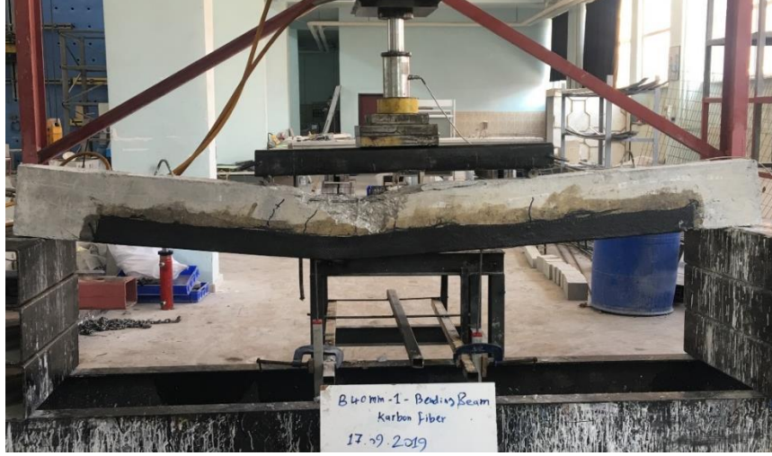
Şekil 4.29. ( BBS40mm-C ) Nolu kiriş numunenin son hali
