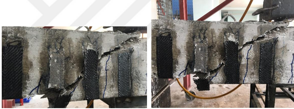
Şekil 4.53. Göçme anındaki ( SBS40kN-C ) nolu kiriş numune
