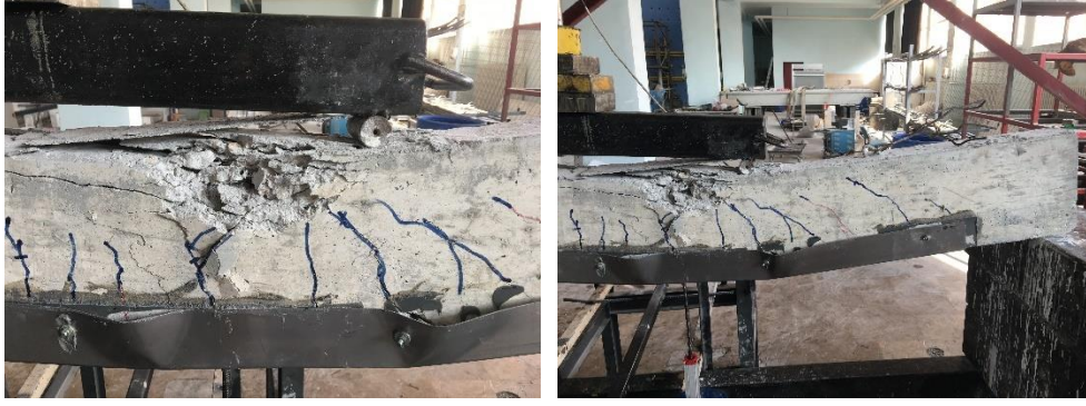
Şekil 4.6. Göçme anındaki ( BBS14mm-S ) nolu kiriş numune
