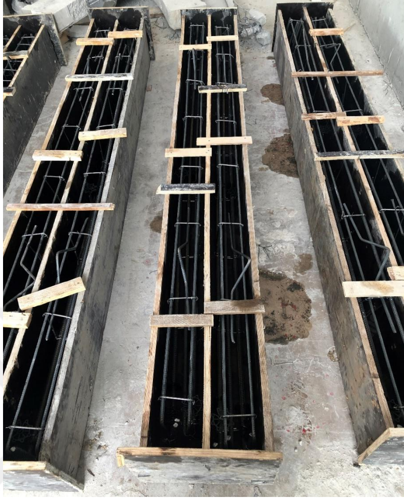
Şekil 3.4. Betonarme kirişler deney elemanlarının detayları (ölçüler cm'dir)
