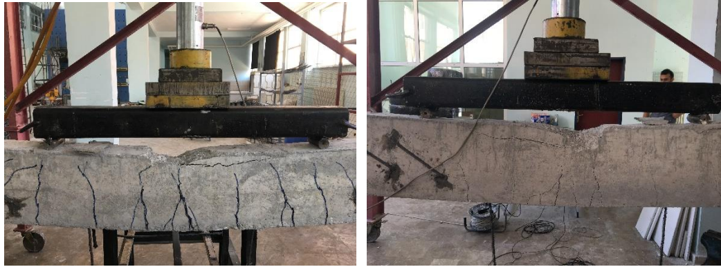
Şekil 4.73. Göçme anındaki ( SBS66kN-M ) nolu kiriş numune
