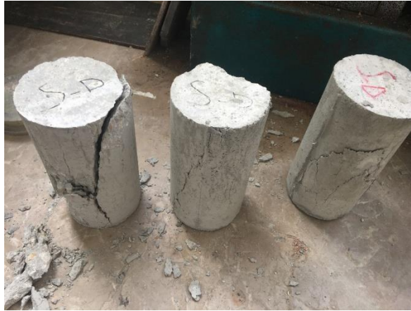
Şekil 3.7. Beton silindir örneklerinin test edilmesi
