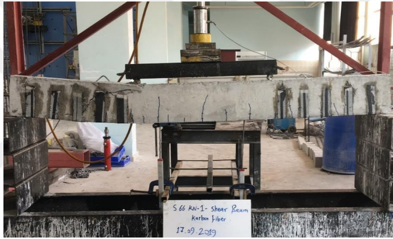
Şekil 4.68. ( SBS66kN-C ) Nolu kiriş numunenin son hali
