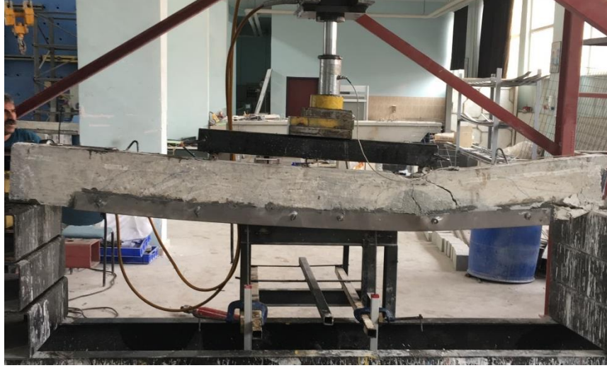
Şekil 4.37. ( BBS40mm-S ) Nolu kiriş numunenin son hali
