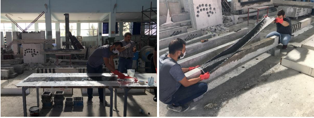
Şekil 3.26. Eğilme kirişlerde kullanılan karbon fiber uygulaması
