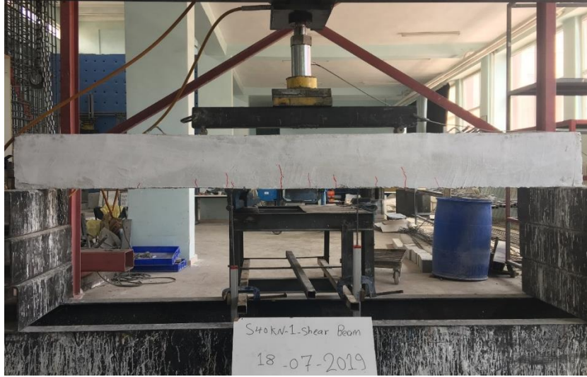
Şekil 4.43. ( PDSB40kN-M ) Nolu hasarlı kiriş numunesi
