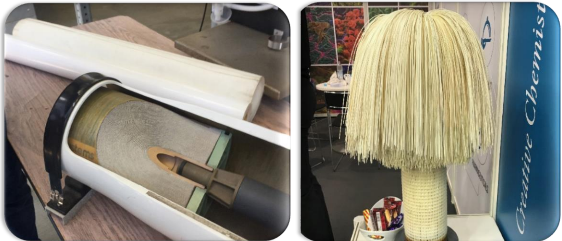
Şekil 2. 10.Membran kesit görüntüleri (İFAT, Almanya, 2018)
