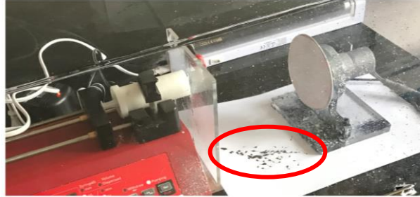
Şekil 4.24. Homojen yapıdaki PVA nanofiberin üretim parametreleri ile üretilmiş Ag nanopartiküllü PVA nanofiberin görünüşü
