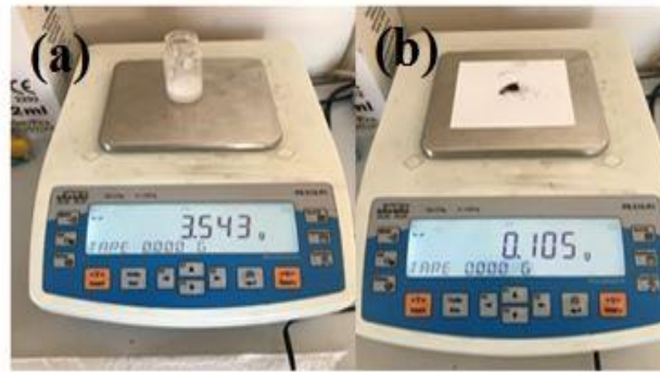
Şekil 4.23. PVA + saf su çözeltisi ve %3 oranında Ag nanopartikülün tartılması (a) PVA + saf su çözeltisi (b) % 3 Ag nanopartikül
