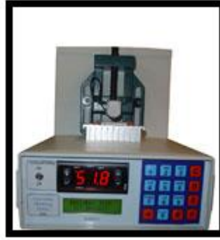
Şekil 4.17. Elektriksel iletkenlik ölçüm cihazı ENTEK FPP-460 dört nokta prob cihazı (Anonim, 2018)
