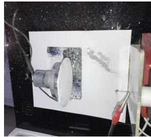
Şekil 4.21. Toplaç ile şırınga arasındaki mesafenin ayarlanmış durumu için cihazın üstten görünüşü
