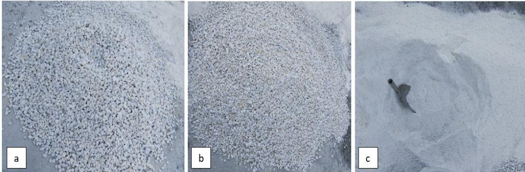
Şekil 3.4. Yapılan deneyde kullanılan agregalar: (a) 11.2-22.4 mm, II.nolu agrega (b) 4-11.2 mm, I.nolu agrega (c) 0-4 mm, kırma kum
