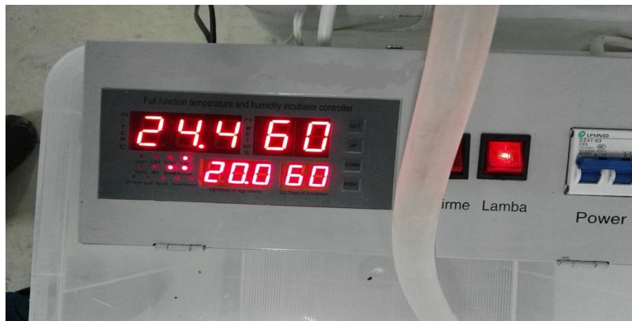
Şekil 3.11. Nem kazanına ve fana bağlayan termostat
