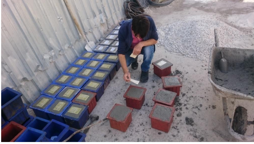
Şekil 3.7. Betonun kalıplara yerleştirilmesi ve etiket yapıştırılması
