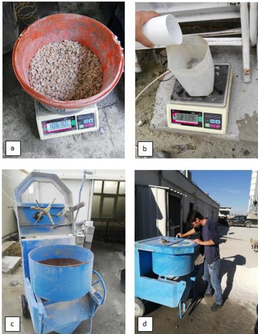
Şekil 3.6. Beton karışımının hazırlanması: (a) agrega tartımı (b) su tartımı (c) kullanılan beton mikseri (d) malzemelerin karıştırılması
