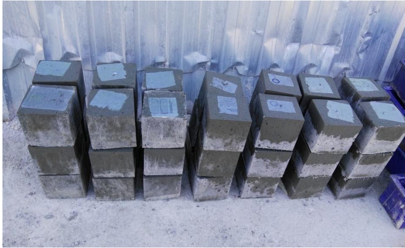
Şekil 3.9. kalıptan çıkarılan betonlar
