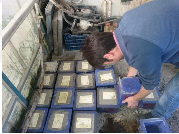
Şekil 3.8. Betonun kalıptan çıkarılması
