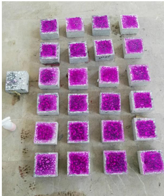
Şekil 4.3. Karbonatlaşmış beton numuneleri
