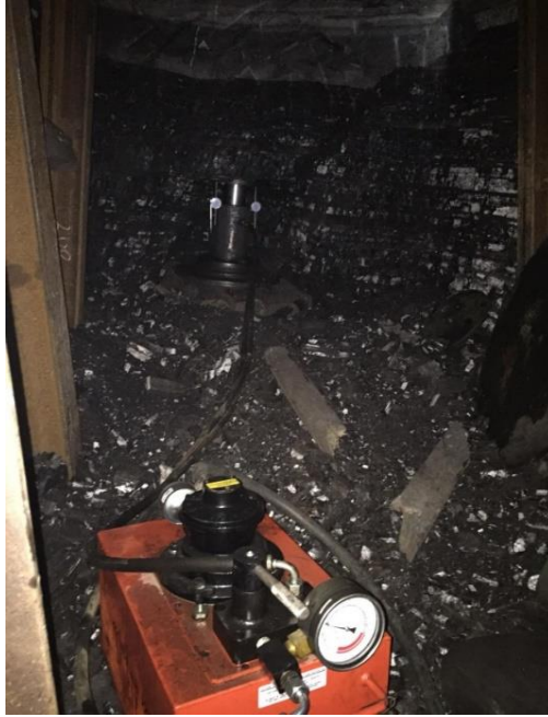
Şekil 3.29. Plaka yükleme deney sisteminin teknik boyutu ve deneyin yerinde uygulanmasına ait tipik görüntüler
