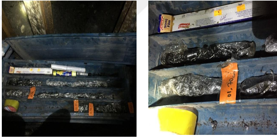
Şekil 3.12. SK-1/Arın yeraltı sondajından elde edilen ve karot özelliği taşımayan örnekler için tipik görüntüler
