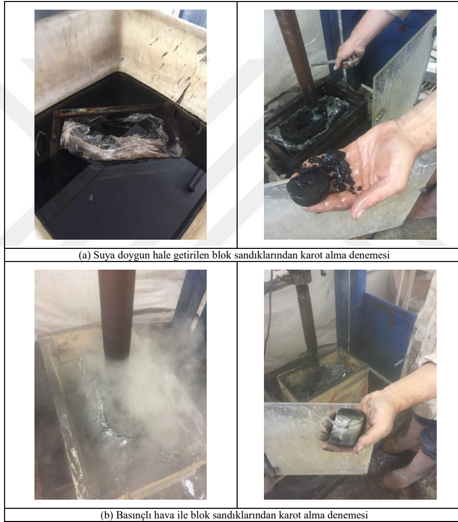
Şekil 3.38. Kömür bloğundan laboratuvar ortamında karot alma çalışmalarında karşılaşılan zorluklar
