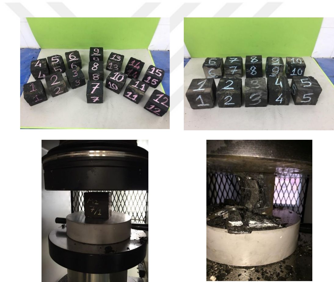
Şekil 3.43. Tek eksenli basma dayanımı deneyleri için hazırlanan örnekler ve deneylerin yapılışı
