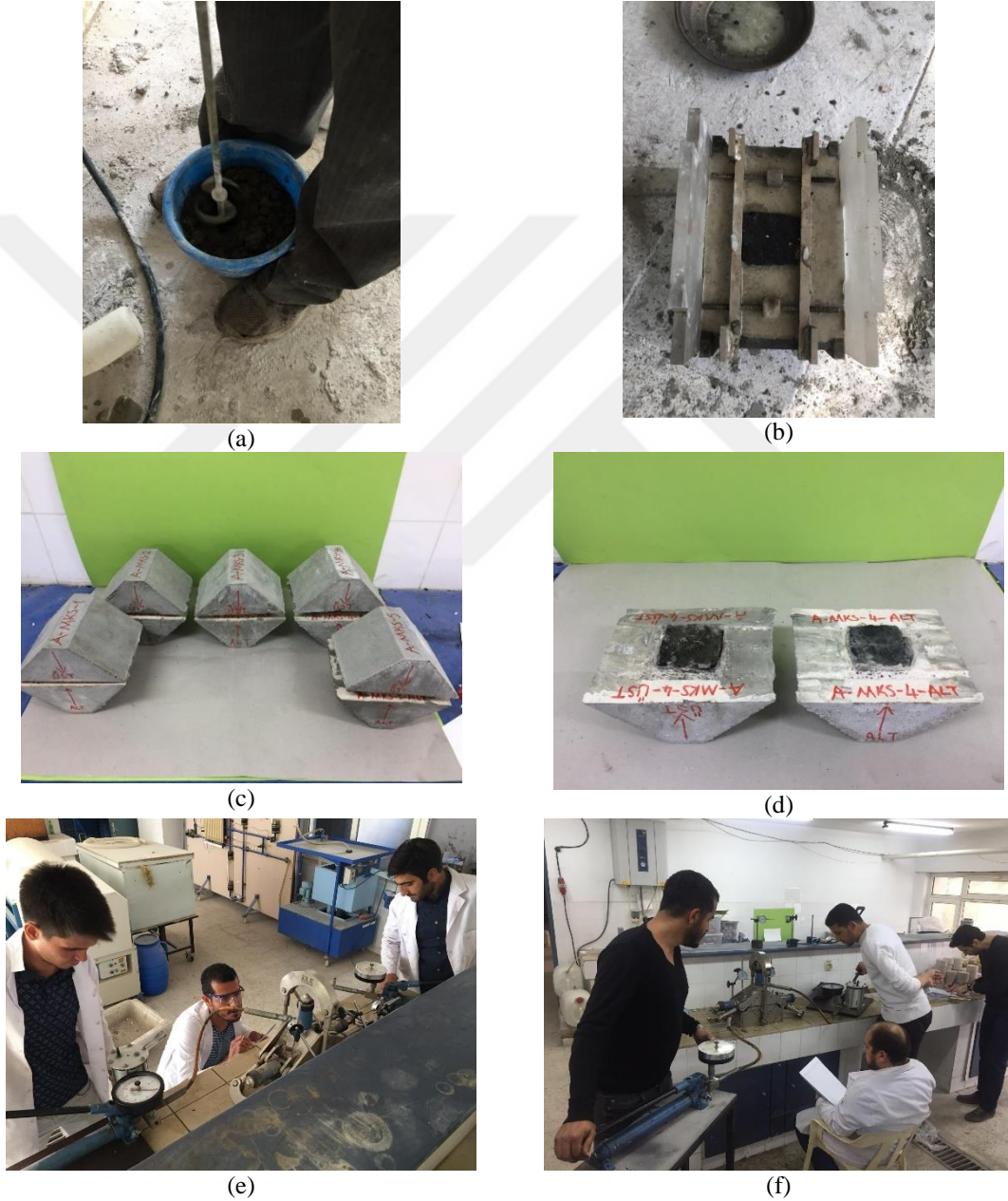
Şekil 3.46. Direkt makaslama dayanımı deneyleri için hazırlanan örnekler ve deney ve deneylerin yapılışı (a; Harç malzemesinin hazırlanışı, b; Harç malzemesinin kuruması için bekletilen hazne, c; Deney için hazırlanan örnekler, d; Örneğin üst ve alt yüzeyinin görünüşü, e,f; Deney görüntüleri)
