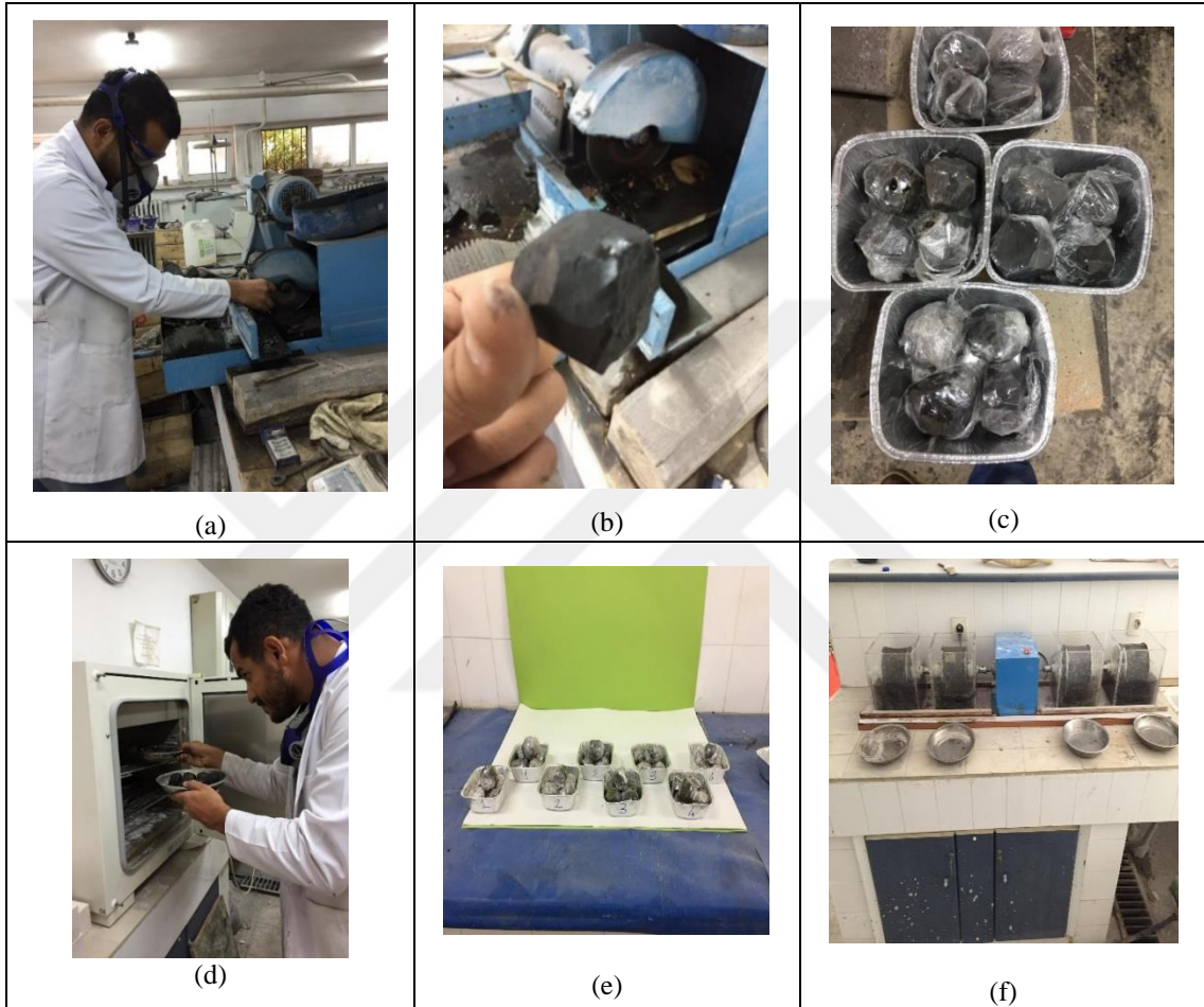
Şekil 3.41. Suda dağılma dayanımı belirleme deneyleri için hazırlanan örnekler ve deneylerin yapılışı
