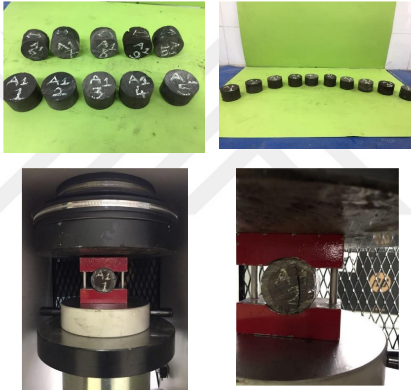
Şekil 3.42. Dolaylı çekme (Brazilian) dayanımı deneyleri için hazırlanan örnekler ve deneylerin yapılışı
