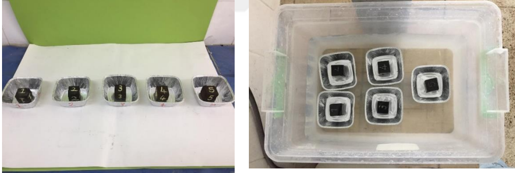
Şekil 3.40. Yoğunluk-Birim hacim ağırlık, gözeneklilik (boşluk oranı) tayini, Ağırlıkça ve hacimce su emme deneyleri için hazırlanan örnekler
