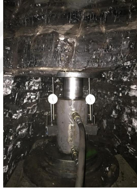
Şekil 3.29. Plaka yükleme deney sisteminin teknik boyutu ve deneyin yerinde uygulanmasına ait tipik görüntüler
