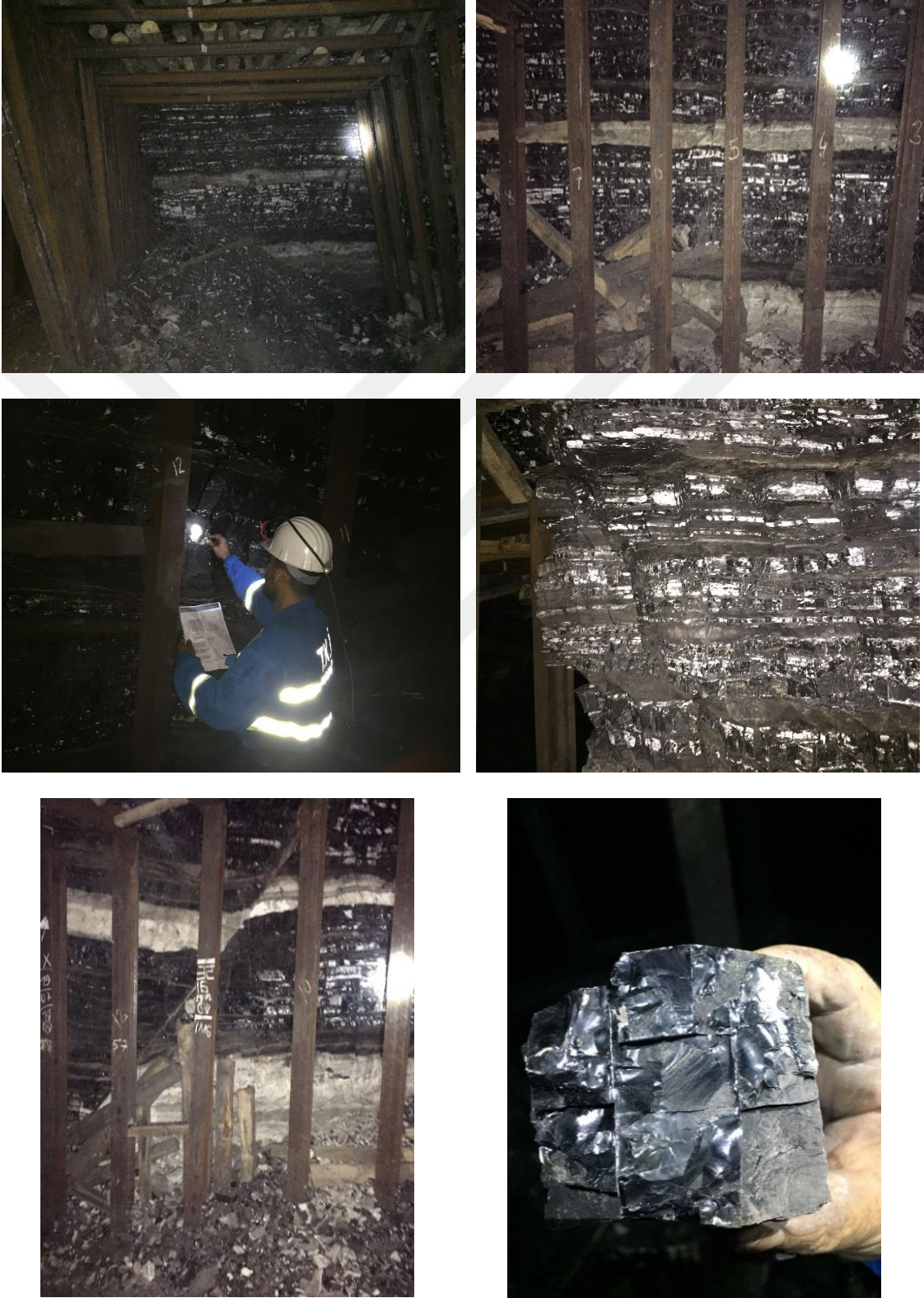
Şekil 3.32. Ömerler yeraltı kömür madeni A1 pano yeni ayak içinde gerçekleştirilen GSI sınıflama çalışmaları
