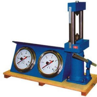
Şekil 3.20. Basit bir nokta yükü dayanım indeksi tayini belirleme deney cihazı (Anonim, 2016)
