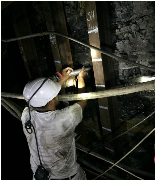
Şekil 3.19. A1 panosu ayak içinde yapılan Schmidt Çekici deney yöntemine ait tipik bir görüntü
