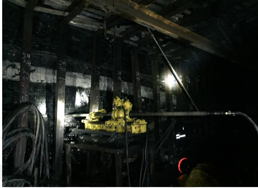
Şekil 3.11. A1 pano ayak içinde yatay yönde başlayan SK-1/yatay kodlu yeraltı sondaj çalışmalarına ait tipik bir görüntü
