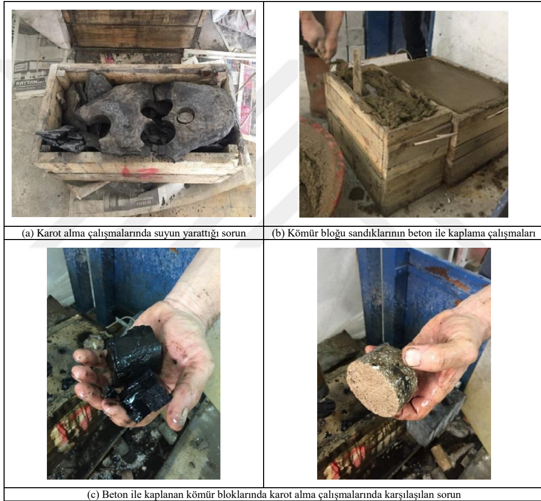
Şekil 3.37. Kömür bloğundan laboratuvar ortamında karot alma çalışmalarında karşılaşılan zorluklar
