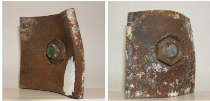
Şekil 2.19. İşlevini kaybetmiş taşıyıcı düz plaka (Li, 2017a)
