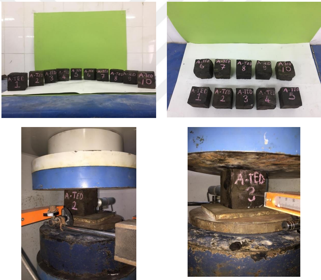
Şekil 3.44. Tek eksenli deformabilite deneyleri için hazırlanan örnekler ve deneylerin yapılışı.
