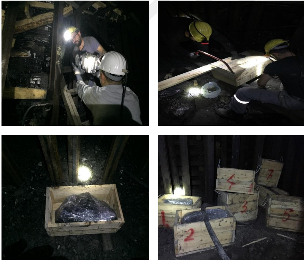
Şekil 3.15. A1 hazırlık galerisi ayak içerisinde gerçekleştirilen kömür arınından blok alma çalışmaları
