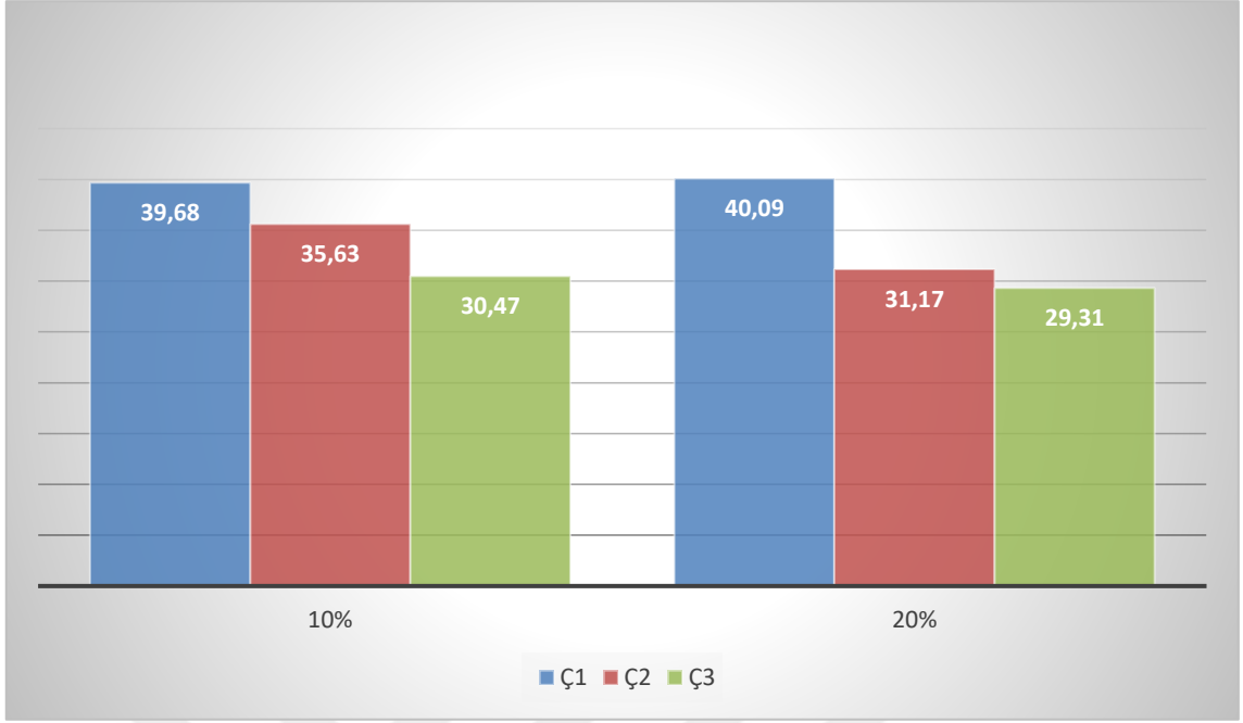
Şekil 5.7: Farklı çatı tiplerinde çatı eğiminin etkisi (kg/m 2 )
