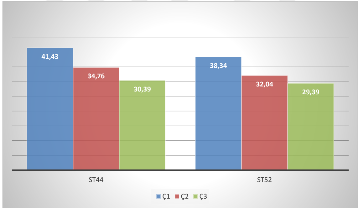
Şekil 5.9: Farklı çatı tiplerinde çelik dayanımının etkisi (kg/m 2 )
