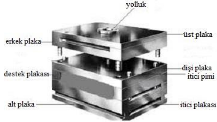
Şekil 1.27. Kalıp ana parçaları (Anonim, 2013)
