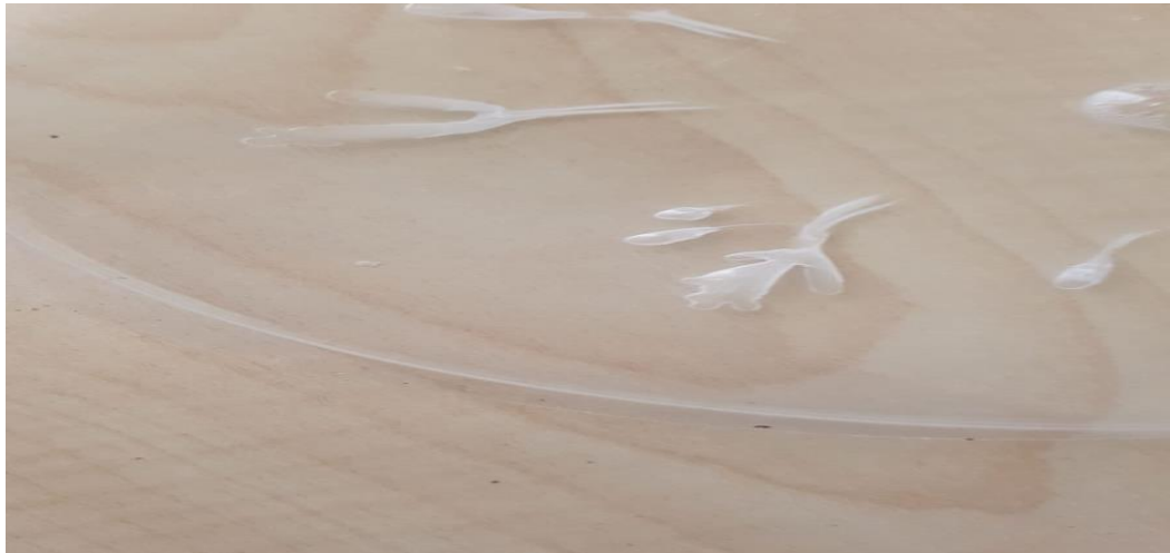
Şekil 3.12. Plastik yüzeyde kabarcık oluşumu
