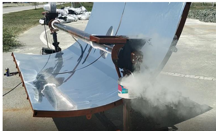
Şekil 3.14. Tüp içerisinde kalmış olan kuru çamurların yanması.
