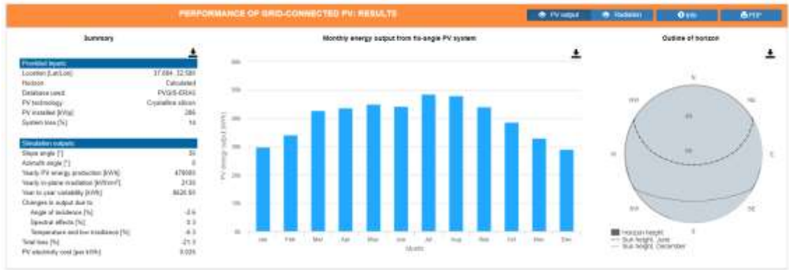
Şekil 4.106. PVGIS Yazılımı Beşinci Versiyonda PVGIS-ERA5 Veri tabanı ile KOSKİ GES Tesisi Simülasyonu Sonuçları
