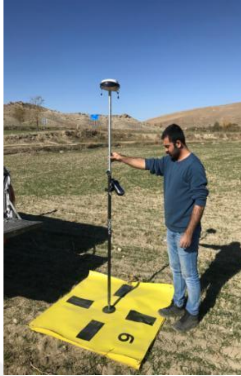
Şekil 3.3. Arazide YKN ölçümü.
