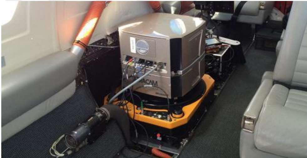
Şekil 3.10. UltraCam Eagle hava kamerası (Url-5).
