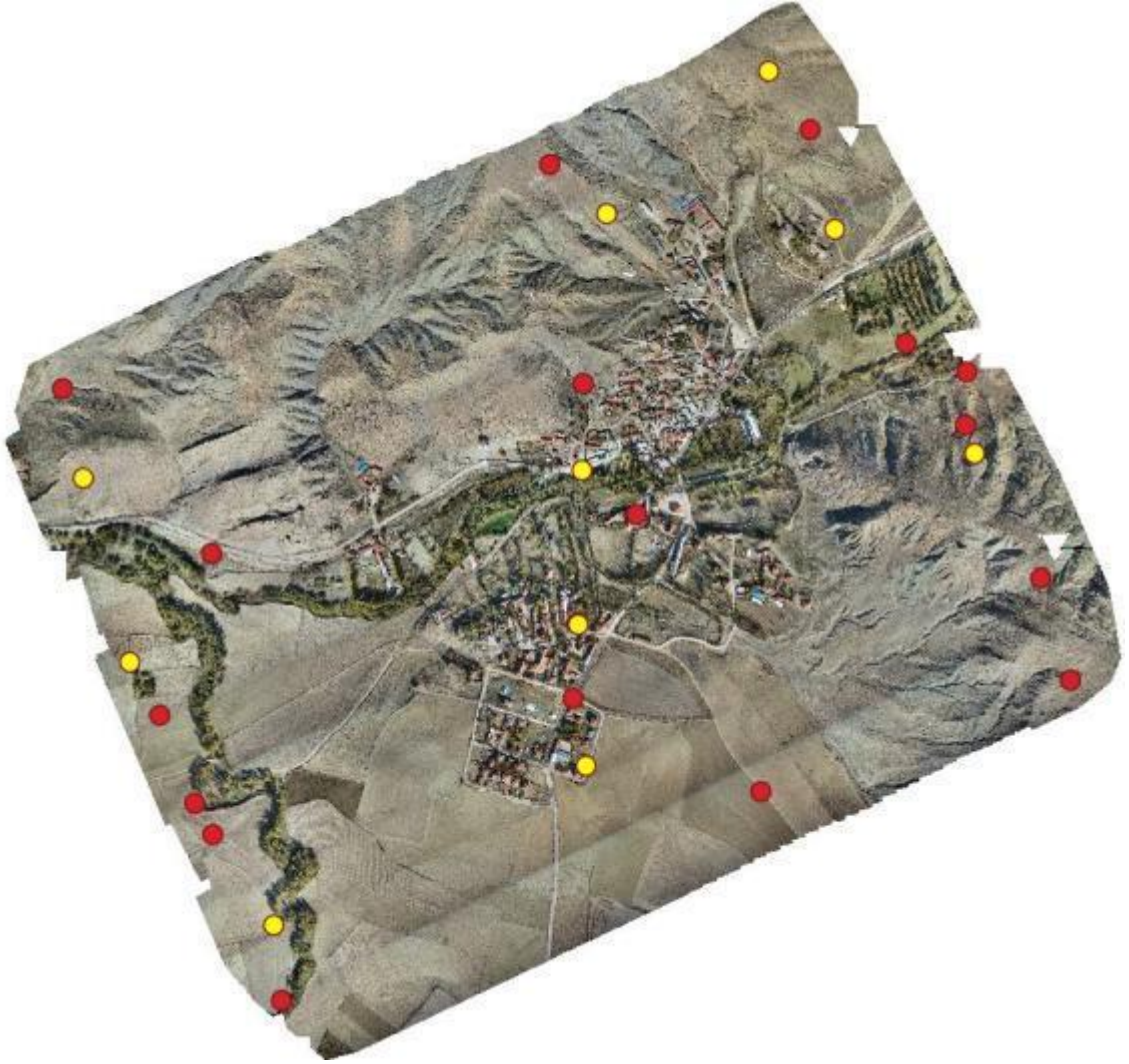
Şekil 4.11. Döner kanat İHA görüntülerinin doğrudan jezik koordinatlandırma doğruluğunu hesaplamak için kullanılan denetim noktaları (sarı ile işaretlenmiş).
