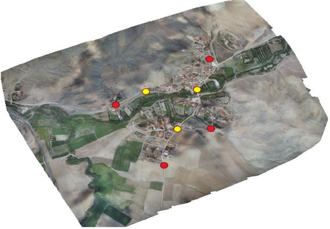
Şekil 4.19. Sabit kanat İHA görüntülerinin dolaylı jedezik koordinatlandırılmasında kullanılan yer kontrol noktaları ve denetim noktaları (kontrol noktaları kırmızı, denetim noktaları sarı ile gösterilmiştir.)
