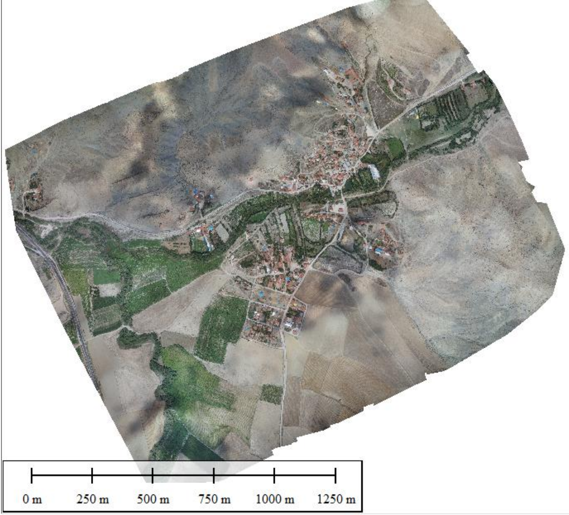
Şekil 4.17. Sabit kanat İHA görüntülerinden Pix4D yazılımı ile üretilen ortofoto.
