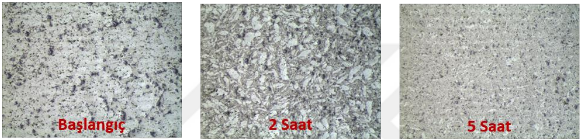
Şekil 2.7. Mekanik alaşım işlemi sırasında bilye-toz-bilye çarpışması ve öğütme süresine bağlı morfolojik değişim
