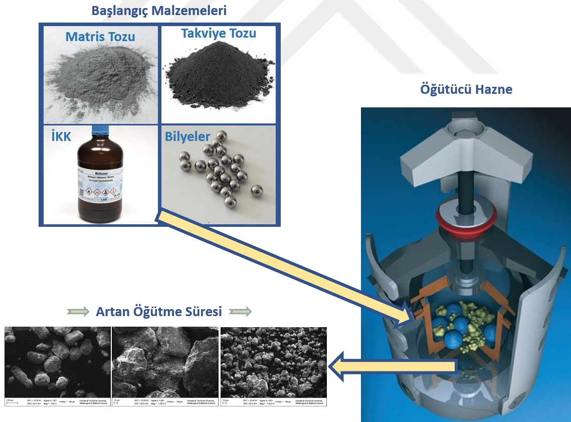
Şekil 2.6. Mekanik alaşımlama işleminde kullanılan başlangıç malzemeleri, öğütücü hazne ve öğütme süresine bağlı olarak mikroyapının değişimi
