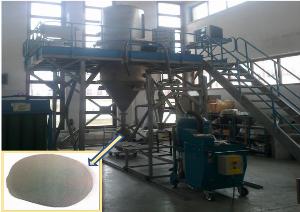
Şekil 3.4. Gaz atomizasyon ünitesi ve üretilen AA7075 matris tozları
