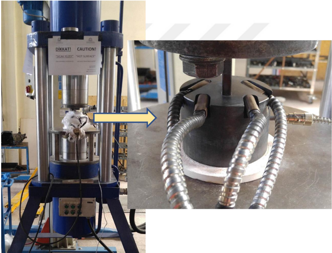
Şekil 3.10. Çalışmada kullanılan sıcak presleme ünitesi, kalıp, ısıtma fişekleri ve termokupl
