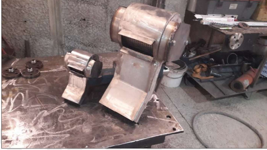
Şekil 3.23. Prototip ve model buhar seperatörlerinin imalat sırasında çekilmiş fotoğrafı
