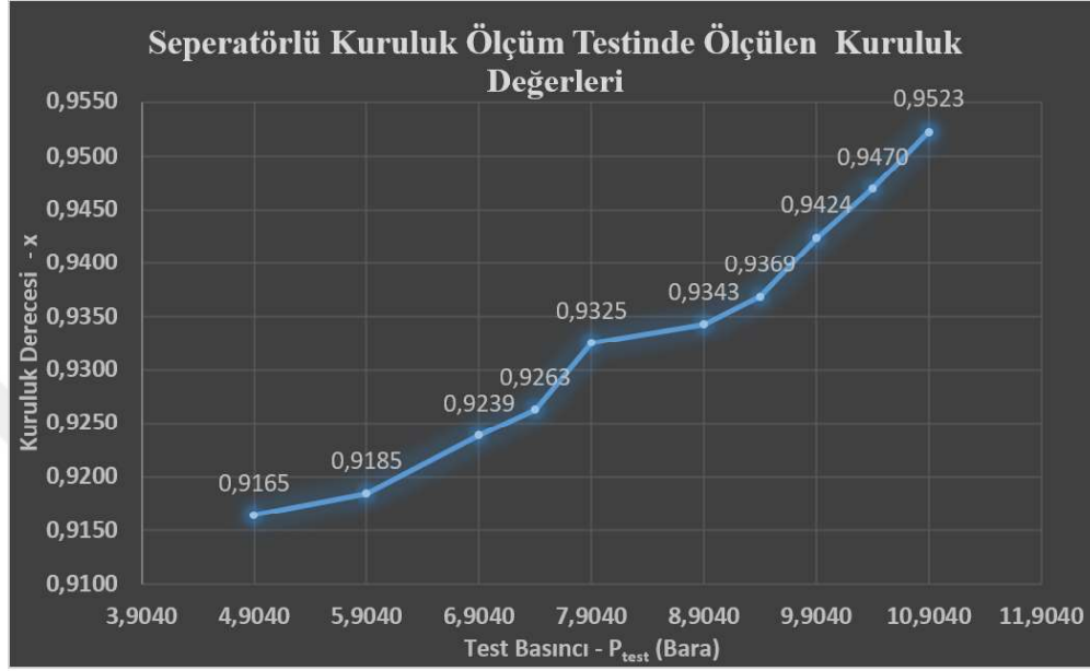
Şekil 4.1. Seperatörlü buhar kuruluğu ölçüm testi sonuçlarının test basıncına göre değişimi
