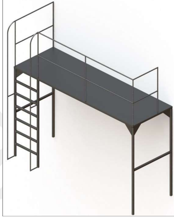
Şekil 3.43. Servis ve yürüyüş platformunun tasarımı
