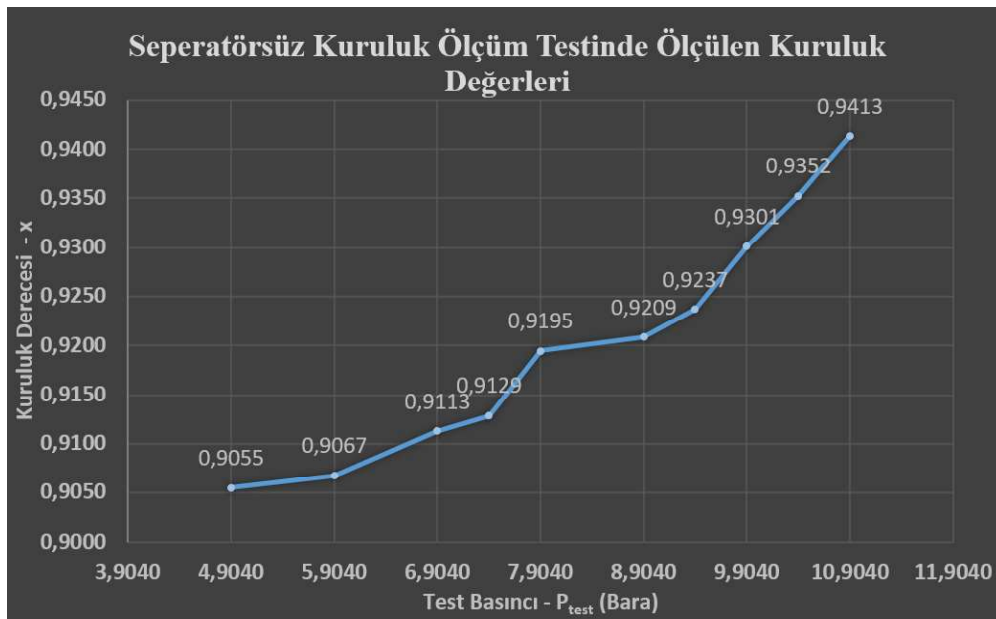
Şekil 4.2. Seperatörsüz buhar kuruluğu ölçüm testi sonuçlarının test basıncına göre değişimi
