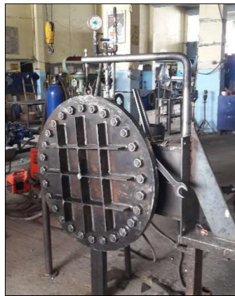
Şekil 3.40. Buhar dramının hidrostatik testi
