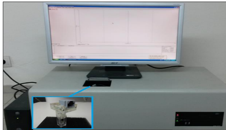
Şekil 3.11. Zeta potansiyeli ölçümünde kullanılan zeta-metre cihazı ve çözelti hücresi
