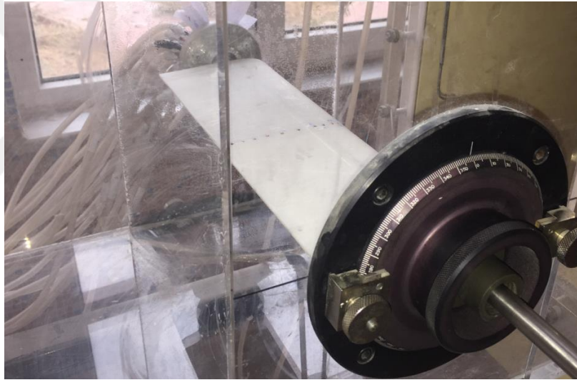
Şekil 6. 2.Kanat profilinin deney seti üzerindeki bağlantısı
