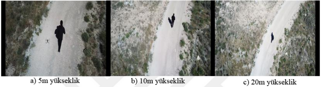
Şekil 4.2. İHA hareketli iken çekilmiş görüntüler
