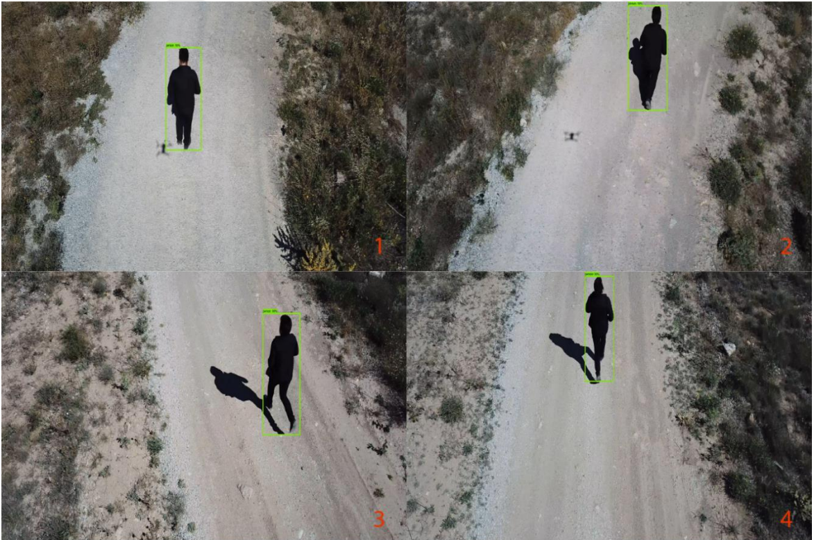
Şekil 4.18. Faster R-CNN ile 5 metre yükseklikte hareketli uçuş sırasında nesne tespiti
