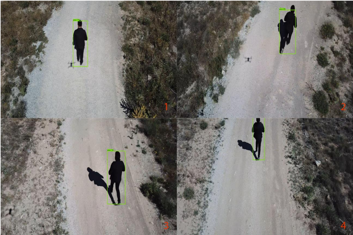
Şekil 4.23. SSD ile 5 metre yükseklikte hareketli uçuş sırasında nesne tespiti
