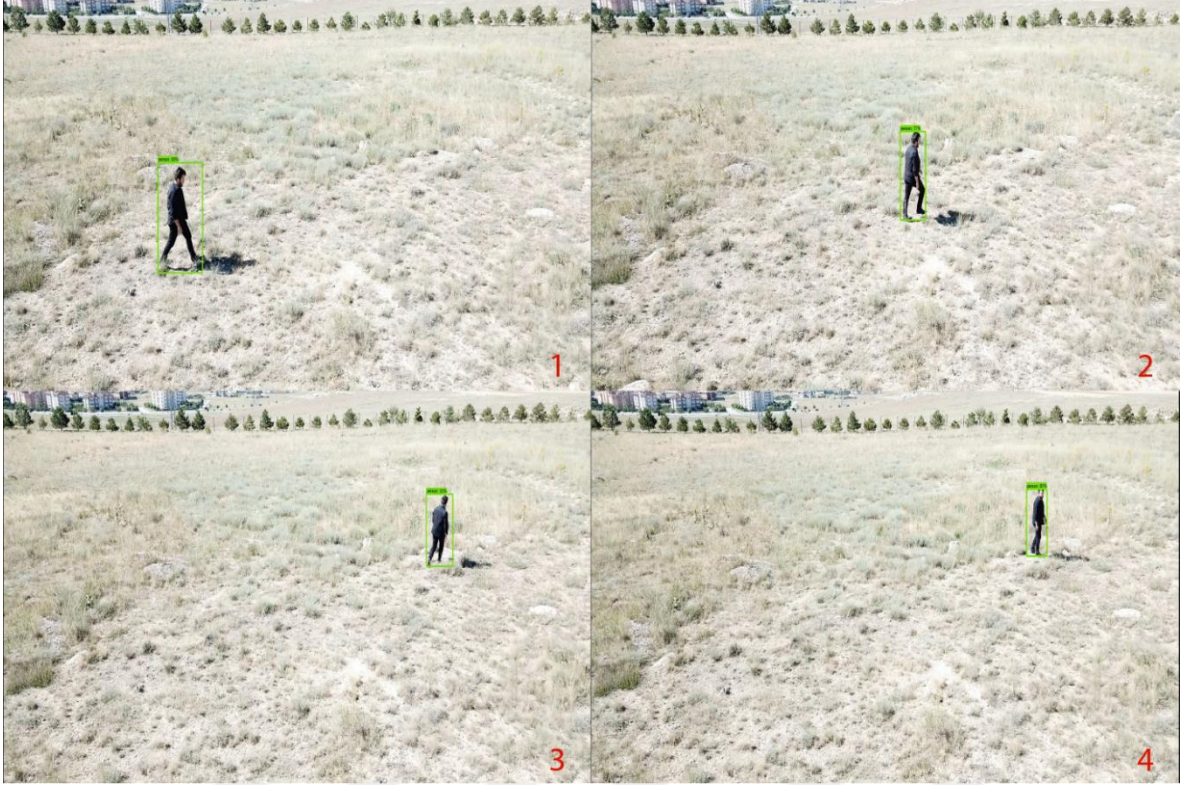
Şekil 4.22. SSD ile 5 metre yükseklikte sabit uçuş sırasında nesne tespiti
