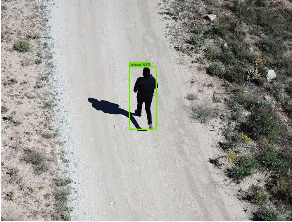
Şekil 4.25. SSD ile 10 metre yükseklikten hareketli uçuş sırasında nesne takibi (yakınlaştırılmış)
