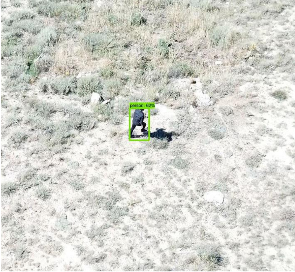
Şekil 4.24. SSD ile 10 metre yükseklikten sabit uçuş sırasında nesne takibi (yakınlaştırılmış)
