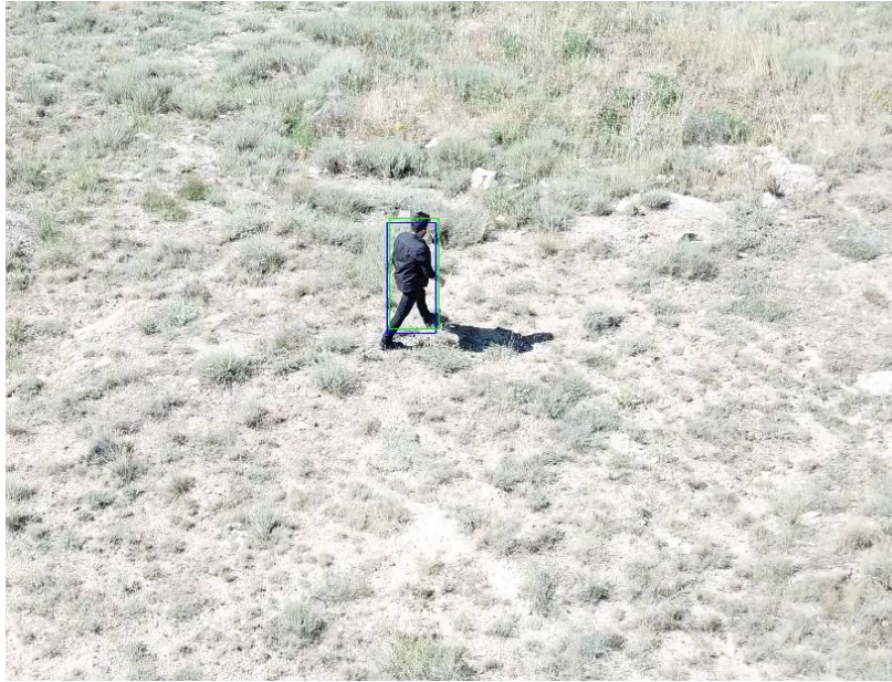
Şekil 4.12. KF ile 20 metre yükseklikten sabit uçuş sırasında nesne takibi (yakınlaştırılmış)
