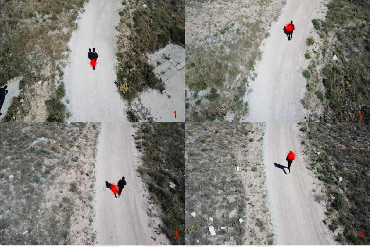
Şekil 4.5. Parçacık Filtresi ile nesnenin takibi (10 metre yüksekten hareketli uçuş sırasında)
