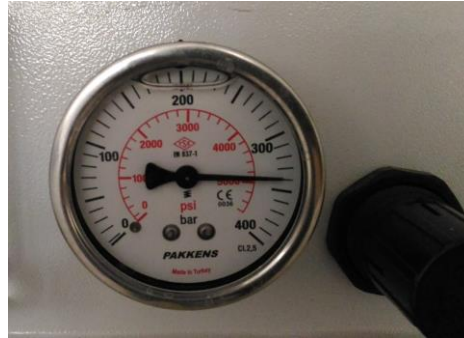
Şekil 5.1. 340 Bar test basıncında manometre görüntüsü
