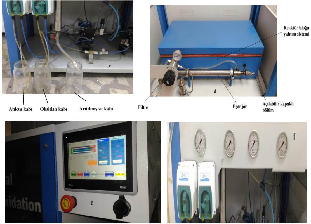
Şekil 4.32. Cihaza ait ön görünüş (a), sol perspektif (b), pompalama sistemleri (c), ısıtma ve ısı eşanjörü bölümü (d), PLC kontrol ünitesi (e) ve basınç kontrol paneline (e) ait resimler
