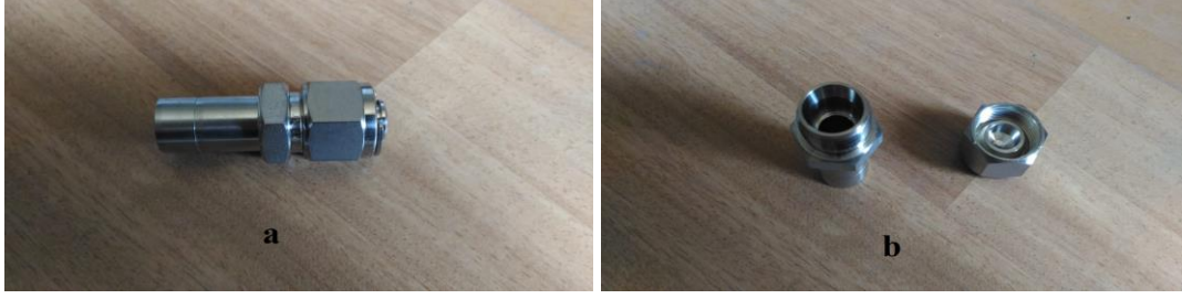
Şekil 4.25. Açılabilir kapak sistemi kapalı (a) ve açık (b) hali
