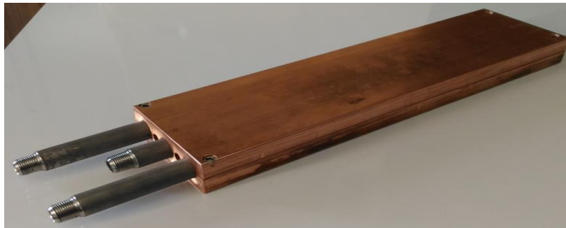
Şekil 4.31. Reaktör hattı ve ısıtma bloğu montajı
