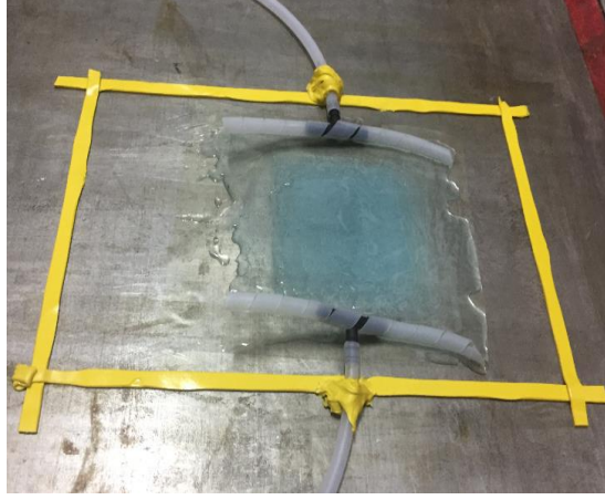
Şekil 4.7. LCD Panel Kontrollü Vakum İnfüzyon Tezgahı
