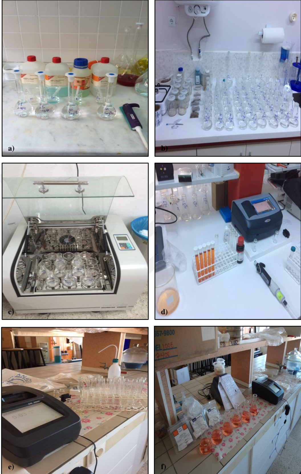
Şekil 3.6. Deneysel çalışmalardan görüntüler a) Stok çözeltilerin hazırlanması, b) Metal çözeltileri, c) Çalkalamalı inkübatörle deney, d) Zn (II) için spektrofotometre analizleri, e) Cu (II) için spektrofotometre analizleri, f) Al (III) için spektrofotometre analizleri
