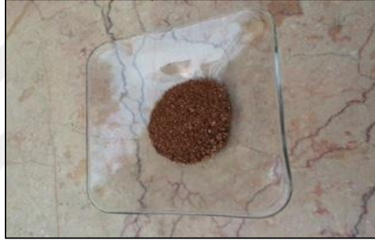
Şekil 3.4. Pelit başlığından elde edilen doğal adsorban
