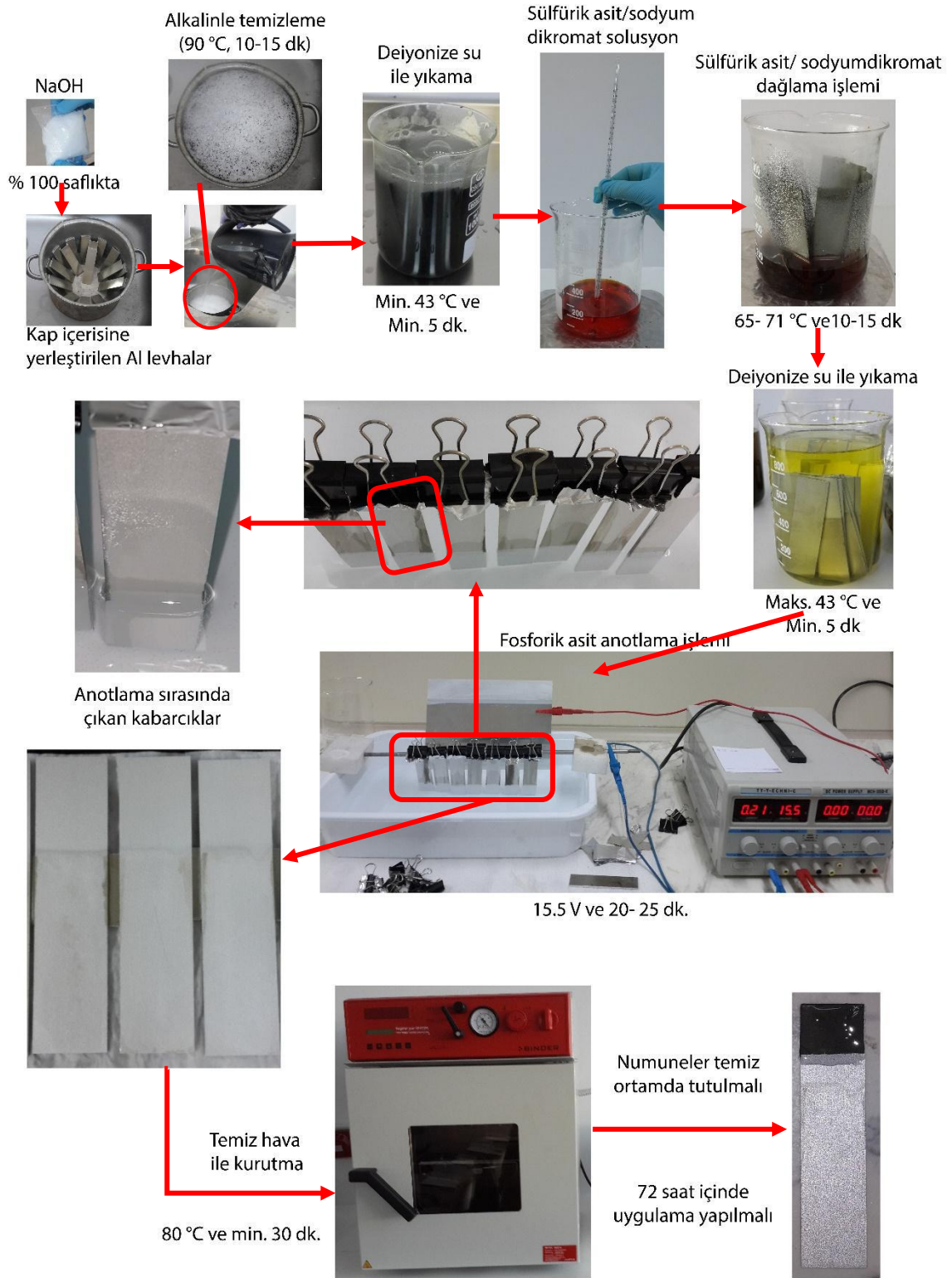
Şekil 3.9. Alüminyum yüzey hazırlıkları
