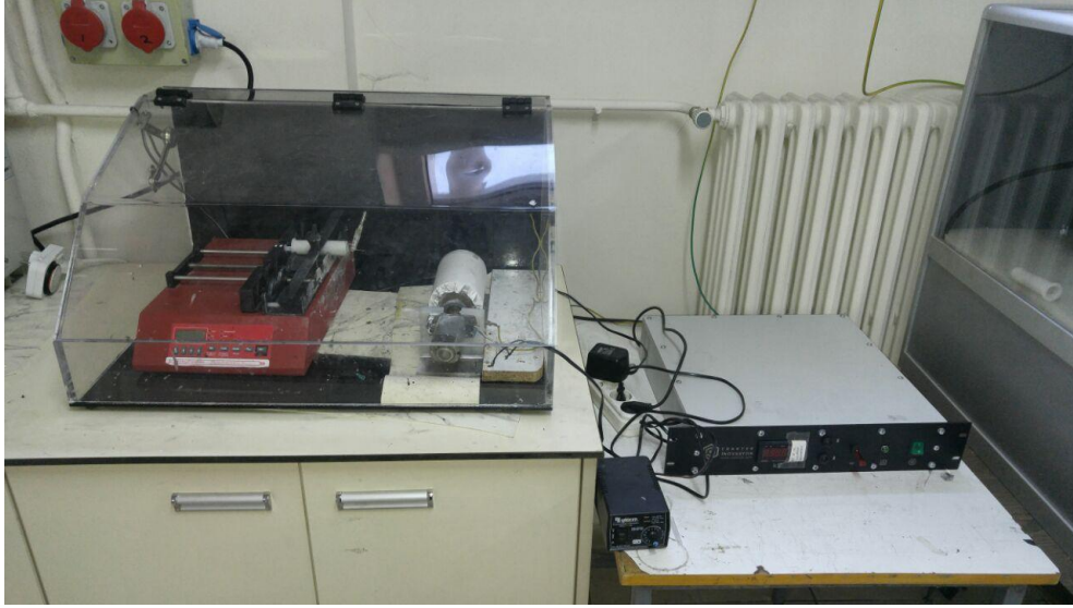
Şekil 3.2. Elektro eğirme nano elyaf üretim sistemi
