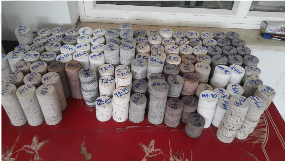
Şekil 3.8. Kaya mekaniği deneyleri için hazırlanmış karot numuneleri
