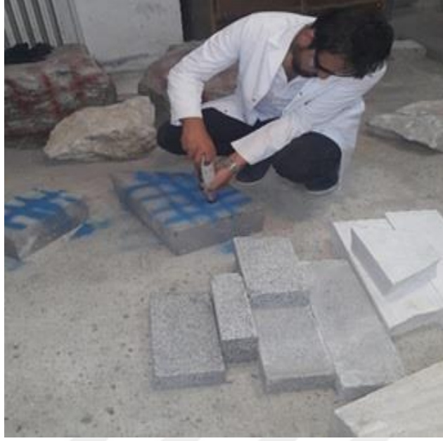
Şekil 3.12. Kayaçların Schmidt sertliği değerlerinin belirlenmesi
