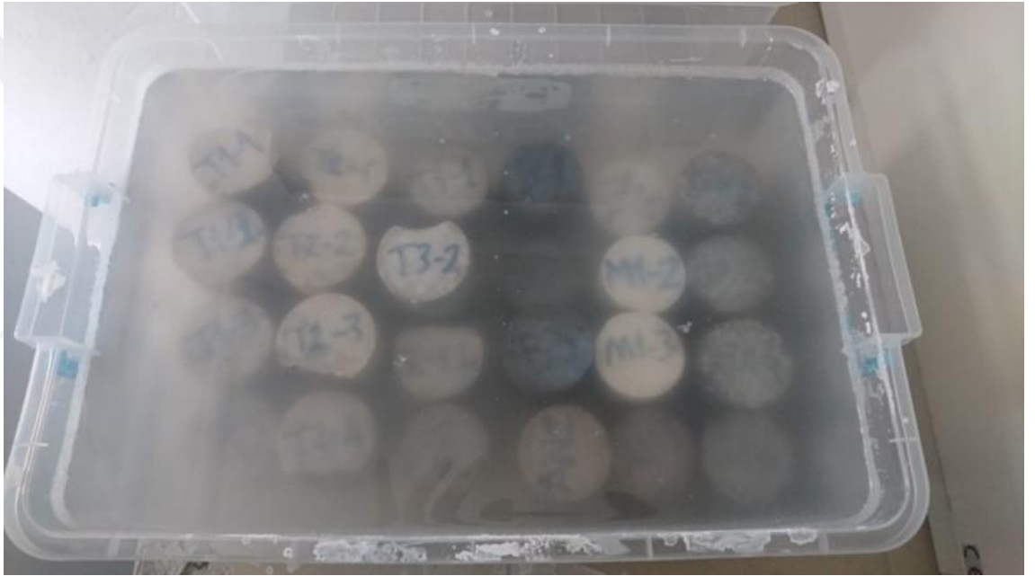
Şekil 3.13. Kuru ağırlık kaybı deney numuneleri
