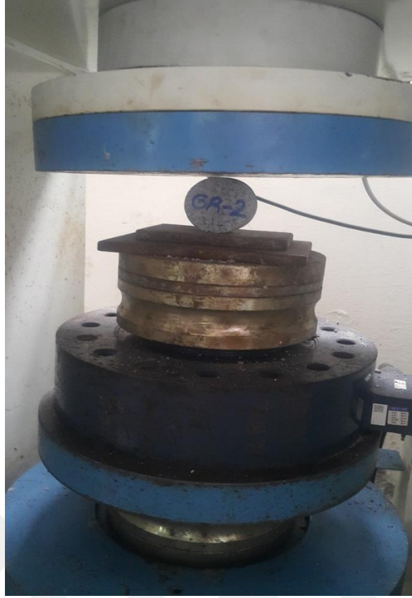
Şekil 3.10. Brazilian deneyi yapılışı
