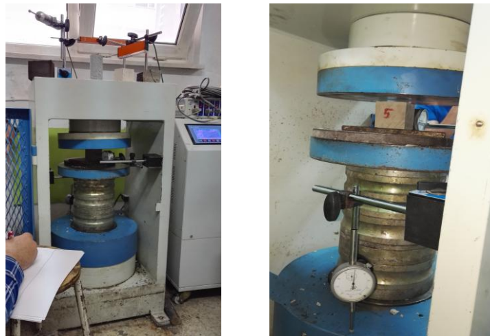
Şekil 3.17. Tek eksenli deformabilite deneylerinden bir görünüm
