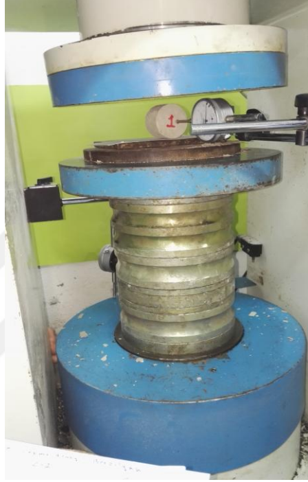
Şekil 3.15. Dolaylı çekme (Brizilan) dayanımı deneyinden bir görünüm
