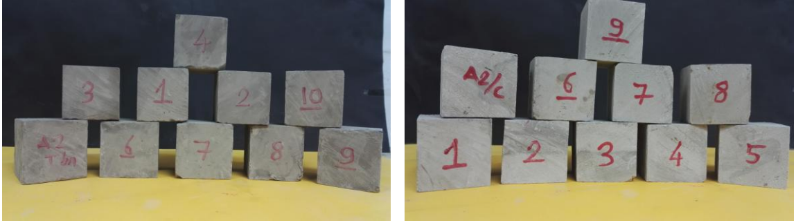
Şekil 3.13. Tek eksenli basma dayanımı deneyinde kullanılan temsili numuneler
