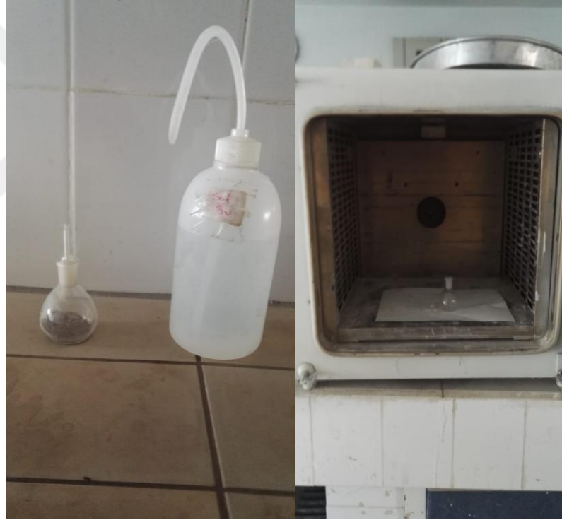
Şekil 3.11. Piknometre ile yoğunluk belirleme
