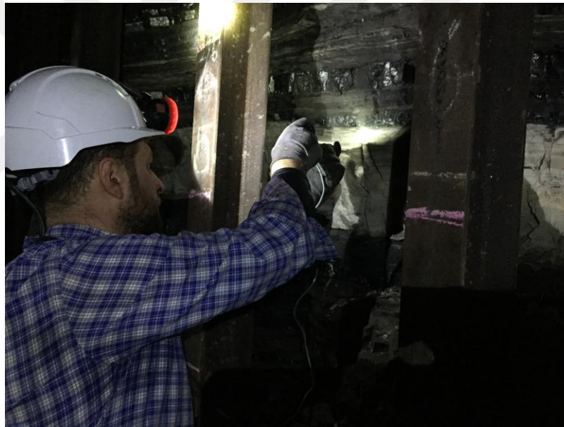
Şekil 3.21. Galeri arınında Schmidt sertlik belirleme deneyine ait tipik bir görünüm
