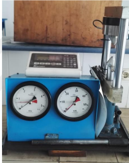
Şekil 3.22. Basit bir nokta yükleme dayanımı indeks belirleme deney cihazı
