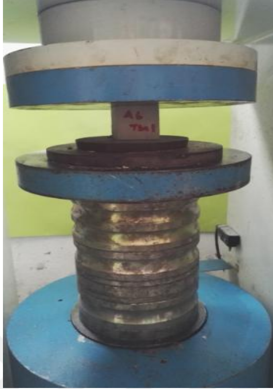
Şekil 3.14. Tek eksenli basma dayanımı deneyinden bir görünüm
