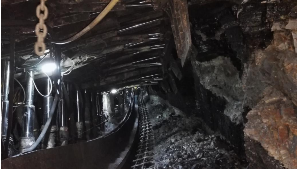
Şekil 3.7. Ömerler yeraltı ocaklarında kullanılan ayak içi tahkimat ünitelerinin görünümü
