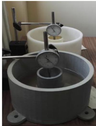
Şekil 3.27. Şişme deney düzeneği
