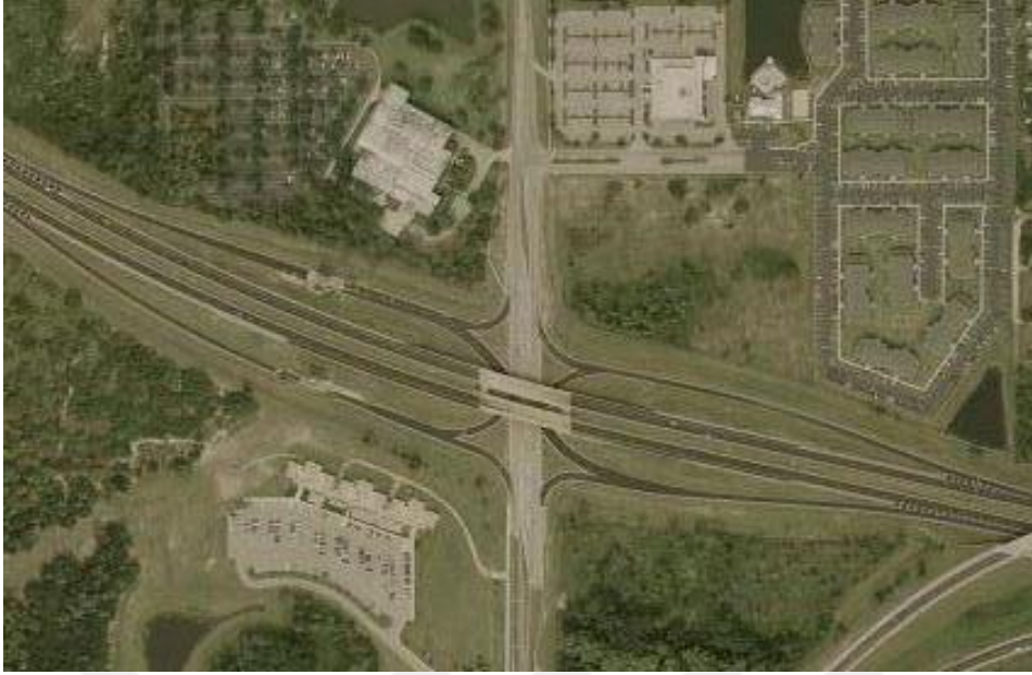
Şekil 3.8. Florida tek nokta kavşak (Koç, 2010)
