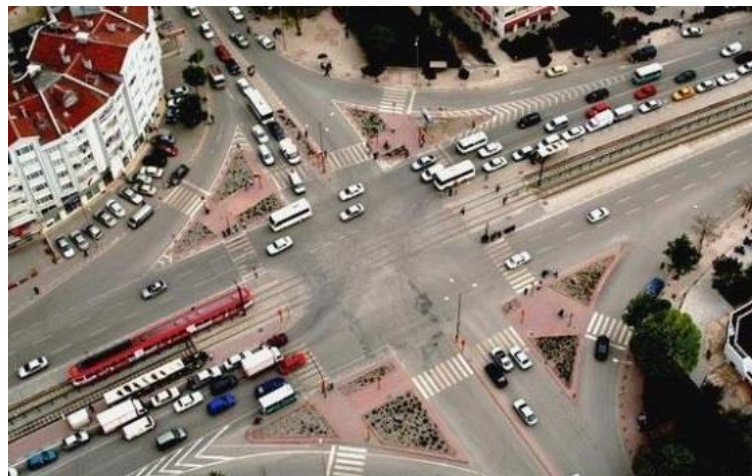
Şekil 3.2. Sinyalize hemzemin kavşak https://photos.wikimapia.org/p/00/02/13/31/83_big.jpg
