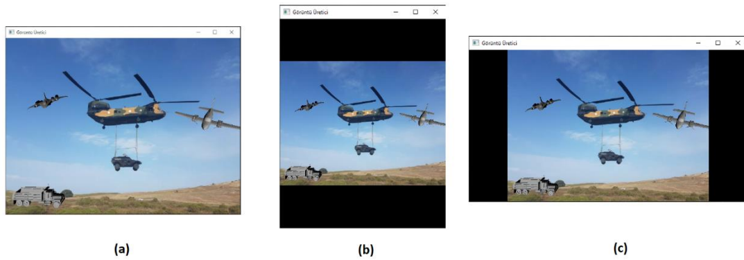
Şekil 5.5. Görünüş oranı uyumluluğu algoritmasının farklı pencere boyutlarında oluşturduğu görseller. (a) birebir boyutlar, (b) yatay daraltma, (c) dikey daraltma
